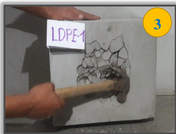
Figura N° 58: Inspección visual del interior del ladrillo LDPE 1.
