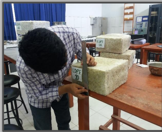
Figura N° 39: Se muestra la medida de la altura del Ladrillo LDPE N° 10
