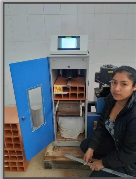
Figura N° 18: Se muestra el ensayo de rotura del ladrillo patrón N°10.
