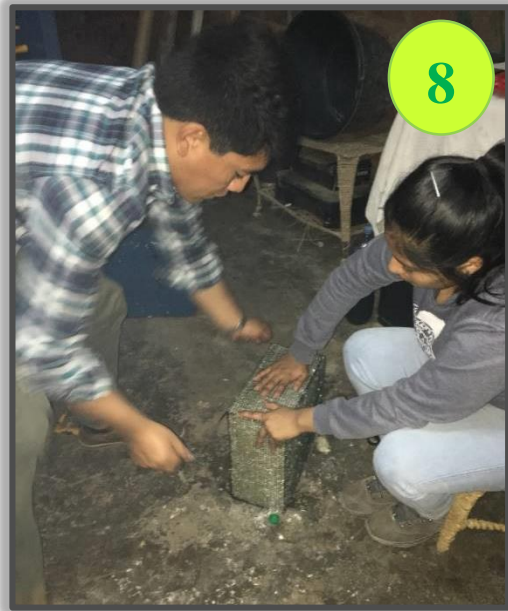
Figura N° 32. Se procede al cerrado de la malla que cubre el ladrillo de 30 x 30 x 15cm
