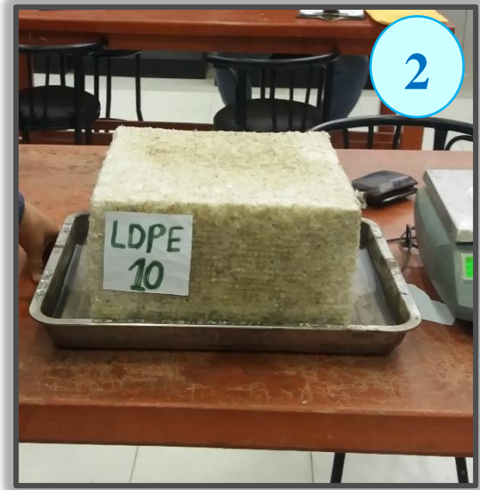
Figura N° 47: Se coloca el Ladrillo LDPE N° 10 en una bandeja llena de agua durante un minuto.
