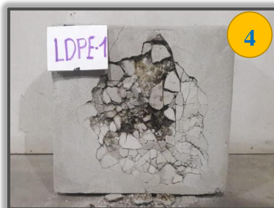
Figura N° 59: Comportamiento de ladrillo LDPE 1 sometido a fuego directo
