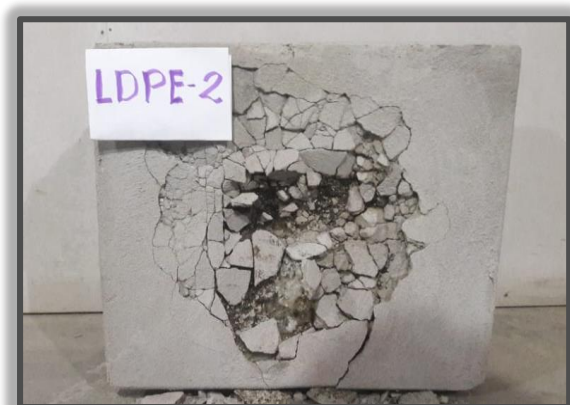
Figura N° 60: Comportamiento de ladrillo LDPE 2 sometido a fuego directo.
