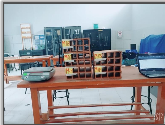
Figura N° 09: Se pesaron las cinco muestras de ladrillos en la balanza digital del laboratorio en la Universidad Cesar Vallejo.
