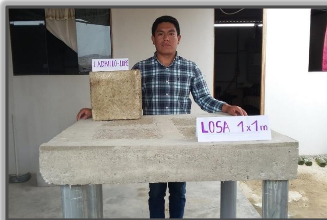
Figura N° 66: Losa aligerada elaborada con
