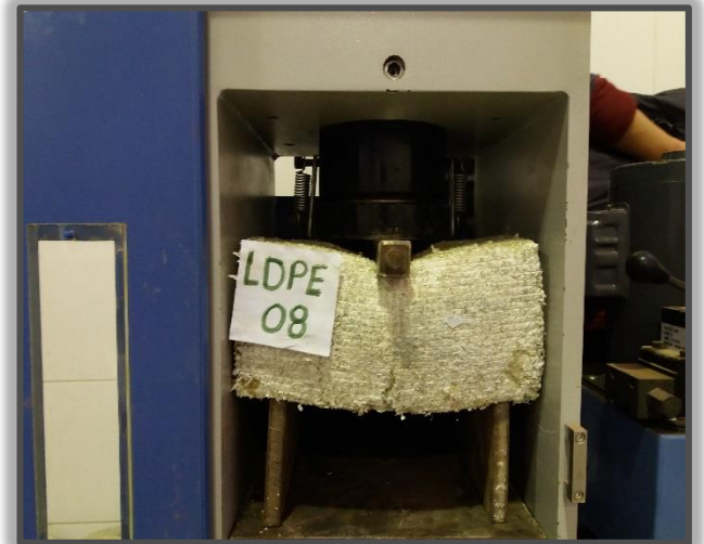
Figura N° 53: Se muestra la rajadura del Ladrillo LDPE N° 08 por la mitad, pero no llega a romperse en su totalidad
