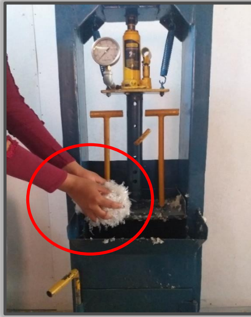
Imagen 3: Colocación de mezcla plástica
