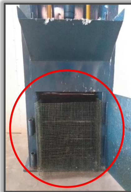
Imagen 2: Colocación de molde de malla en la prensa LDPE
