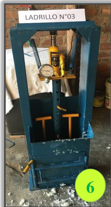
Figura N° 30: Se coloca la mezcla en la prensa ejerciendo una presión con el manómetro
