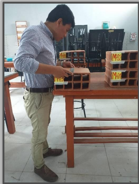
Figura N°01: Se midió el largo del Ladrillo Patrón N° 03
