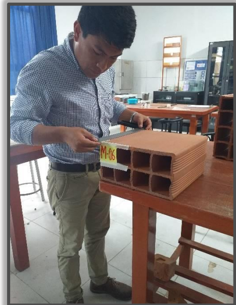
Figura N°02: Se midió el ancho del Ladrillo Patrón N° 06 en 4 puntos diferentes.
