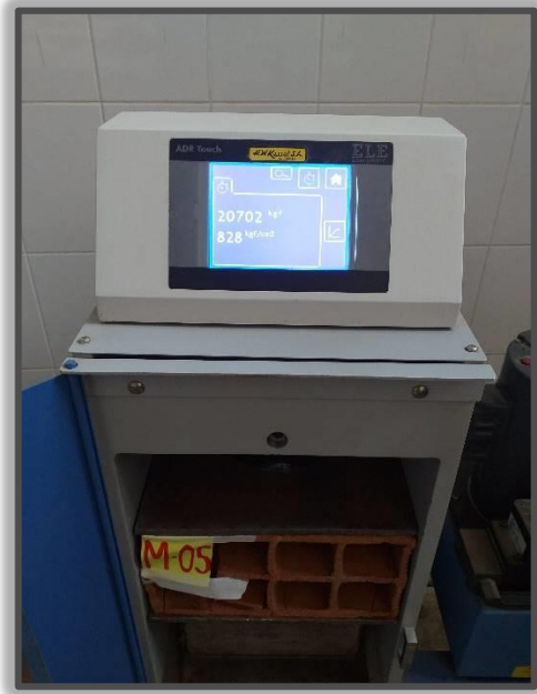
Figura N° 14: Se muestra la rotura del ladrillo Patrón N° 05, al ser sometido a una carga
