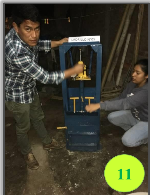
Figura N° 35: Se ejerce presión visualizando el manómetro
