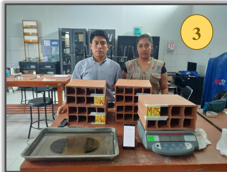
Figura N° 12: Se retira el Ladrillo Patrón N° 05, luego se seca y se procede a pesar para ver cuánto aumento su peso.
