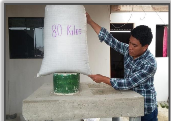
Figura N° 65: Carga puntual en ladrillo LDPE
