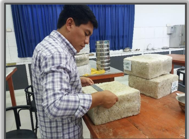
Figura N° 40: Se muestra que se está midiendo el ancho del Ladrillo LDPE N° 10 tomando cuatro medidas diferentes en cada punto
