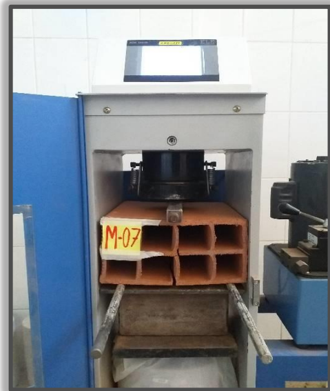
Figura N° 16: Se coloca el ladrillo Patrón N° 07 en la máquina y se coloca las tres varillas respectivamente.
