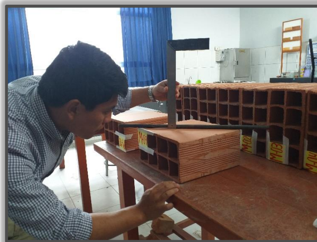
Figura N° 06: Se identificó si el ladrillo tiene vacíos en forma convexa o cóncava y se pasó a medir en el ladrillo Patrón N° 07.
