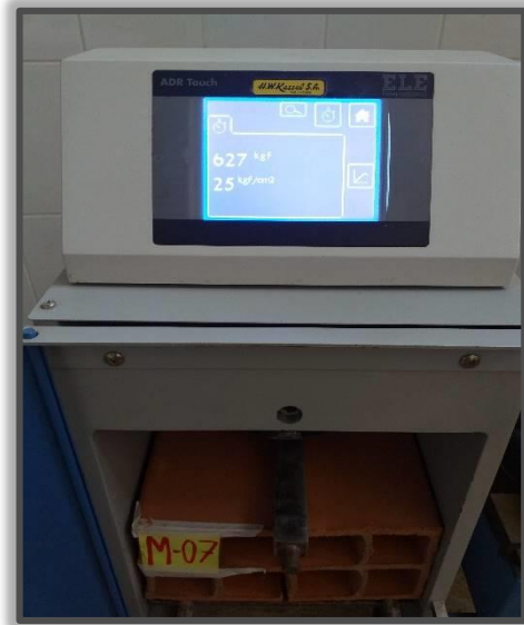
Figura N° 17: Se muestra a que resistencia se rompió el ladrillo patrón N°07.
