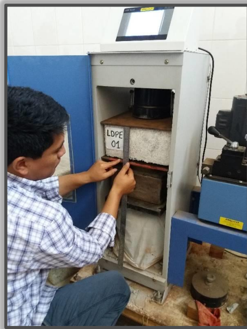
Figura N° 49: Se coloca planchas metálicas en la parte superior e inferior del ladrillo luego se procede a la medida de su altura del Ladrillo LDPE N° 1
