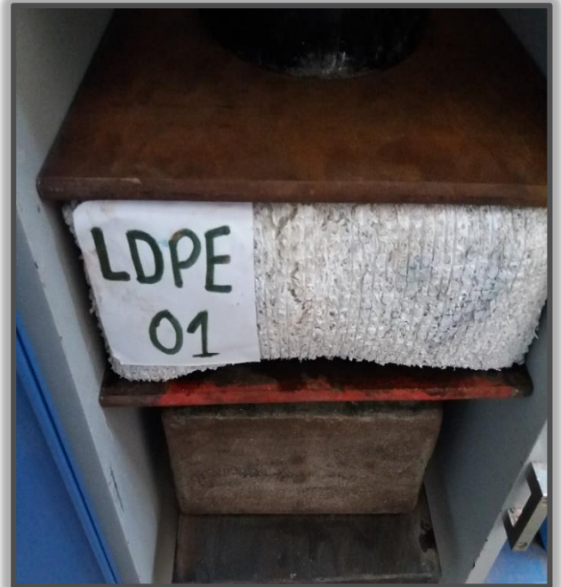
Figura N° 50: Se muestra la rajadura que tuvo el Ladrillo LDPE N° 1 al ser sometido a una carga. Se mide la altura del ladrillo porque no se rompe de su totalidad este producto.
