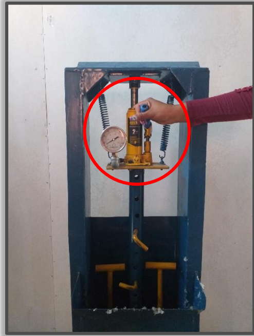
Imagen 5: Prensado de ladrillo LDPE
