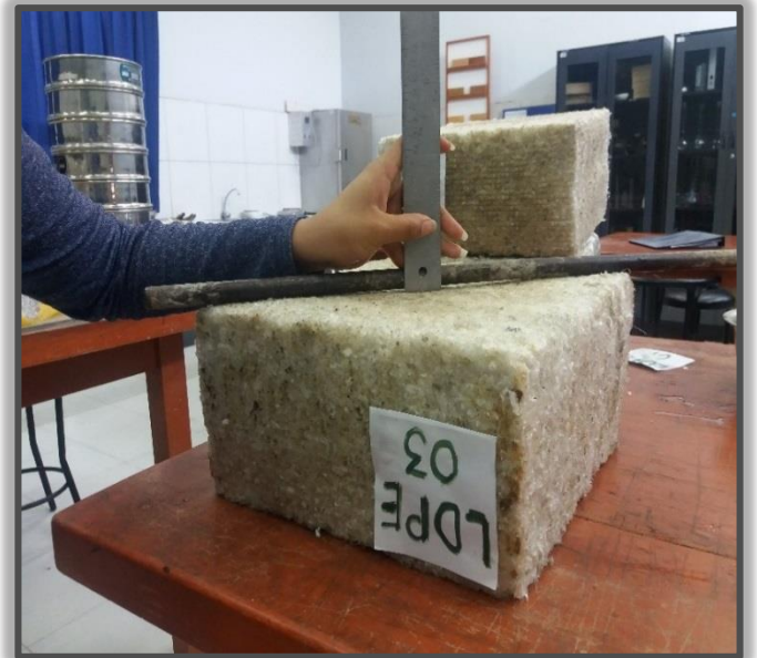
Figura N° 41: Se ubicó los espacios entre la varilla y el ladrillo y se distinguió si es convexa o cóncava y se midió ambas caras con la regla al Ladrillo LDPE N° 03
