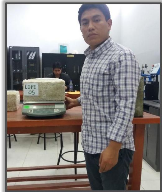
Figura N° 44: Se pesó el Ladrillo LDPE N° 05 en la balanza digital
