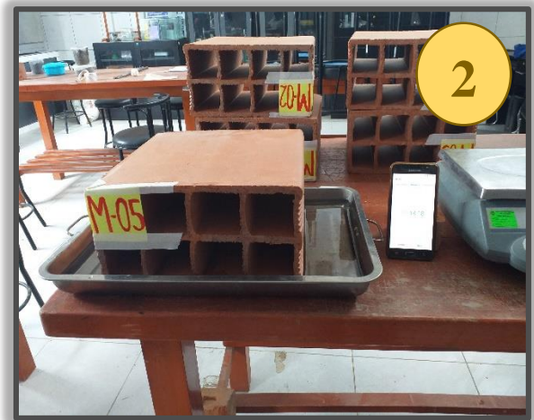
Figura N° 11: Se coloca el ladrillo patrón N°05 en el recipiente con agua durante un minuto.
