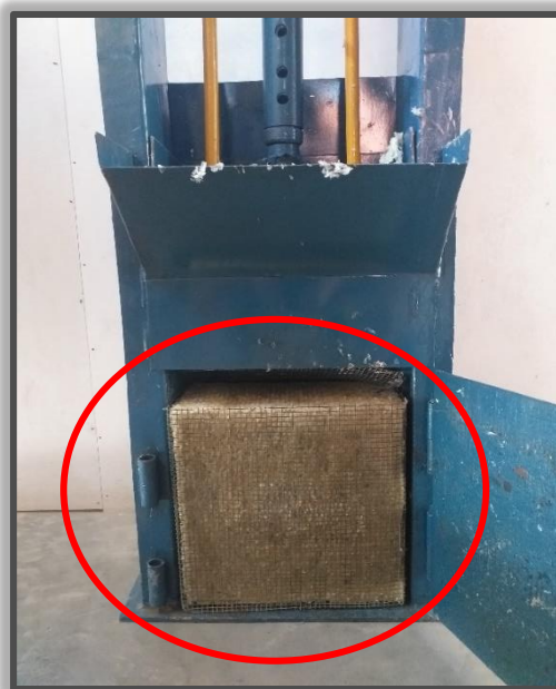
Imagen 6: Ladrillo LDPE en la prensa
