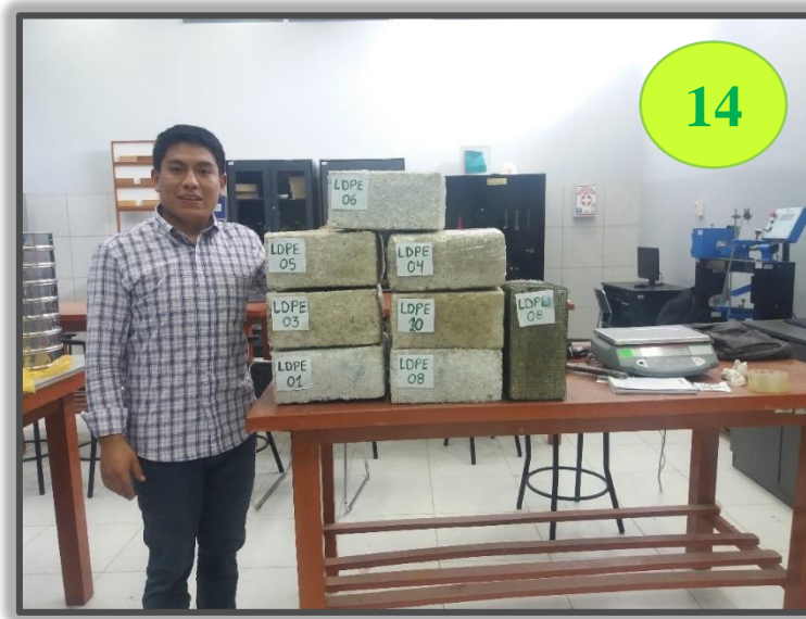
Figura N° 38: Se muestra los ladrillos de polietileno de baja densidad.
