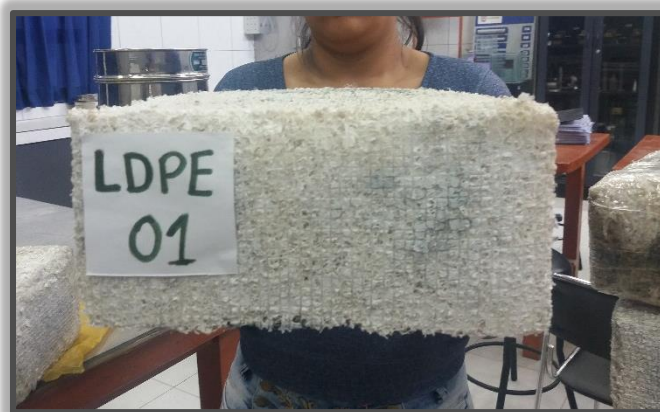
Figura N° 42: Se muestra el Ladrillo LDPE N° 01 y se observa que tiene espacios de una forma convexa
