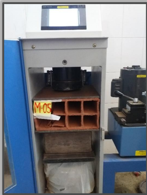
Figura N° 13: Se coloca el Ladrillo Patrón N° 05 en la prensa, y se coloca en la parte superior e inferior del ladrillo una plancha metálica.
