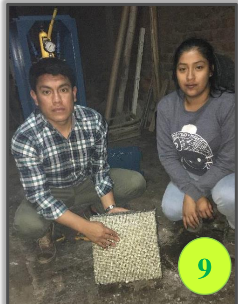
Figura N° 33: Al cerrar completamente el ladrillo se cose la malla con hilo nylon
