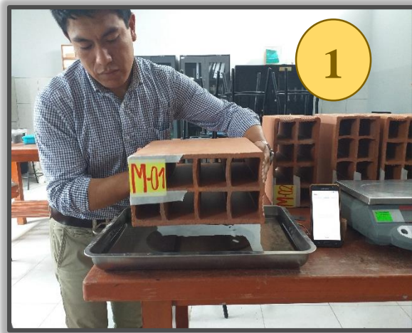
Figura N° 10: Se coloca una bandeja con agua y dos planchas de hierro para que sostenga el ladrillo patrón N°01.
