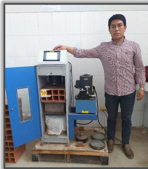
Figura N° 15: En la pantalla digital se muestra los datos donde refleja la resistencia que obtuvo el Ladrillo Patrón N° 04
