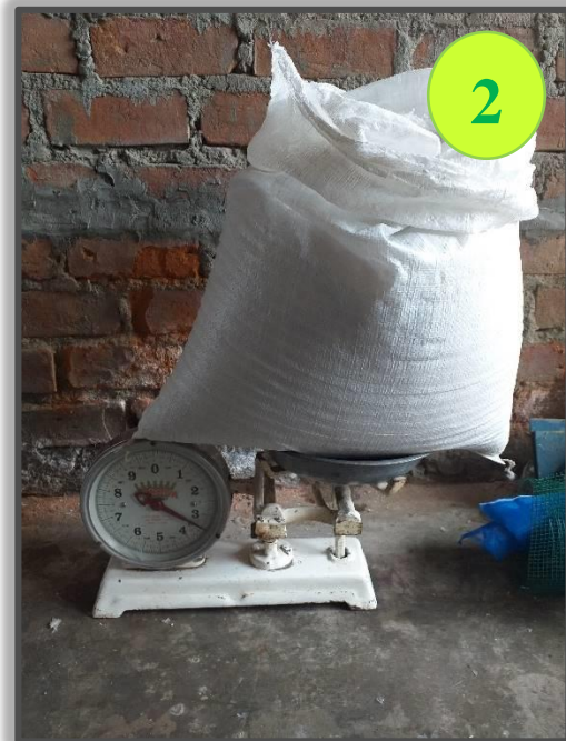
Figura N° 26: Para cada ladrillo se pesó 3.5 Kg de bolsas de polietileno de baja densidad
