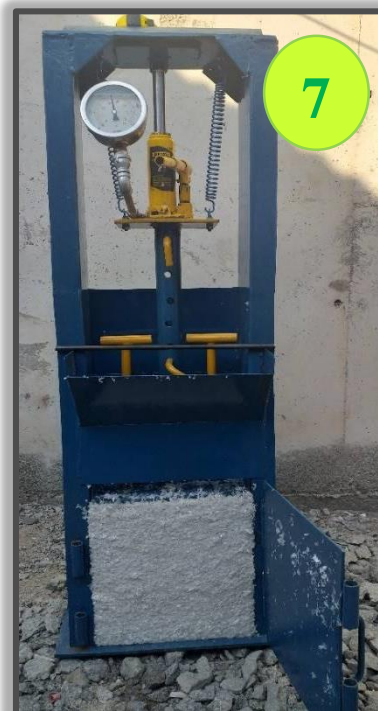
Figura N° 31: Se abre la puerta de la prensa para que se seque
