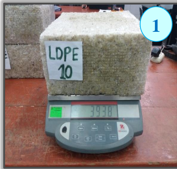
Figura N° 46: Se pesó el Ladrillo LDPE N° 10 seco ante del ensayo.
