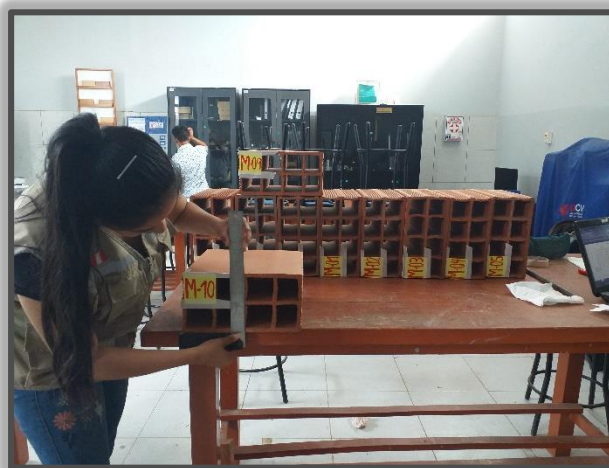
Figura N°03: Se midió la altura del Ladrillo Patrón N° 10. Para estas medidas se mide en cuatro puntos para obtener promedio y en este caso se ha tomado como guía los huecos del ladrillo
