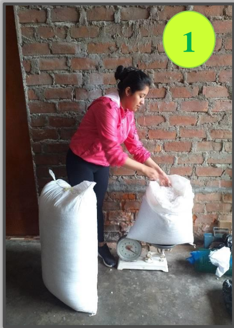
Figura N° 25: Vaciado de las bolsas de polietileno de baja densidad al recipiente a pesar
