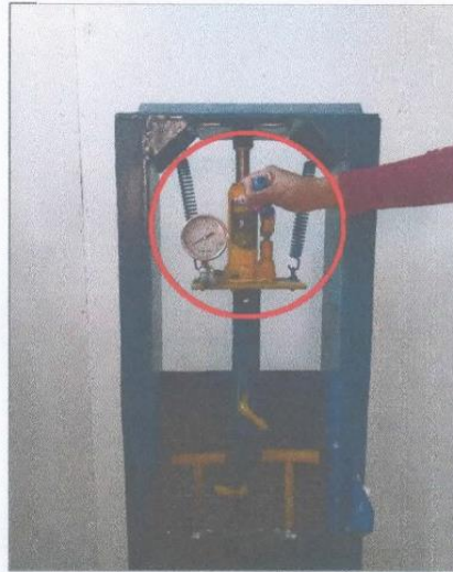
Imagen 5: Prensado de ladrillo LDPE
