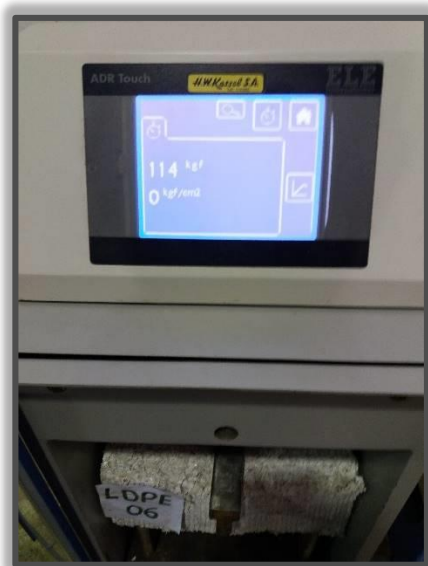
Figura N° 54: Se muestra la carga ejercida para este ensayo en el ladrillo LDPE N°06
