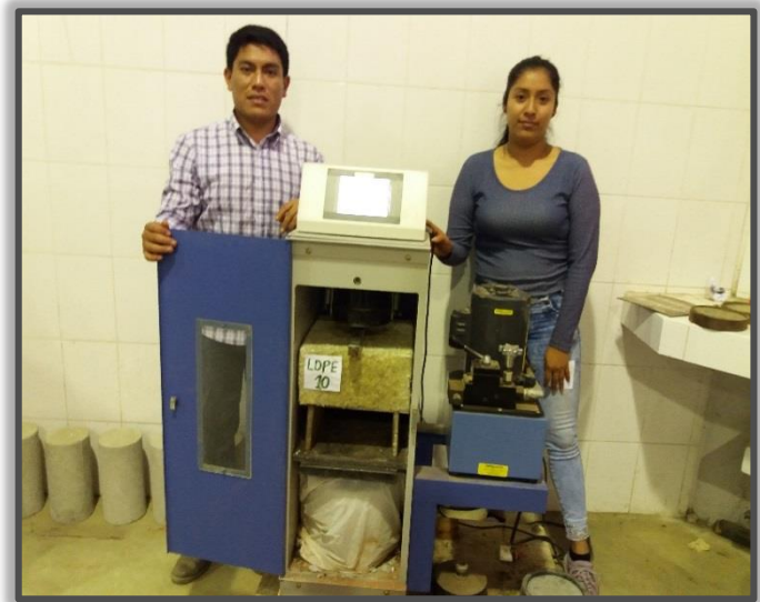
Figura N° 55: Se muestra el ensayo módulo de ruptura del Ladrillo LDPE N° 10
