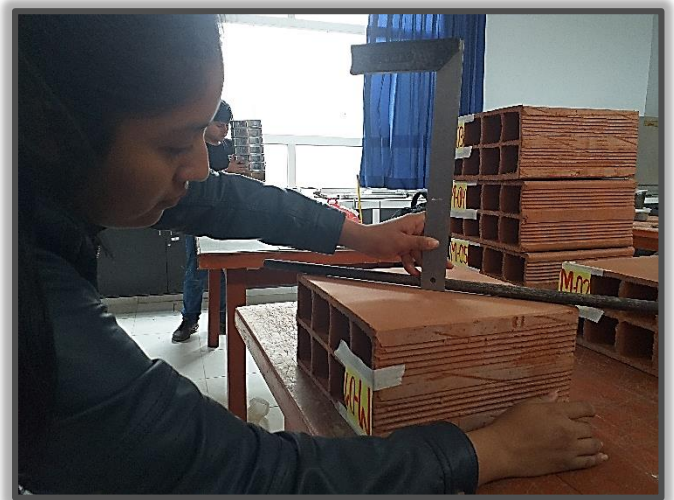
Figura N°05: Se colocó un acero liso en la superficie de la cara B y se identificó que era convexa y se pasó a medir con ayuda de una regla.
