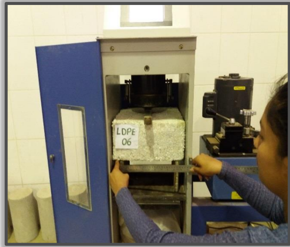
Figura N° 52: Se colocó tres varillas uno en la parte superior y dos en la parte inferior del Ladrillo LDPE N° 6 y se tomó medida de 25cm entre las varillas inferiores.
