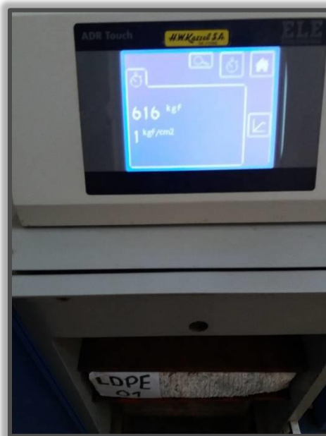
Figura N° 51: Se muestra la carga que soporto el Ladrillo LDPE N° 1.
