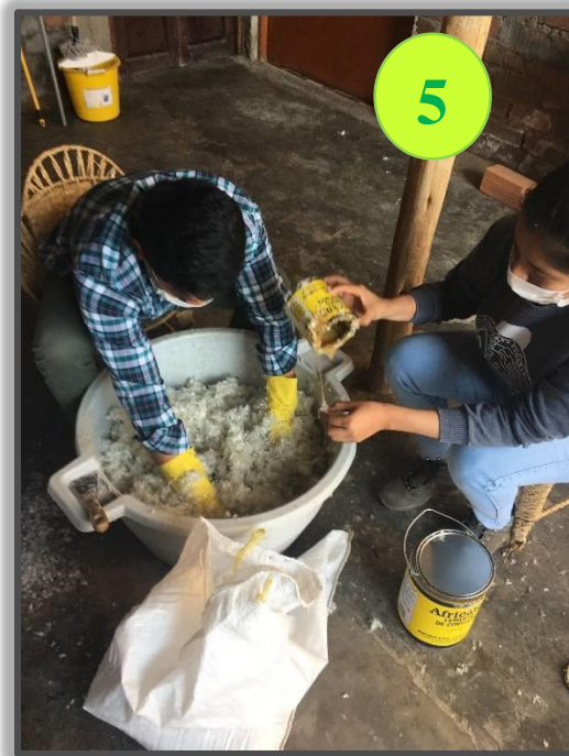
Figura N° 29: Se procedió a la mezcla del pegamento con las bolsas picadas
