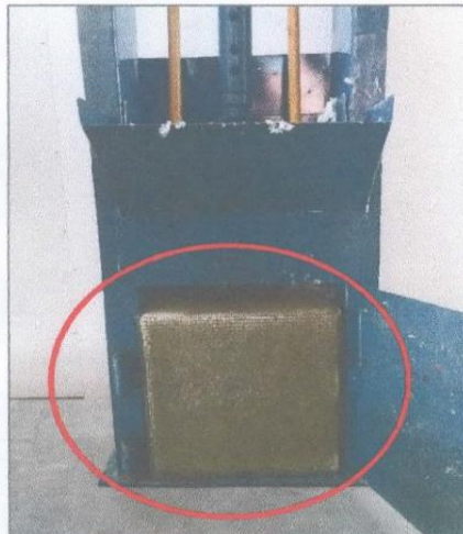
Imagen 6: Ladrillo LDPE en la prensa
