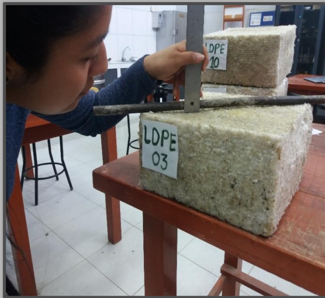
Figura N° 40: Se colocó una varilla lisa en la superficie del Ladrillo LDPE N° 03 en su cara A
