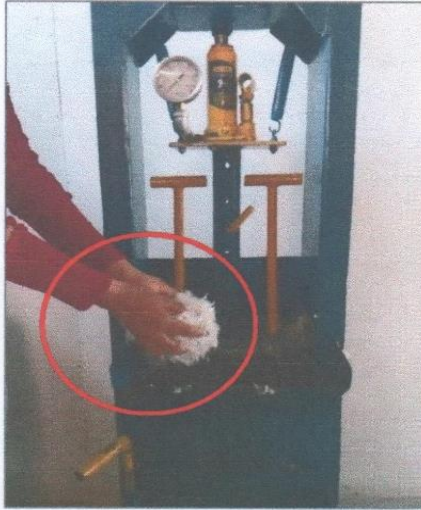
Imagen 3: Colocación de mezcla plástica
