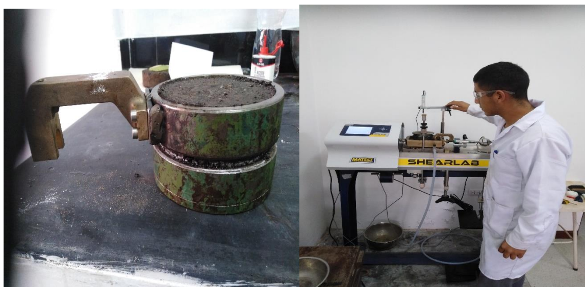
Figura N° 17: Armado de los anillos en la muestra (izquierda) ensayo de adherencia (derecha).
