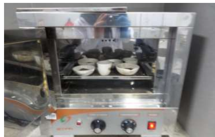
Figura 17. Análisis de Humedad de Suelo - Secado de Muestras en estufa.
