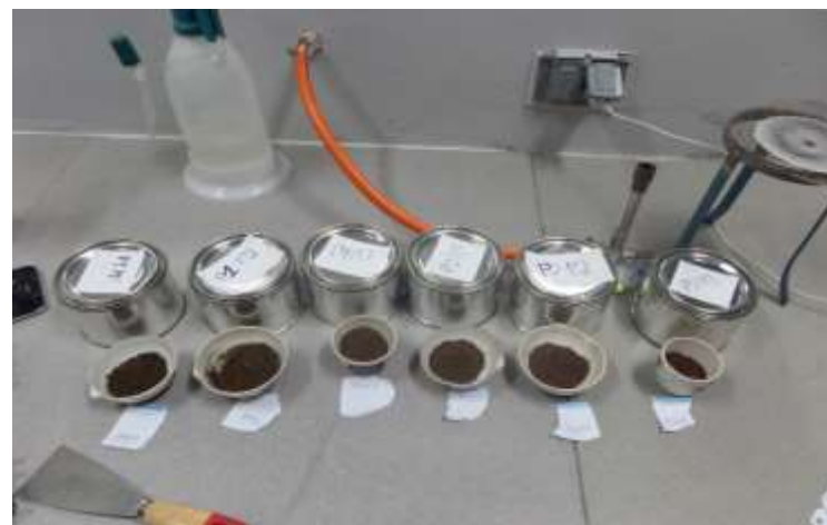
Figura 18. Análisis de Humedad de Suelo - Método Gravimétrico
