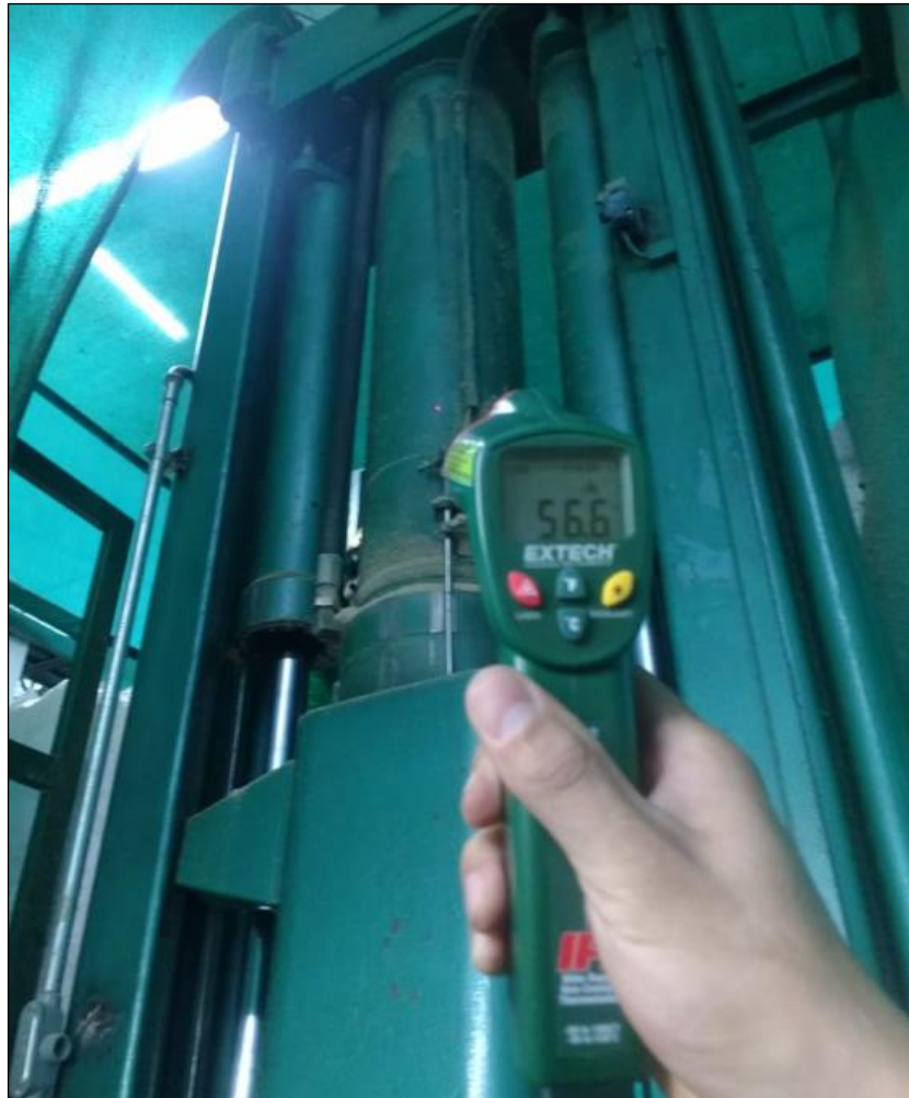
Figura 14: Medición de temperatura de los actuadores de la prensa hidráulica.
