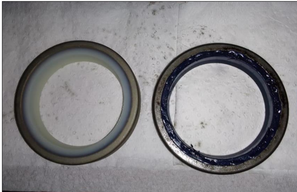
Figura 12: Retén nuevo vs retén usado con superficie endurecida con presencia de oxidación de elementos.
