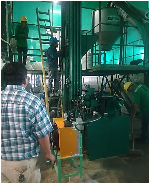
Figura 11: Realizando el diagnóstico de funcionamiento del intercambiador de calor.
