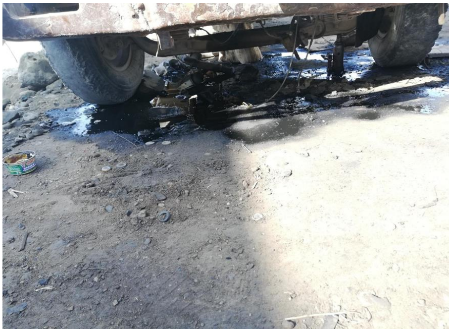
Figura 2: Derrame de aceite en el taller de olmos, generando contaminación.
