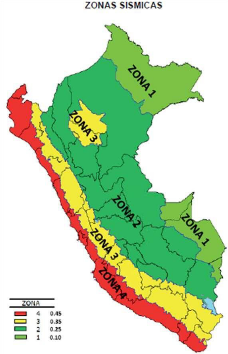
Figura N° 03 ZONAS SÍSMICAS – NORMA E-030
