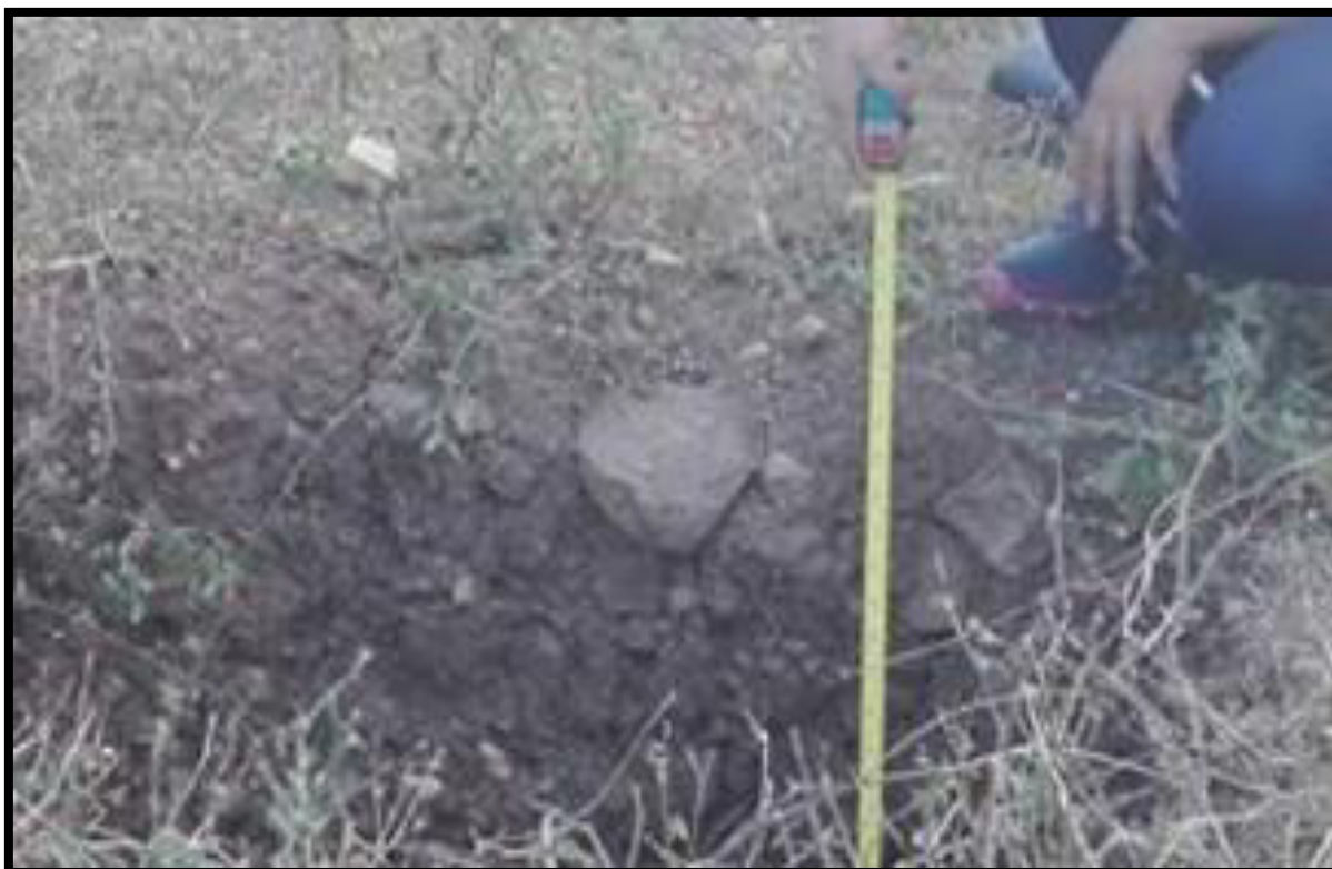
Imagen 15: Perfil estratigráfico de calicata
