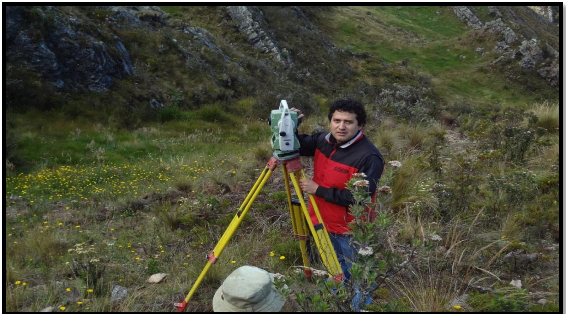
Imagen 12: Levantamiento topográfico de línea de conducción
