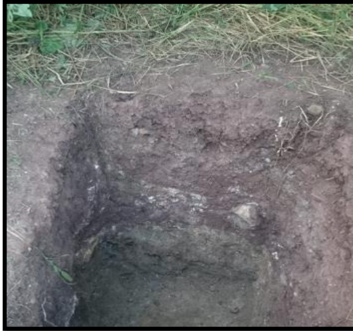
PERFIL ESTATIGRÁFICO DE CALICATA
