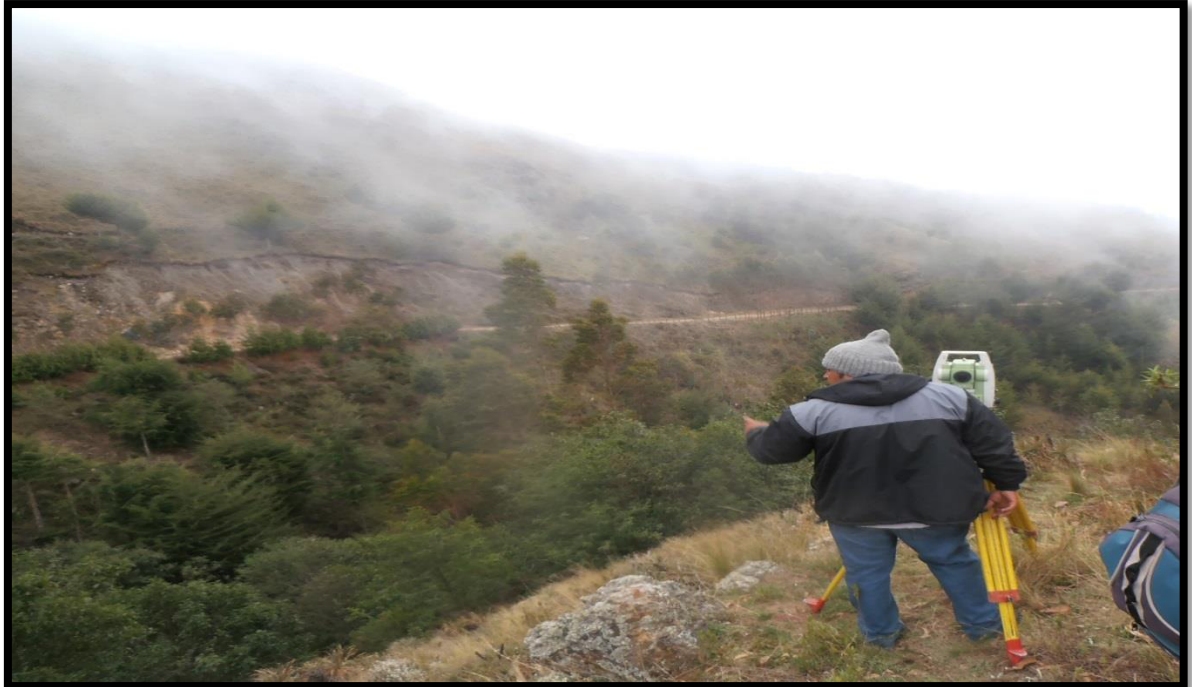
Imagen 14: Levantamiento topográfico de la red de distribución
