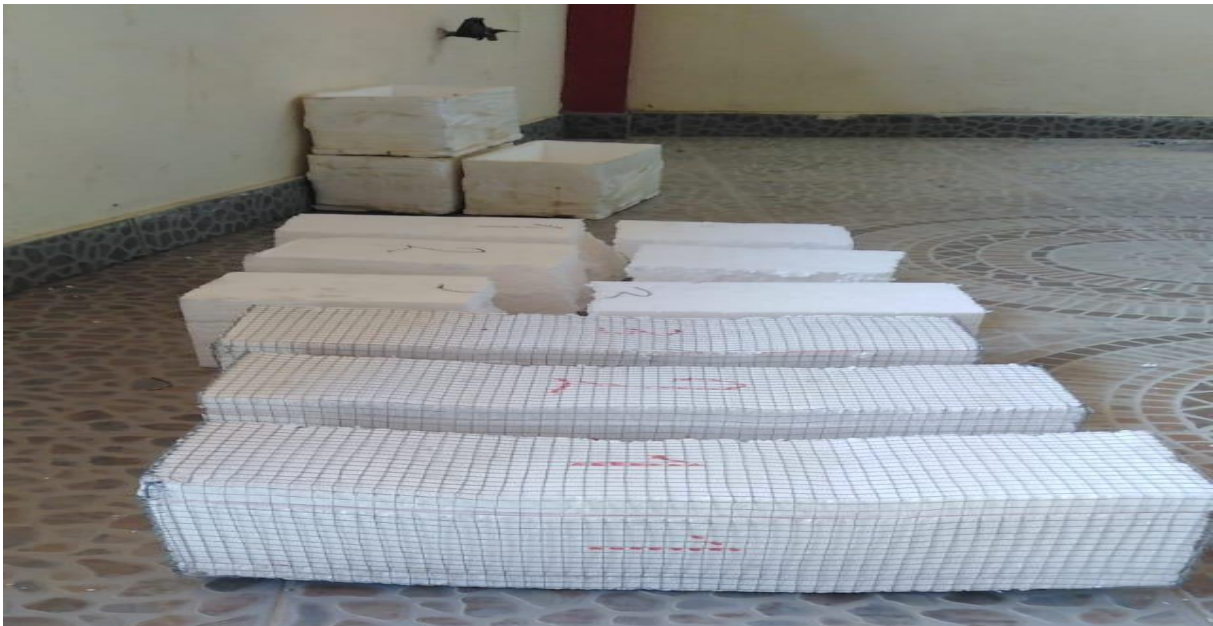
Figura 10: Resultado de los ladrillos sometidos a la prueba de flexión que se sometieron en el laboratorio de Wial –Yurimaguas. Se sometieron a esta prueba los ladrillos de tecnopor y el ladrillo de plástico reciclado.
