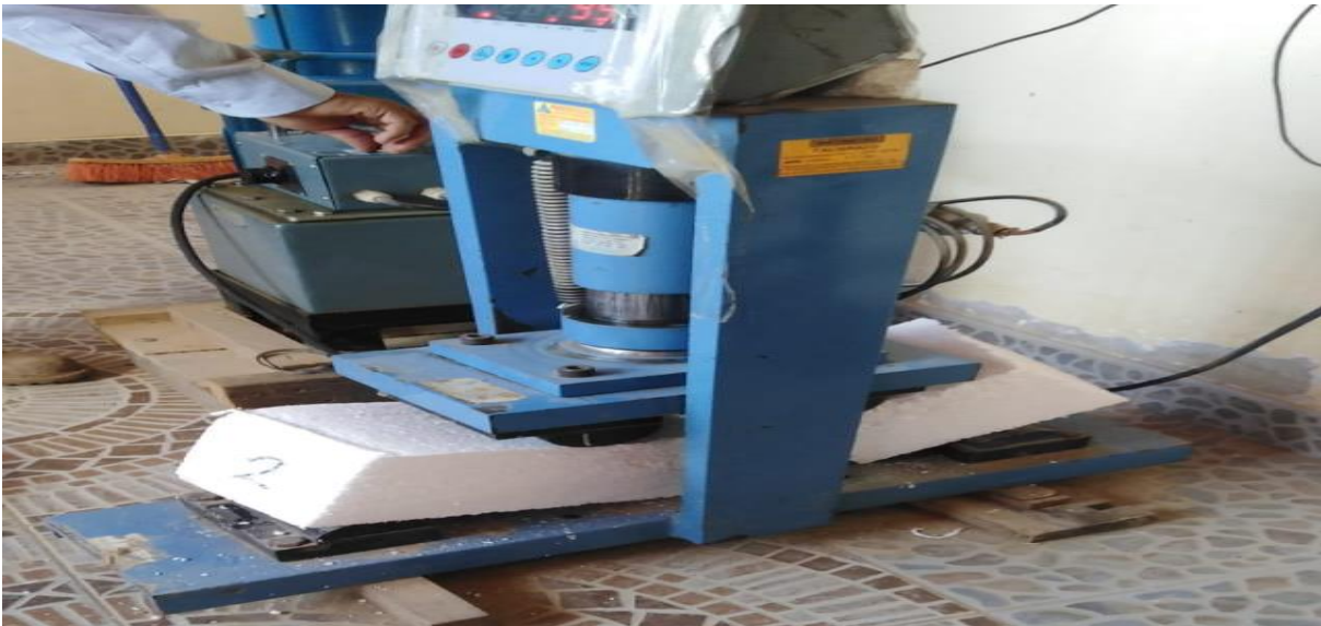
Figura 8: Prueba de flexión – Yurimaguas.
