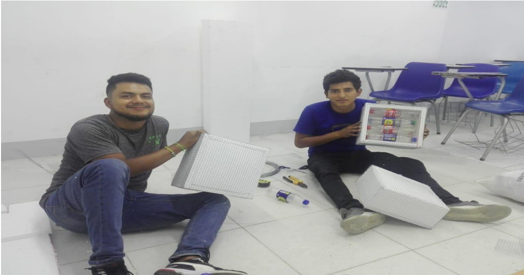
Figura 7: Elaboración del ladrillo no estructural para ser sometido en el ensayo de compresión con dimensiones de 0.22x0.15x0.30 m.
