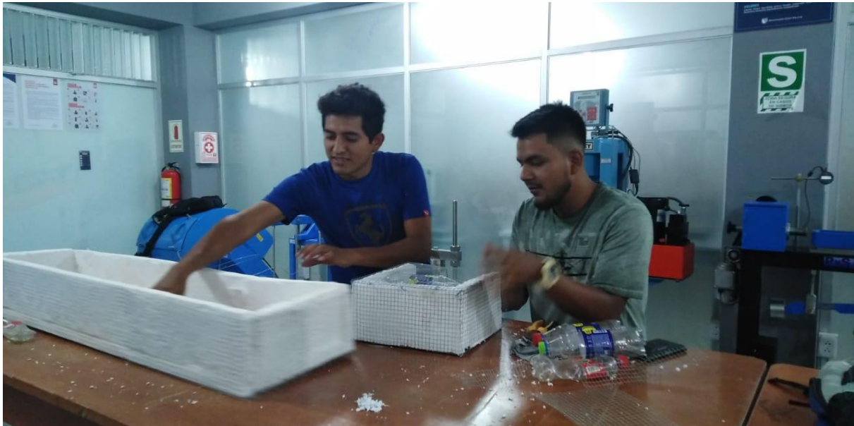
Figura 6: Elaboración del ladrillo con plástico reciclado de 0.22x0.15x0.30 m. para ser sometido al ensayo de compresión.
