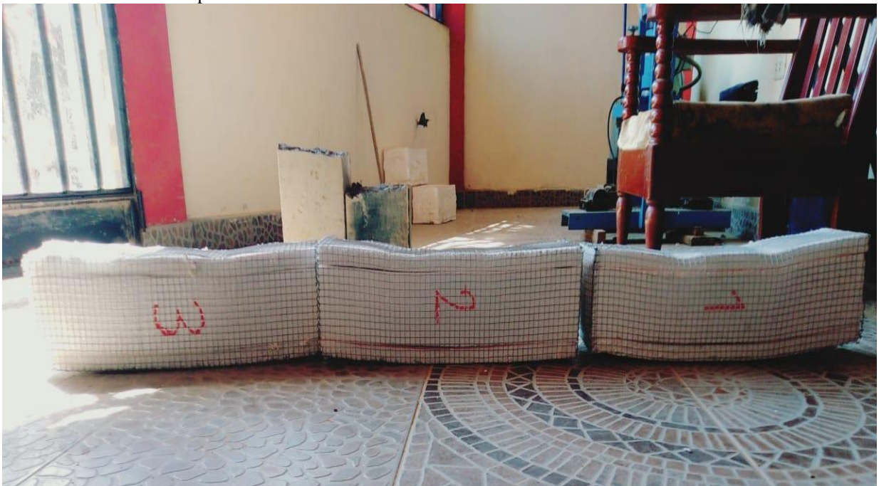
Figura 12: Resultado de flexión en el ladrillo no estructural con plástico reciclado.
