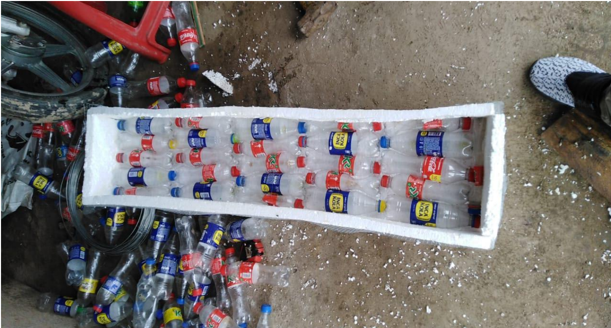
Figura 1: Elaboración de ladrillo con plástico reciclado de 0.15x0.30x1.2 cm. Fuente: Elaboración Propia.
