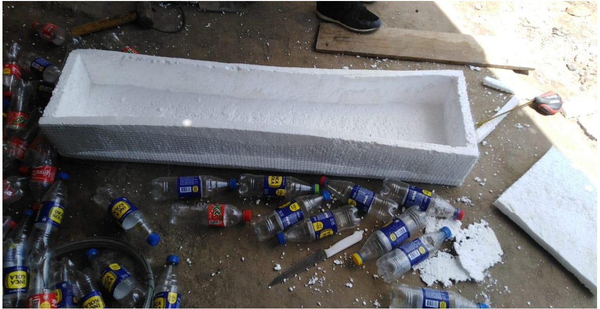
Figura 3: Elaboración del bloque de ladrillo con plástico reciclado utilizando botellas de 500ml y malla de 3/8, también tecnopor de 1pulg.
