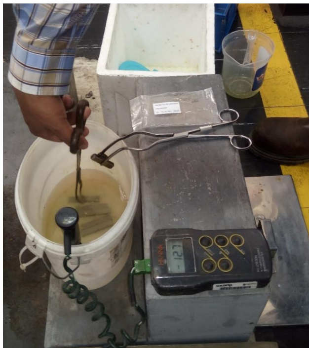
Figura 29. Disminución de temperatura de probetas a -12^{\circ}\text{C} .
