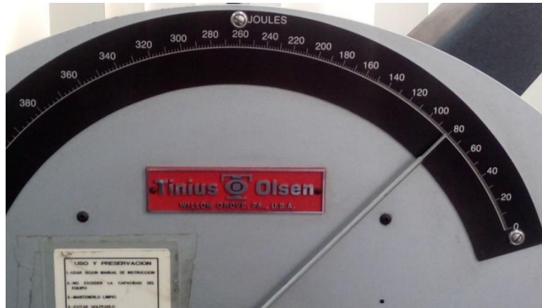
Figura 30. Resultado de capacidad de impacto en Joules.
