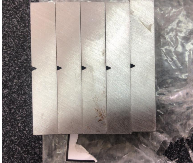
Figura 28. Preparación de probetas para ensayo Charpy.
