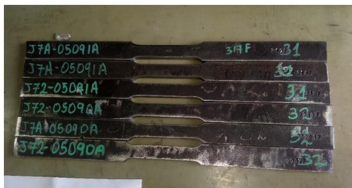
Figura 32. Probetas preparadas para ensayo por tracción.
