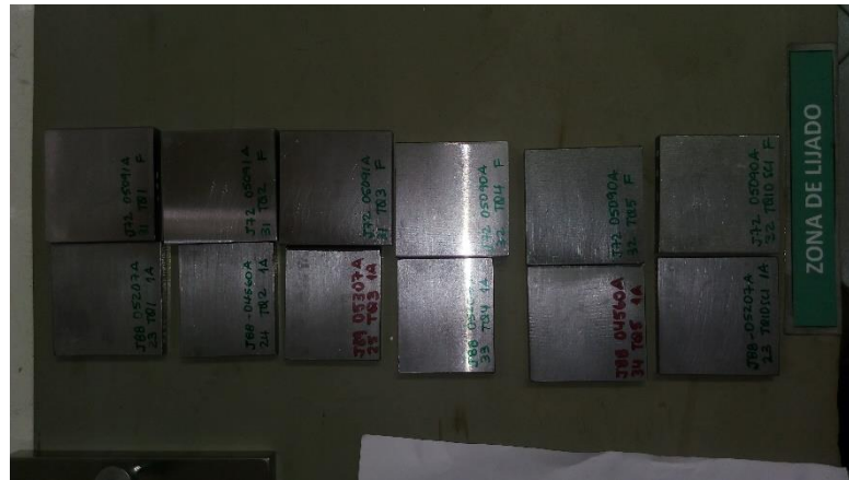
Figura 26. Probetas preparadas para pasar por el espectrómetro de emisión.
