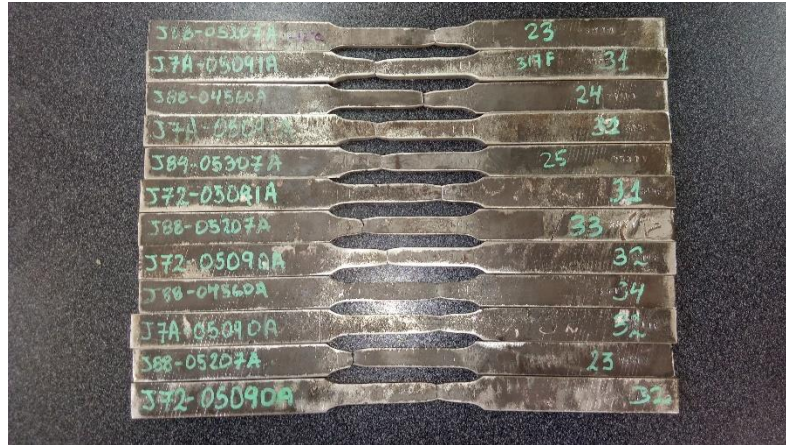
Figura 33. Probetas después de ensayo por tracción.
