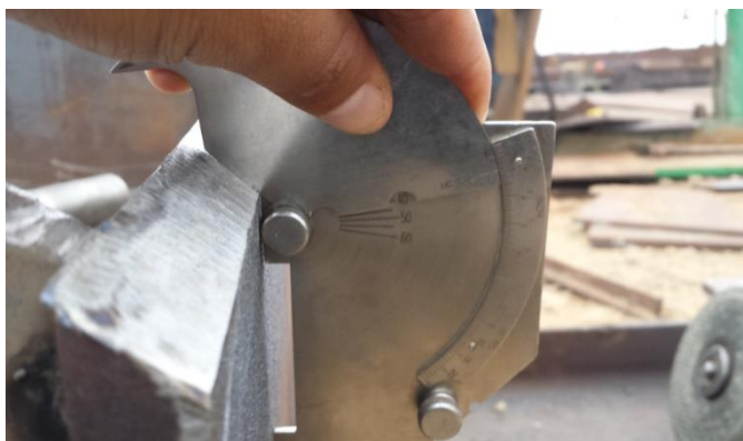
Figura 36. Bisel verificado mediante bridge cam.
