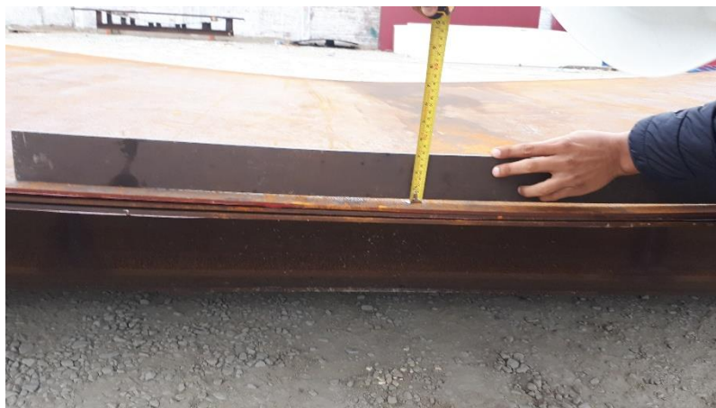
Figura 39. Verificación de rolado por plantilla.
