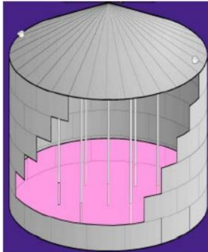
Figura 2. Tanque cilíndrico vertical con techo fijo.
