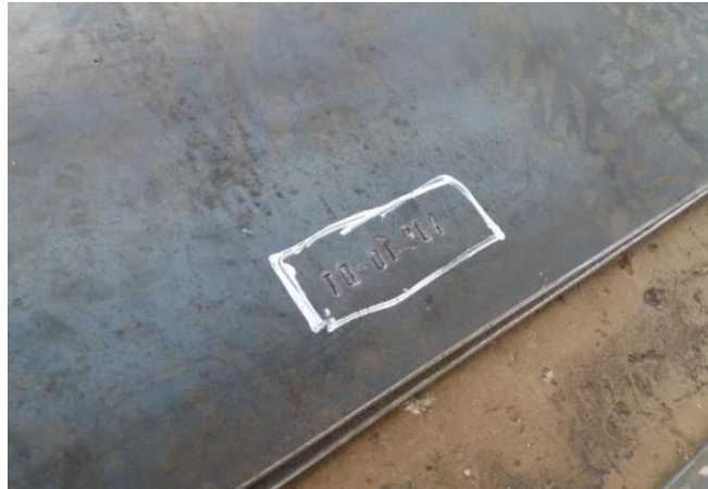
Figura 40. Plancha de casco de tanque "tipeada" en bajo relieve".
