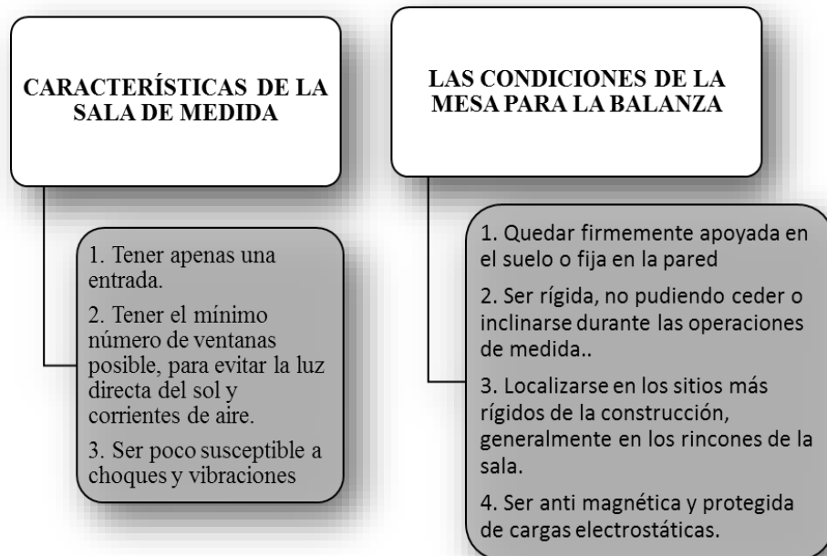
Figura 8. Características de balanza analítica
