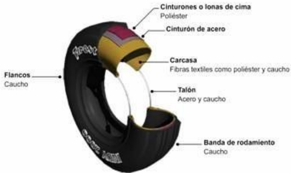
Figura 1. Composición de neumáticos de corte transversal
