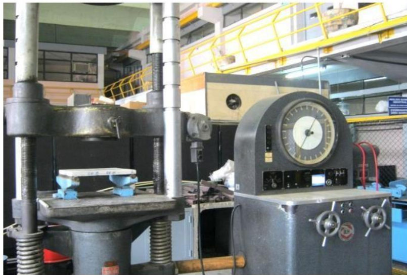
Figura 9. Máquina universal para prueba de flexión y adherencia
