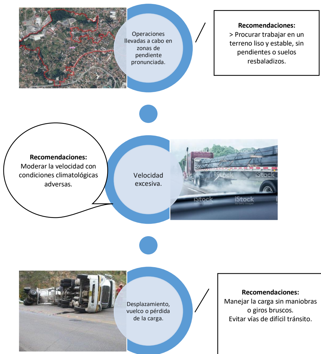
Figura 34. Atrapamientos por vuelco de vehículos o equipos de trabajo.
