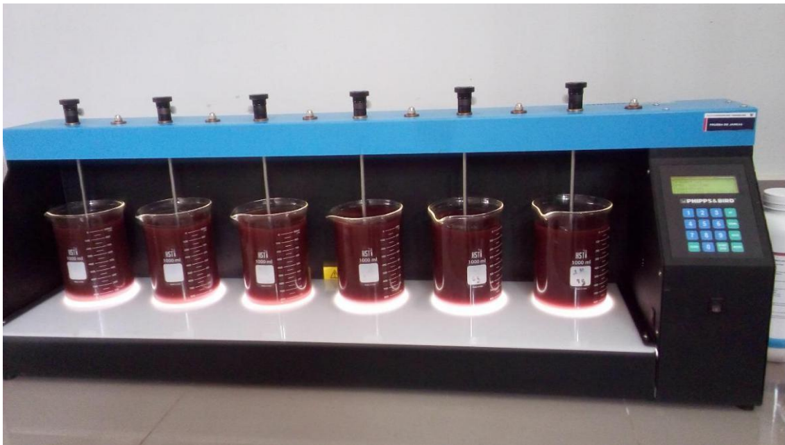
Figura 4. Prueba de jarras en el laboratorio de biotecnología de la Universidad César Vallejo.
