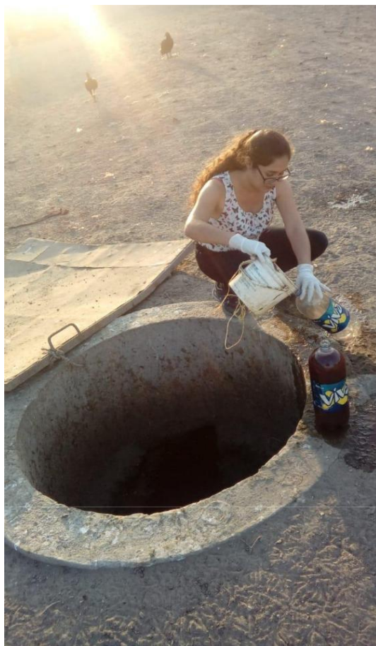
Figura 3. Toma de muestras en el sistema de drenaje del agua residual del camal.
