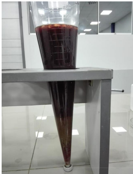
Figura 5. Proceso de decantación del tratamiento en la prueba de jarras.
