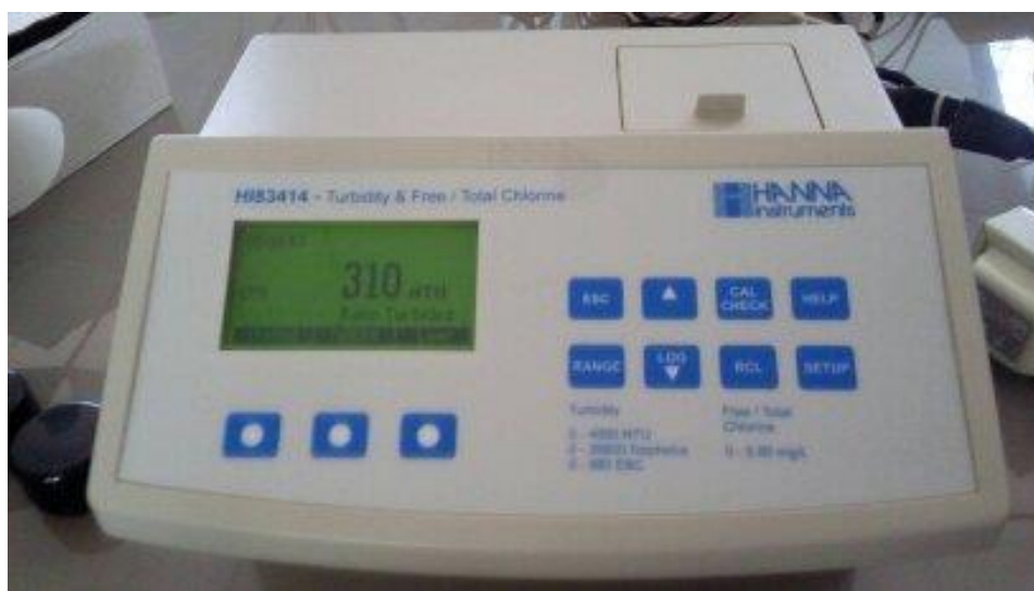
Figura 6. Medición de la turbidez.
