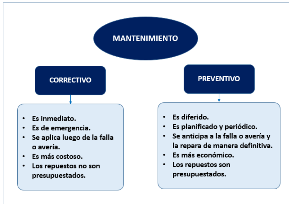
Figura 10. Diferencias entre mantenimiento correctivo y preventivo
