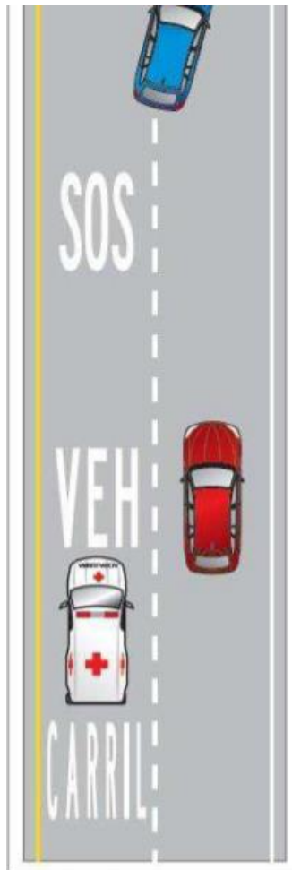
EJEMPLO DE DEMARCACIÓN EN EL PAVIMENTO DE PALABRAS, SÍMBOLOS Y LEYENDAS
