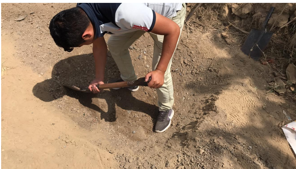
FOTO N° 02: Calicata en la progresiva 3+215 de la carretera Huanchuy. Case Cunca
