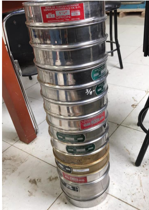
FOTO N°07: Ensayo de Granulometría en el laboratorio de suelos de la Universidad César Vallejo.
