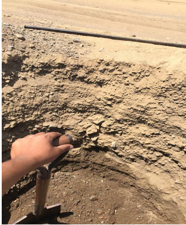
FOTO N° 03: Muestra de calicata.
