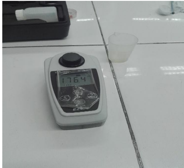
Figura N° 16. Analizando la turbidez
