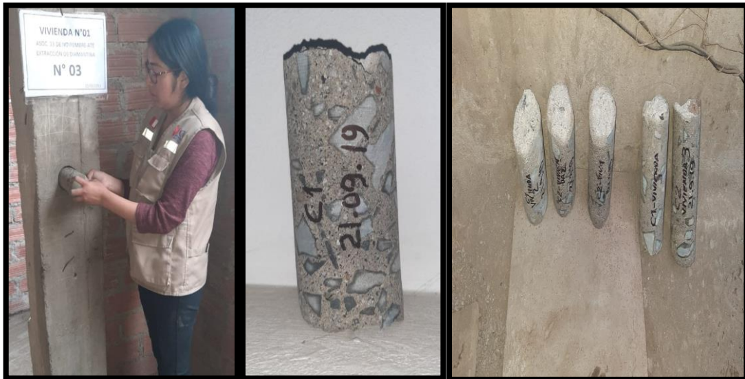
Figura 13. Preparación de la superficie para la extracción de muestra. Fuente: elaboración propia.
