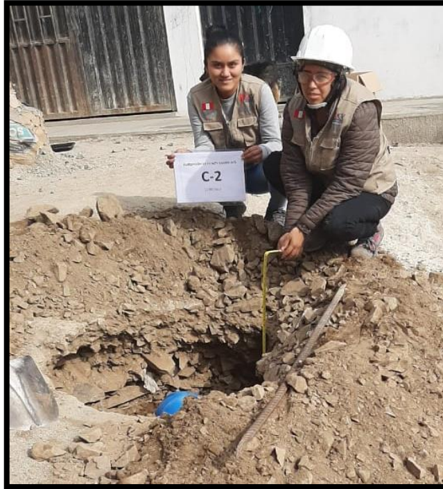
Figura 2. Ensayo de calicata. Fuente: elaboración propia.
