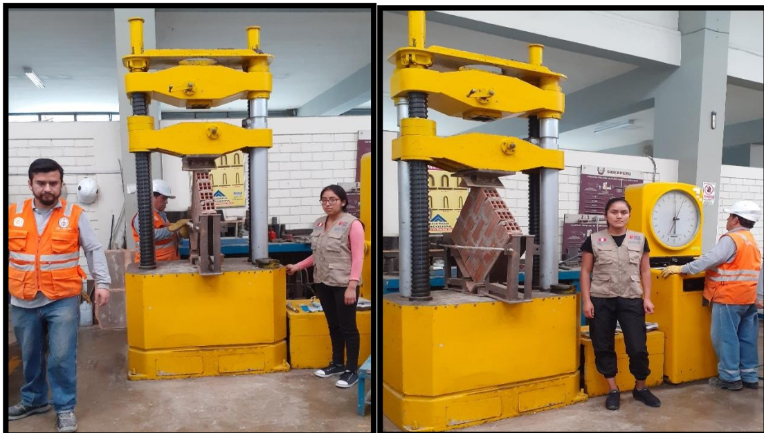
Figura 20. Ensayo de compresión diagonal en muretes. Fuente: elaboración propia.
