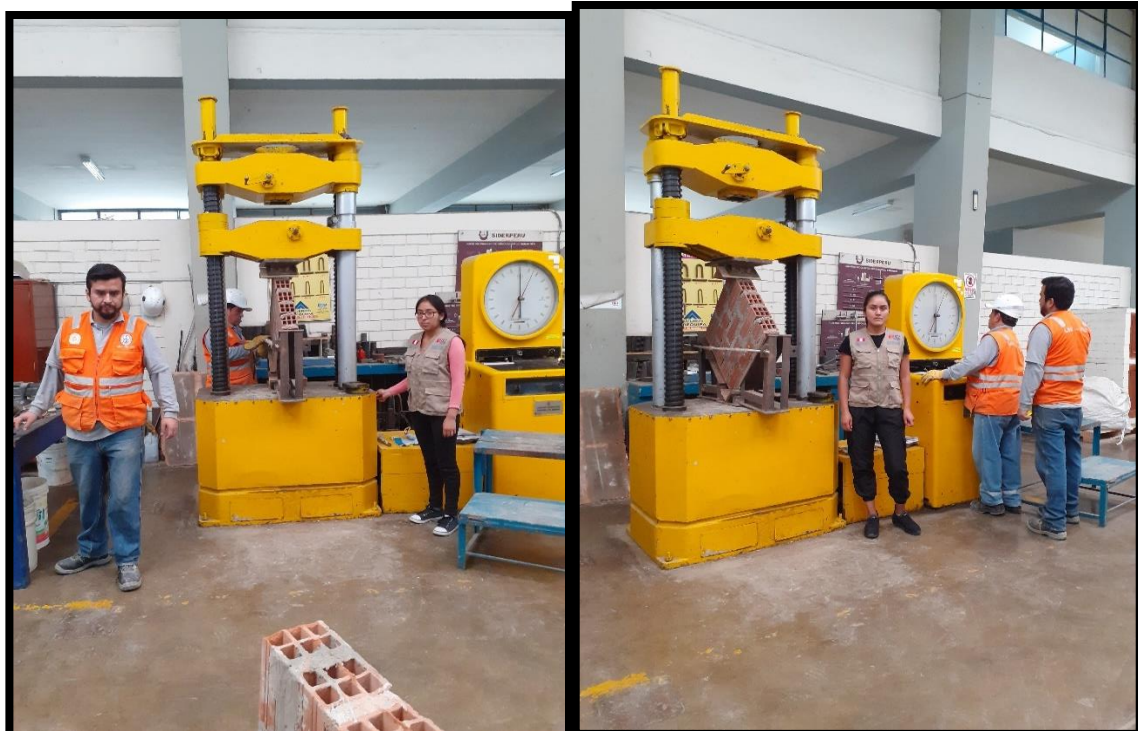
Figura 6. Ensayo a compresión diagonal de muretes en el laboratorio UNI. Fuente: elaboración propia.
