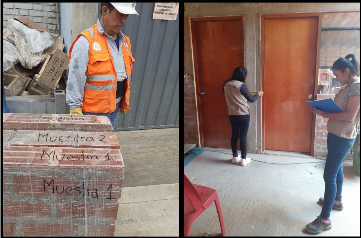
Figura 5. Extracción de muestras de muretes. Fuente: elaboración propia.
