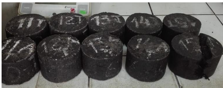
Figura 38: Briquetas después del ensayo de rotura
