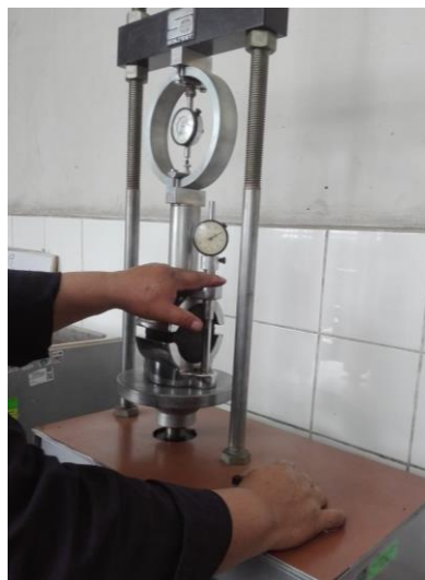
Figura 37: Prensa de compresión para briquetas lista para la rotura
