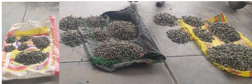
Figura 11: Cuarteo de agregado grueso para obtener muestra
