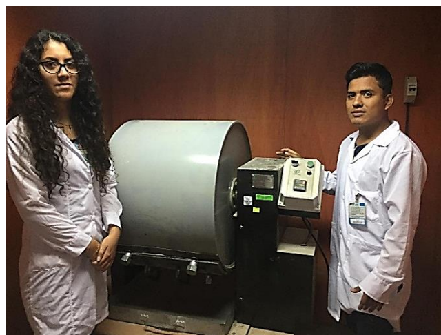
Figura 25: Maquina de los ángeles para ensayo de abrasión, en este caso debe contar con 11 esferas de acero
