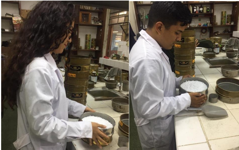
Figura 26: Tamizado de poliestireno expandido para el análisis granulométrico
