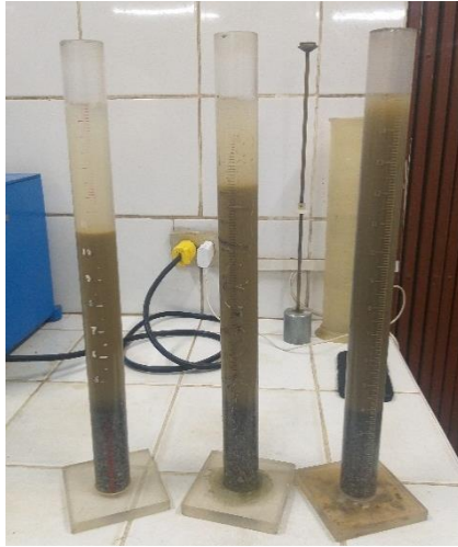
Figura 20: Especímenes para la obtención del equivalente de arena
