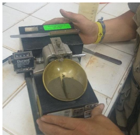
Figura 15: Ranura de muestra parcialmente cerrada
