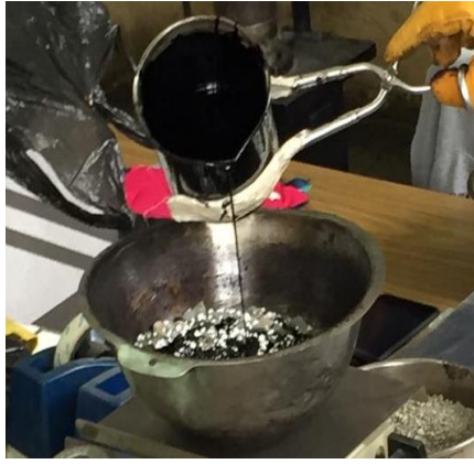
Figura 29: Incorporando cemento asfáltico a los agregados para obtener la mezcla asfáltica.
