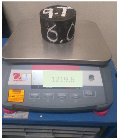
Figura 33: Peso de Briquetas saturada superficialmente seco en aire
