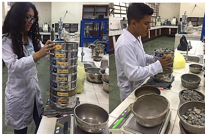
Figura 12: Tamizado de agregados gruesos y finos
