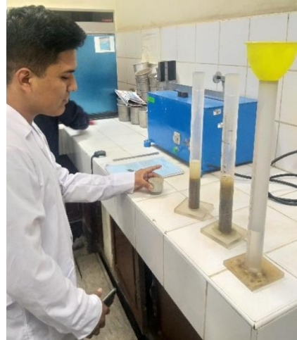
Figura 16: Vertiendo la última muestra de arena al cilindro para luego agitar en la maquina
