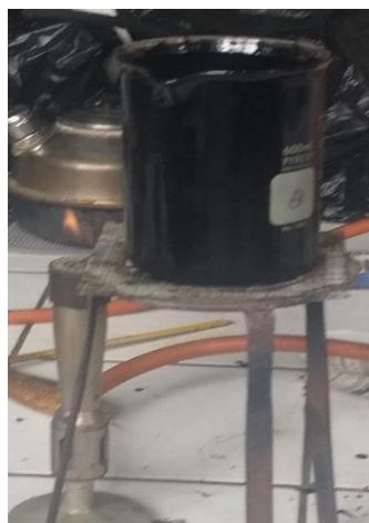
Figura 28: Calentando el cemento asfáltico a una temperatura de +/-
