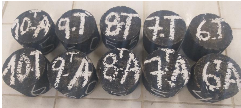
Figura 30: Briquetas (15unid.) contiene agregados, PEN 60/70, aditivo y 0,3% de poliestireno
