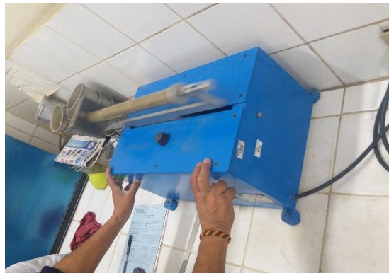
Figura 18: Agitando el cilindro de arena por 45 \pm 1 s
