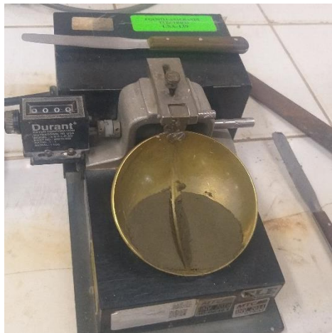
Figura 14: Con ayuda del acanalador se divide la muestra, para proceder a los golpes hasta cerrar la ranura abierta
