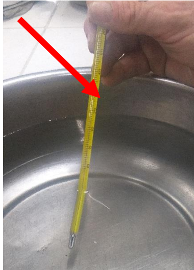
Figura 32: Temperar el agua a 25°C para luego sumergir las briquetas
