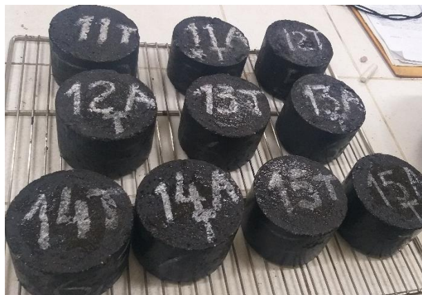
Figura 34: Briquetas superficialmente saturadas, para luego ser enviadas a baño María
