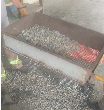
Figura 10: Tamizado (malla 3/4") de agregado grueso para dar inicio al análisis granulométrico
