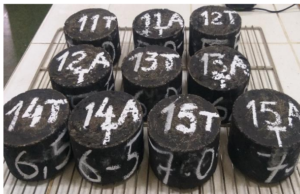
Figura 31: Muestra para comenzar el ensayo Marshall, contiene agregados, PEN 60/70, aditivo y 0,5% de poliestireno
