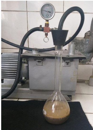
Figura 21: Eliminando burbujas de aire para obtener peso específico
