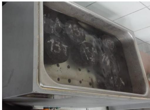
Figura 36: Briquetas en baño maría
