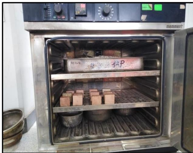
*Figura 20.* Se coloca las muestras en el horno para secar durante 24 hr a una temperatura de  $103 \pm 2^{\circ}\text{C}$ .
