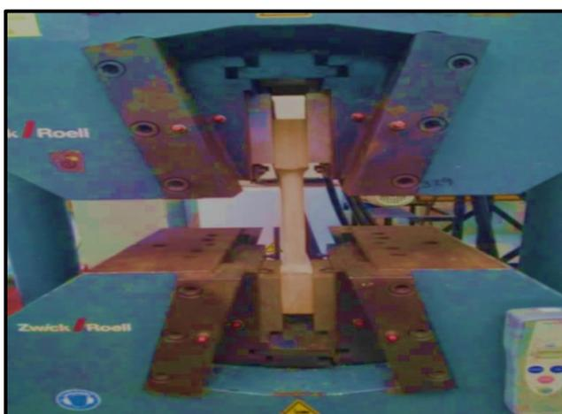
*Figura 14.* Ensayo de Tracción en las instalaciones del LEM-FIC-UNI.
