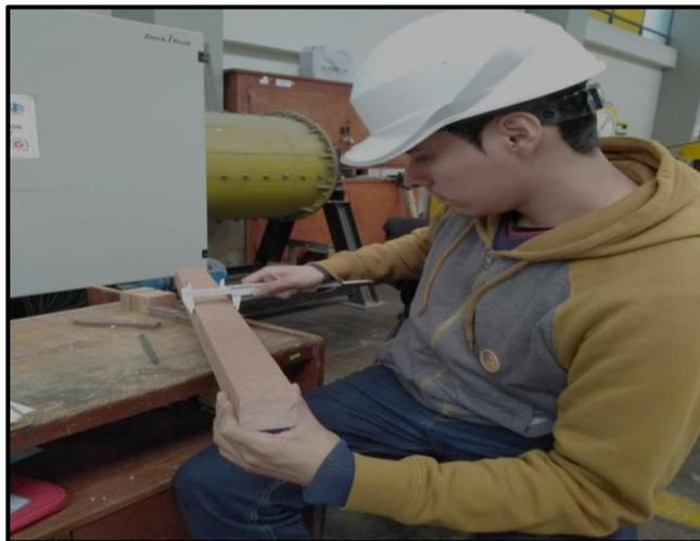
*Figura 11.* Probetas de dimensiones 5x5x76cm (06 und) para el ensayo de flexión estática.
