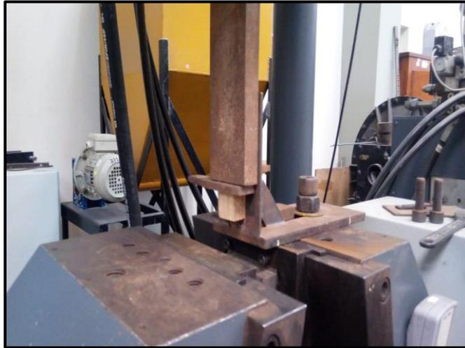
*Figura 16.* Ensayo de Cizallamiento paralelo al grano en las instalaciones del LEM-FIC-UNI.
