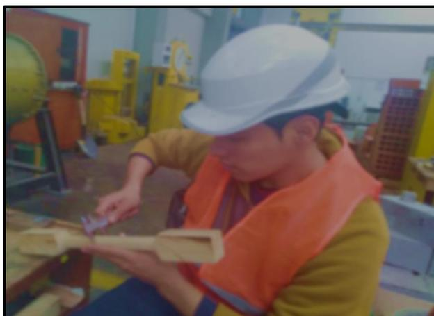
*Figura 13.* Probetas de dimensiones 5x5x45cm con diámetro de 1" (06 und) para el ensayo de tracción.
