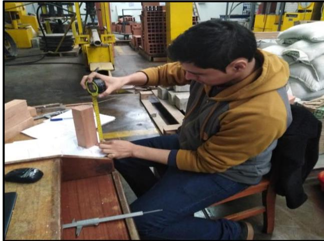
*Figura 7.* Probetas de dimensiones 5x5x20cm (06 und) para el ensayo de compresión axial al grano.
