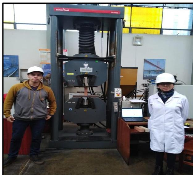
Figura 24. Máquina Universal (calibrada) para la realización de los ensayos.
