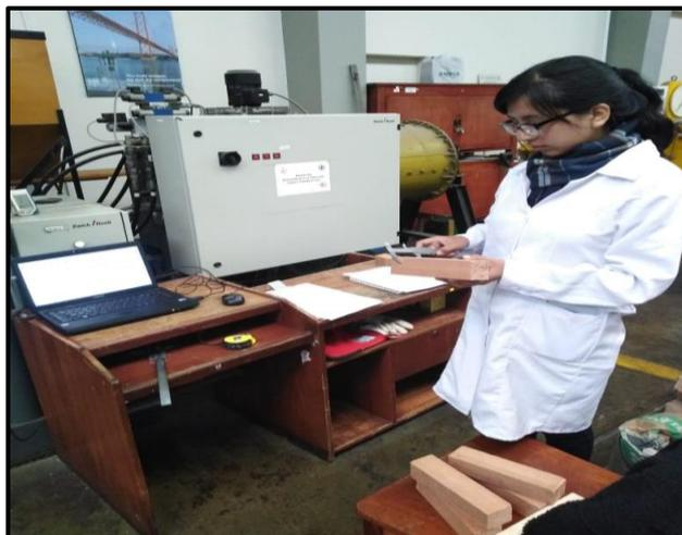
*Figura 9.* Probetas de dimensiones 5x5x15cm (06 und) para el ensayo de compresión perpendicular al grano.
