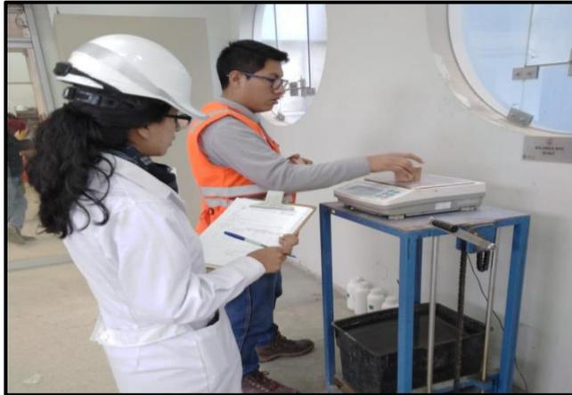
*Figura 19.* Se pesa las probetas para el ensayo de Contenido de Humedad en las instalaciones del LEM-FIC-UNI.
