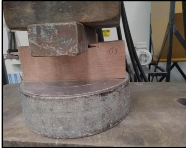
*Figura 10.* Ensayo de Compresión Perpendicular al grano en las instalaciones del LEM-FIC-UNI.
