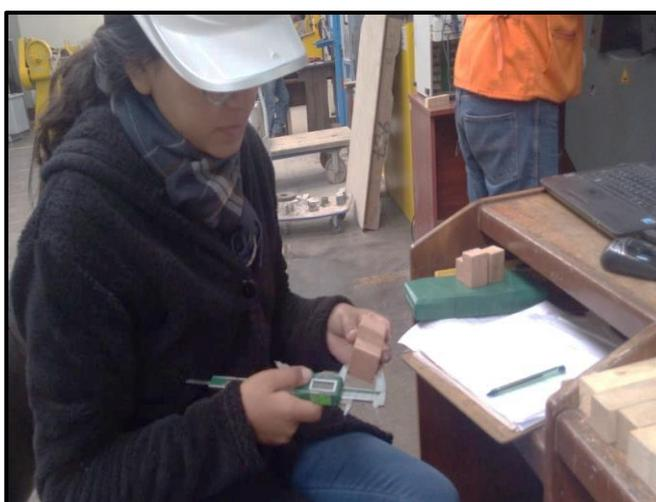
*Figura 15.* Probetas de dimensiones 3.5x5x4.5cm con una abertura de 2x3.5cm (06 und) para el ensayo de cizallamiento paralelo al grano.
