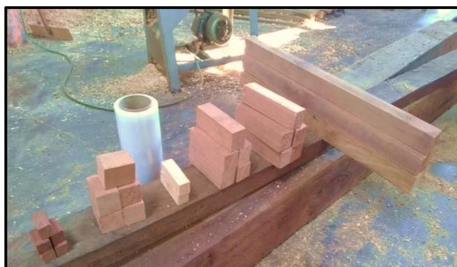
Figura 2. Aserrado de la madera roble corriente conforme a las medidas establecidas en las NTP.
