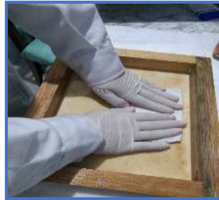
Fuente: Elaboración propia Figura N° 31: Transferencia y moldeado de la celulosa capturada.
