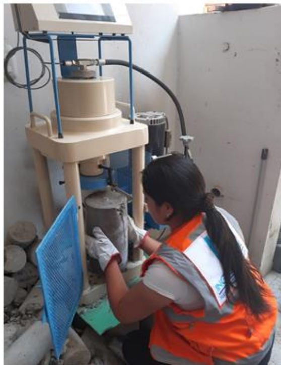
FOTO15: PRUEBA DE RESISTENCIA A 14 DIAS
