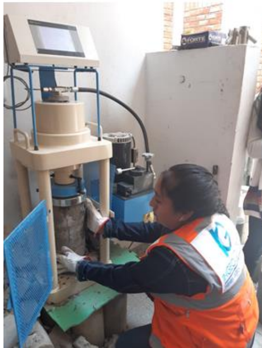
FOTO15: PRUEBA DE RESISTENCIA A 28 DIAS
