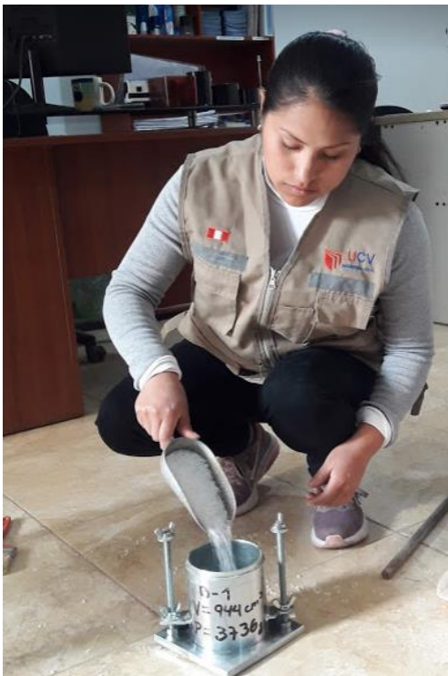
FOTO 9: PESO UNITARIO COMPACTADO DEL POLIPROPILENO
