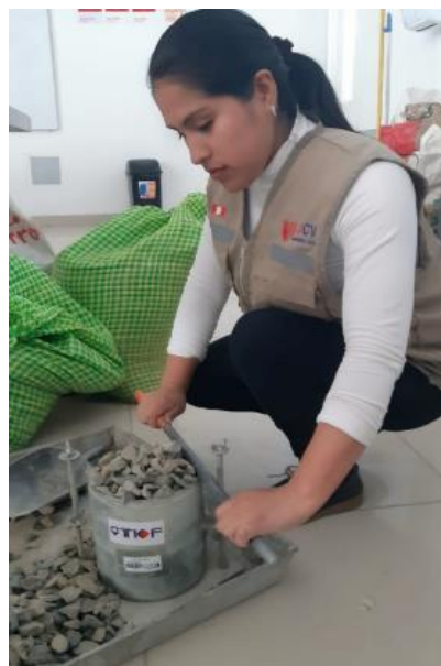
FOTO 6: PESO UNITARIO SUELTO DEL AGREGADO GRUESO
