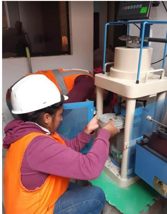
FOTO15: PRUEBA DE RESISTENCIA A 14 DIAS
