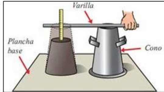
Figura 4: Medida de la trabajabilidad del concreto mediante el cono de abrahams
