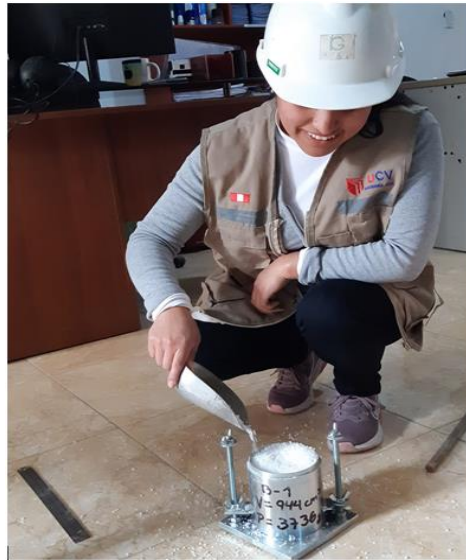
FOTO 7: PESO UNITARIO SUELTO DEL AGREGADO FINO
