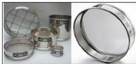
Figura 7: Tamices usados en la determinación del agregado grueso y fino
