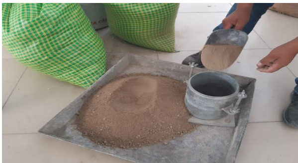
FOTO 8: PESO UNITARIO COMPACTADO DEL AGREGADO GRUESO
