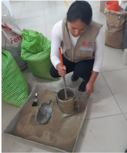
FOTO 9: PESO UNITARIO COMPACTADO DEL POLIPROPILENO
