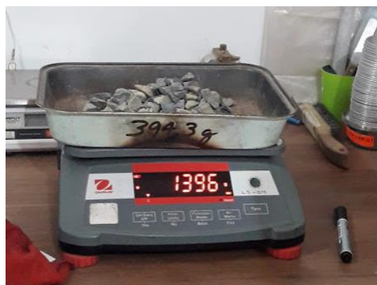
FOTO 6: PESO UNITARIO SUELTO DEL AGREGADO GRUESO
