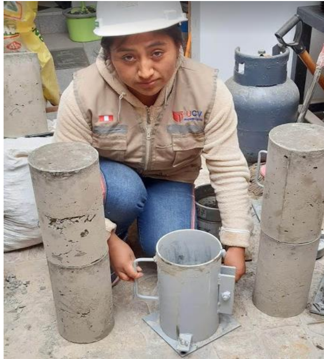
FOTO 13:RETIRODEL DE LAS PROBETAS DE LOS MOLDES METALICOS
