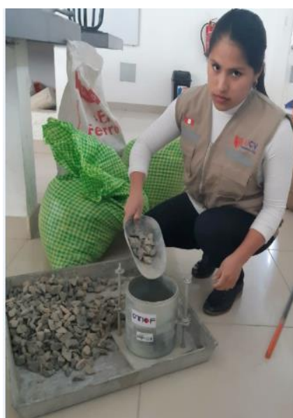
FOTO 6: PESO UNITARIO SUELTO DEL AGREGADO GRUESO
