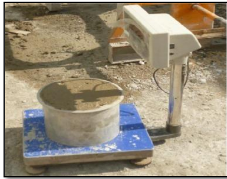
Figura 6: Ensayo de peso unitario
