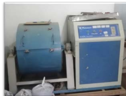
Figura N° 16. Ensayo de desgaste.
