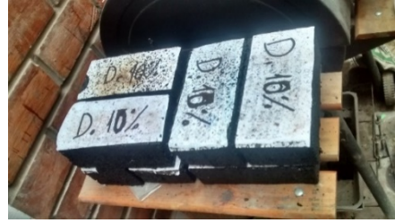
Figura N° 30. Adoquin de asfalto.
