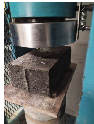
Figura N° 36. Ensayo a la flexión.
