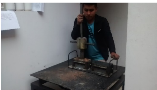
Figura N° 21. Elaboración de los adoquines.
