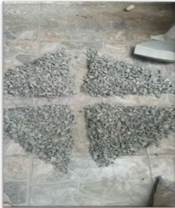
Figura N° 11. Cuarteo de los agregados.
