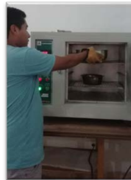
Figura N° 14. Secado de los agregados.
