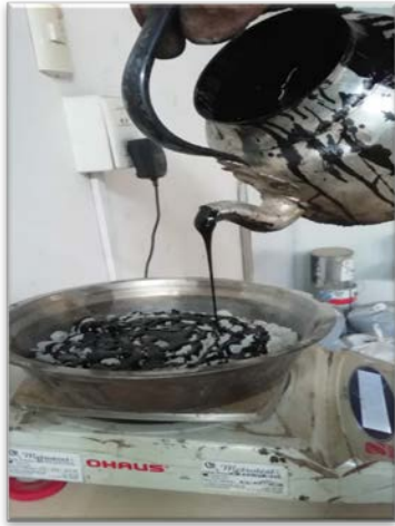
Figura N° 23. Elaboración de la mezcla asfáltica.
