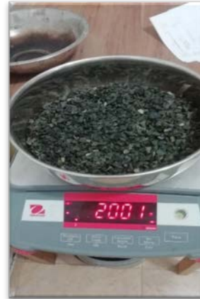
Figura N° 12. Peso específico agregado grueso.
