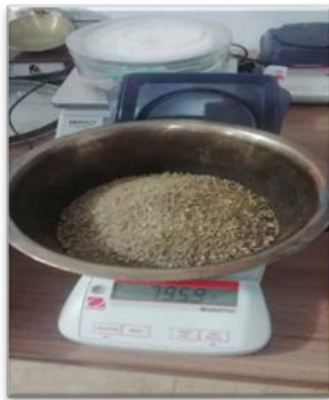
Figura N° 13. Peso específico agregado fino.
