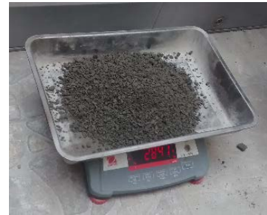
Figura N° 20. Pesado del concreto.
