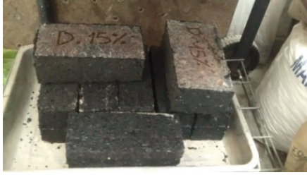
Figura N° 29. Adoquin de asfalto.
