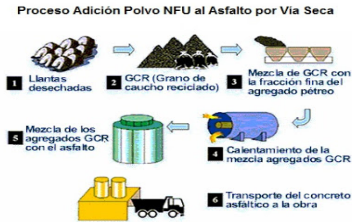
Figura N°5. Proceso de adición de polvo por vía seca Fuente: Fajardo y Vergaray, 2014.
