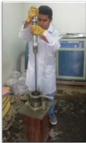
Figura N° 25. Elaboración de briquetas.
