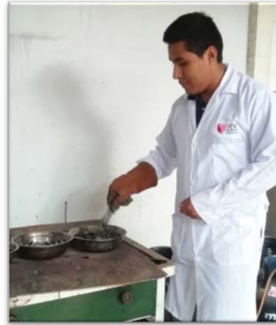
Figura N° 24. Mezclado de la mezcla asfáltica.
