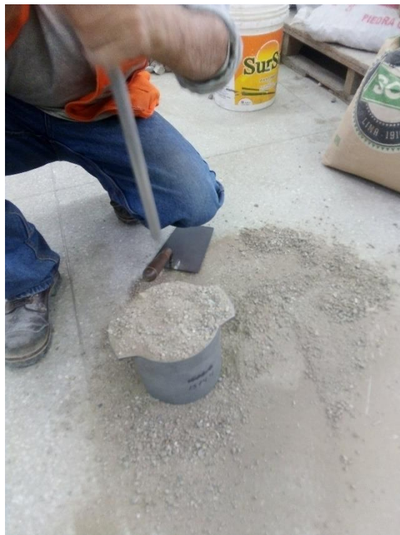
Figura N°31. Rellenado de agregado compactado al recipiente
