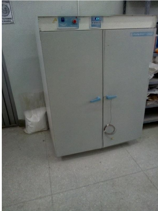
Figura N°22. Secado de los agregados en el horno durante 24horas
