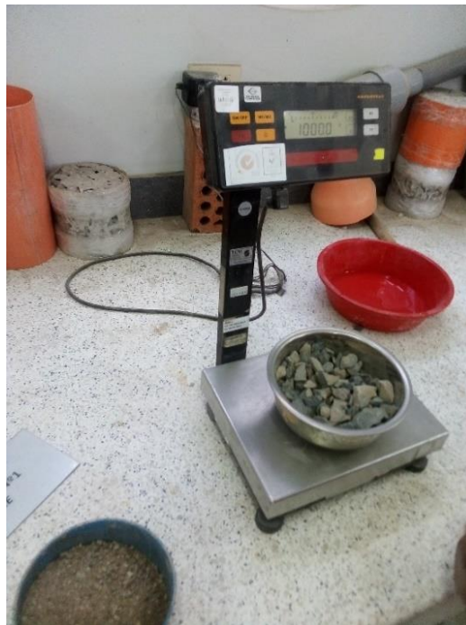
Figura N°35. Peso para el contenido de humedad se necesitó 1000g de agregado fino
