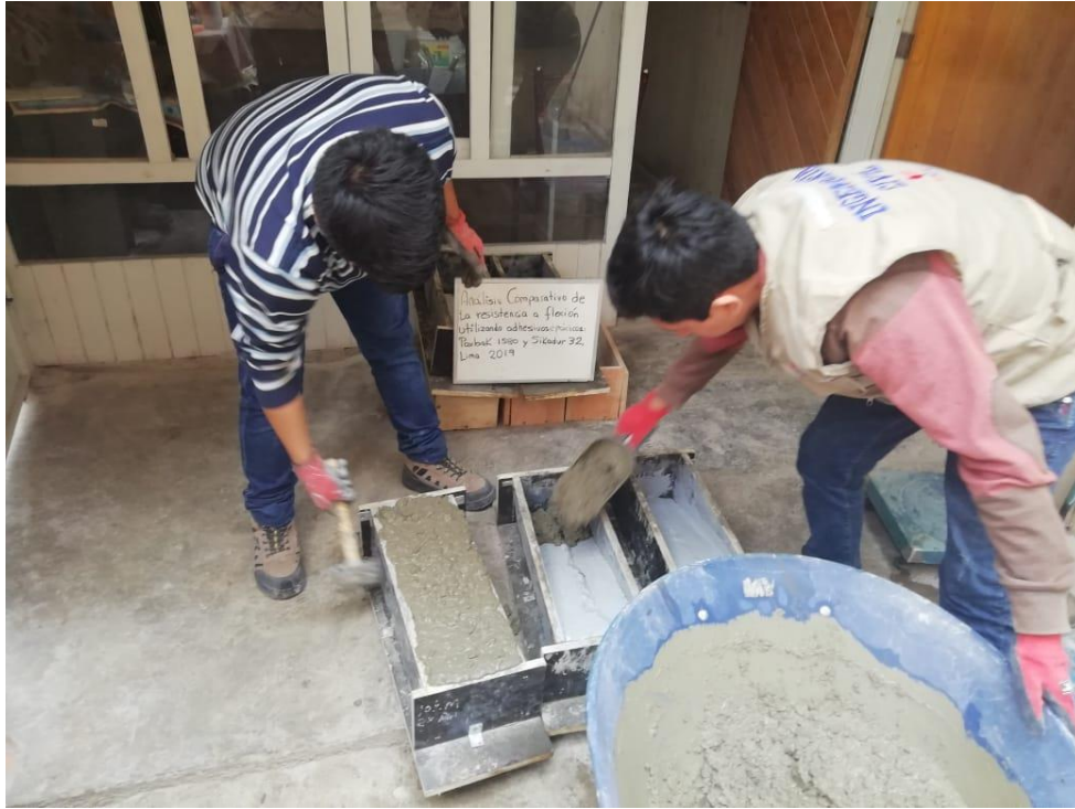
Figura N°50. Nuevo vaciado sobre el adhesivo epóxico
