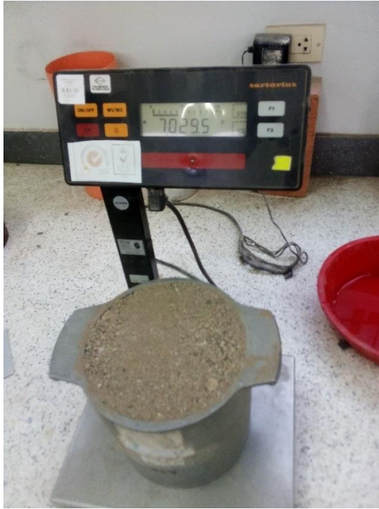
Figura N°32. Peso del agregado fino compactado + recipiente
