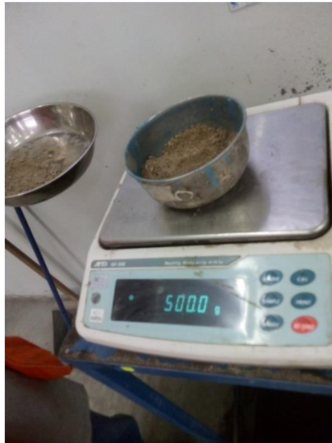
Figura N°34. Para el contenido de humedad se necesitó 500g de agregado fino
