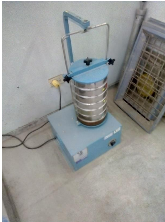
Figura N°25. Zarandeo de los tamices para el agregado fino desde N°4 – N°100
