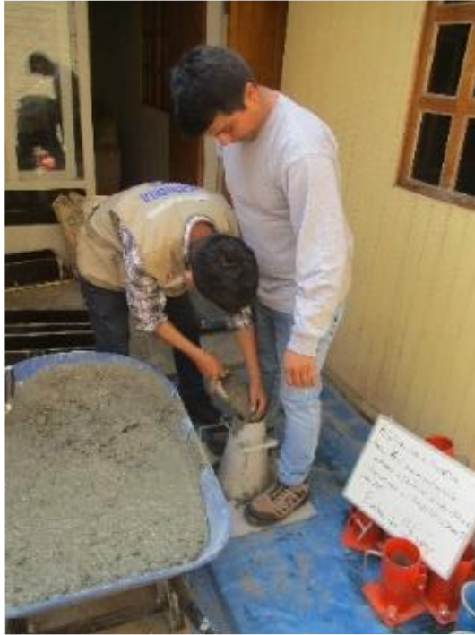
Figura N°42. Prueba de slump
