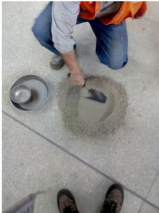
Figura N°23. Selección de muestra del agregado fino, lo cual consiste en hacer una división en 4 partes y tomar los 2 extremos de la división
