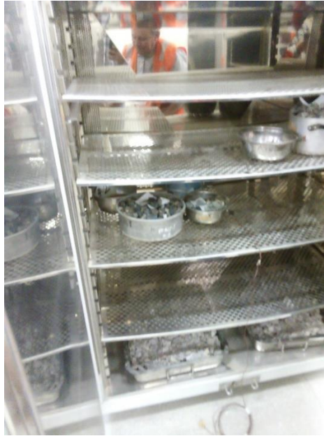
Figura N°36. Secado del agregado en el horno durante 24horas para luego volver a ser pesado
