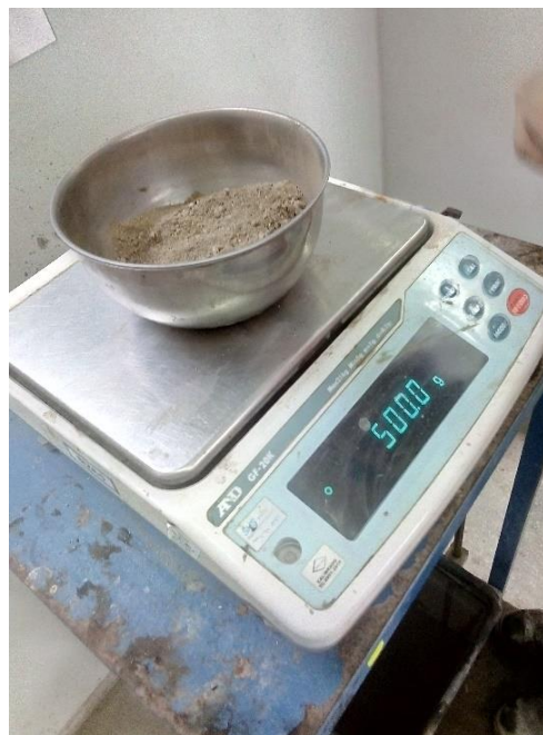
Figura N°16. Se pesó la arena hasta obtener 500g que es la cantidad que se necesita para hacer el peso específico.
