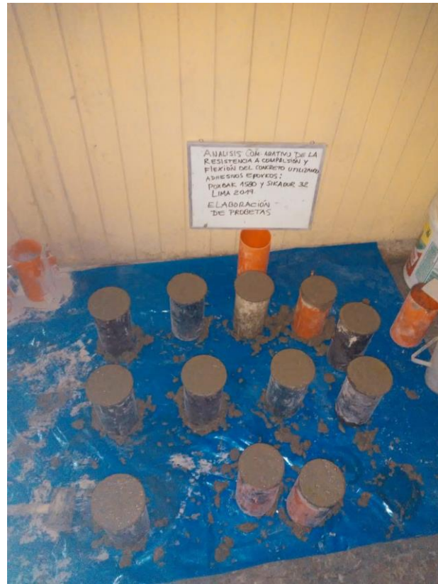
Figura N°54. Probetas cilíndricas que fueron posteriormente cortadas a 45°
