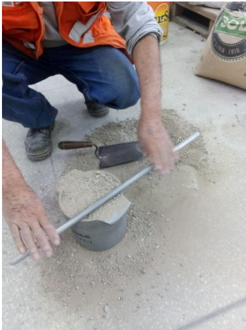
Figura N°29. Rellenado del agregado fino al recipiente para obtener el peso suelto de la muestra + recipiente
