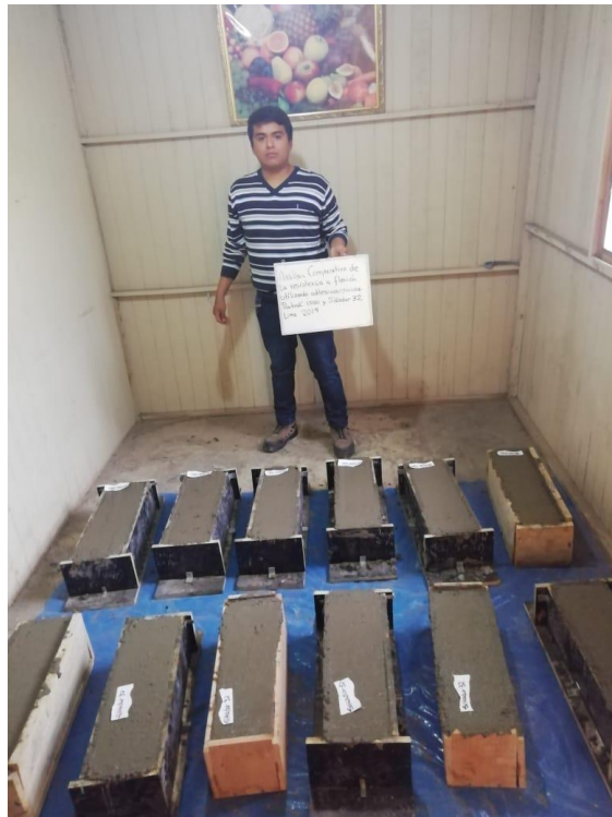
Figura N°51. Total de vigas aplicadas con el adhesivo poxbak 1580 y Sikadur 32
