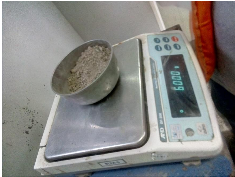
Figura N°24. Peso del agregado fino para la granulometría 600g
