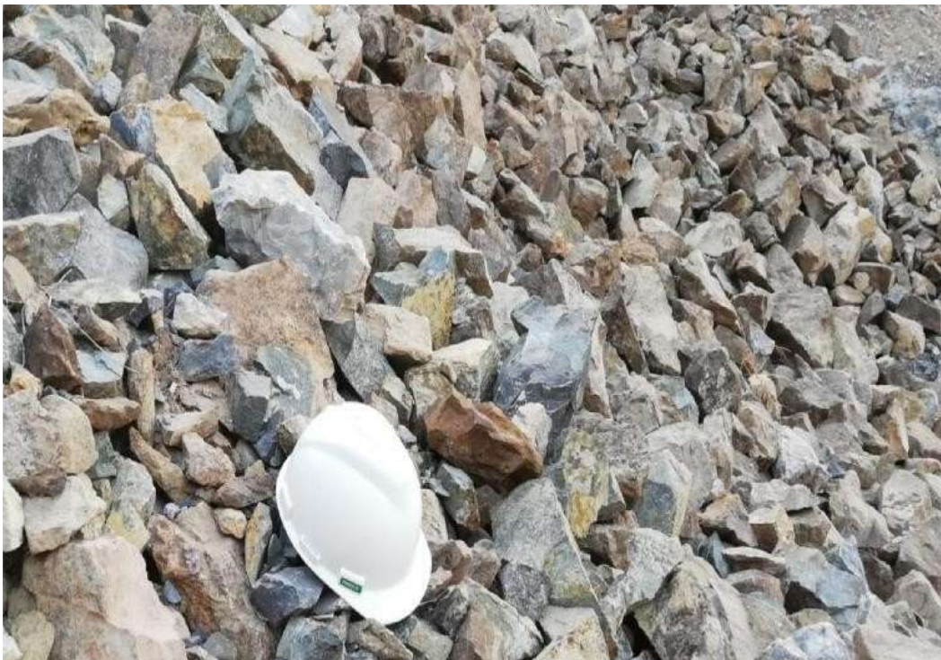
Ilustración 21: Voladura por el sistema pirotécnico aplicado por los testistas
