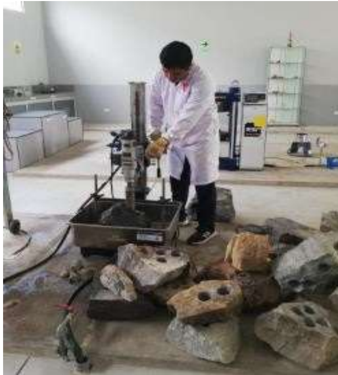
Ilustración 7: Extracción de testigos de las muestras.
