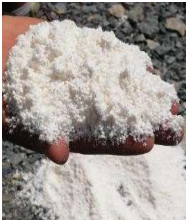
Ilustración 15: Anfo en la zona de aplicación
