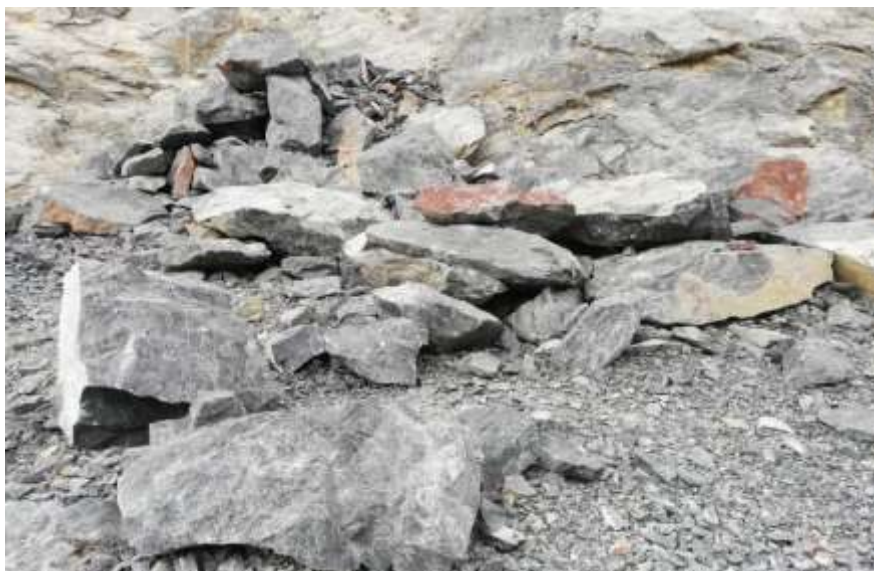
Ilustración 17: Resultado de la voladura de la cantera PROVEN III.
