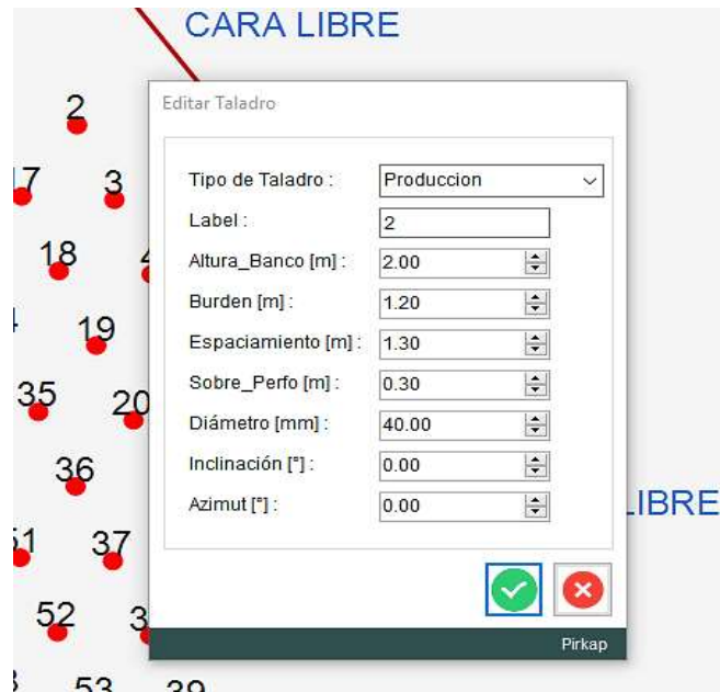
Figura N° 44: Carga de taladros.
