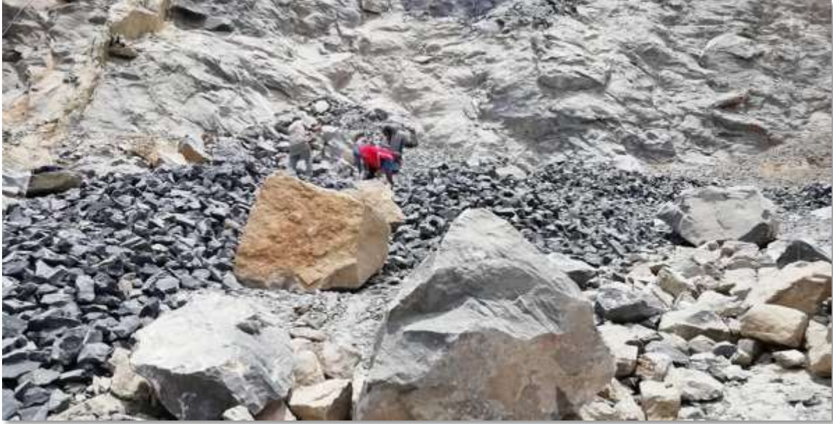
Ilustración 26: Fragmentación inadecuada y chancado manual de la roca caliza
