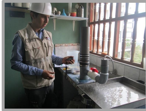
Figura 2. Ensayo de permeabilidad empleando un permeámetro de carga variable construido según recomendaciones de la ACI 522R-10.
