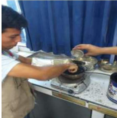
FOTO N° 6: INCORPORACIÓN DE CAUCHO A MEZCLA MODIFICADA
