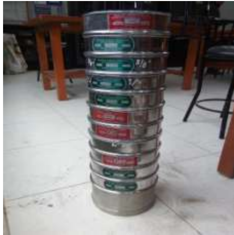
FOTO N° 1: ENSAYO DE GRANULOMETRÍA
