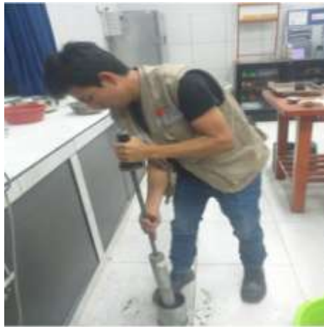
FOTO N° 7: COMPACTACIÓN DE BRIQUETAS
