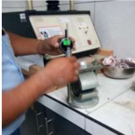
FOTO N° 9: COLOCACIÓN DE BRIQUETAS EN EL APARATO MARSHALL
