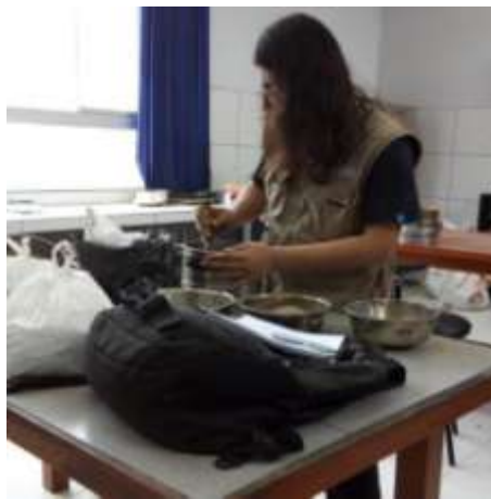
FOTO N° 4: TAMIZADO DE FILLER POR MALLA N° 200
