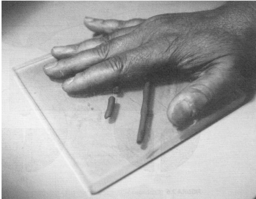
Ilustración 8 Ensayo de Limite Plástico
