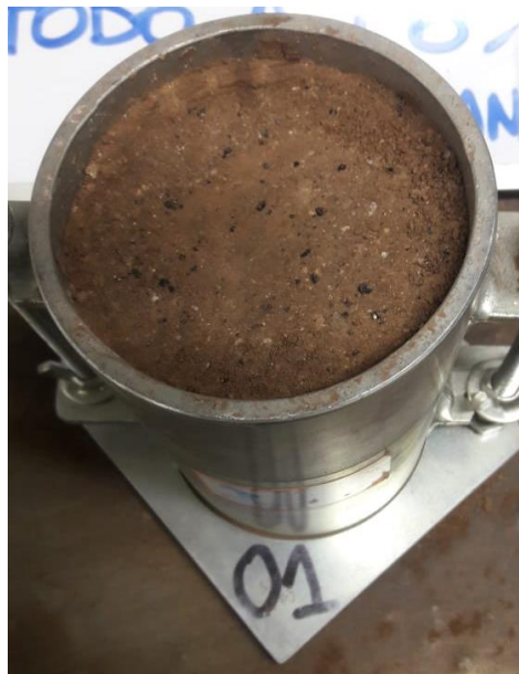
Ilustración 30 Molde de Proctor con la Mezcla
