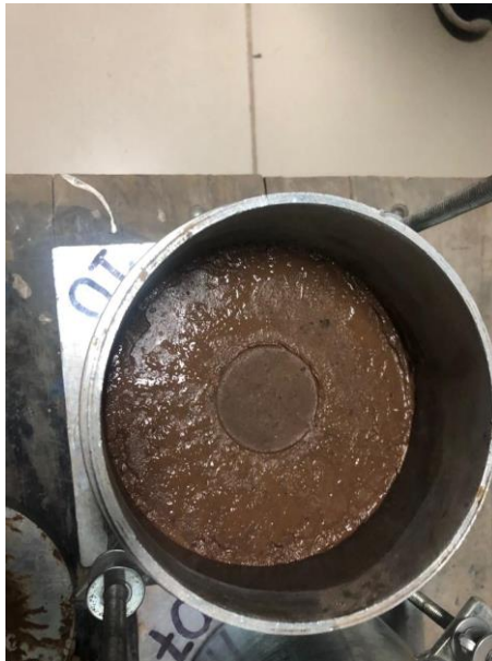
Ilustración 35 Huella de la penetración del Molde CBR
