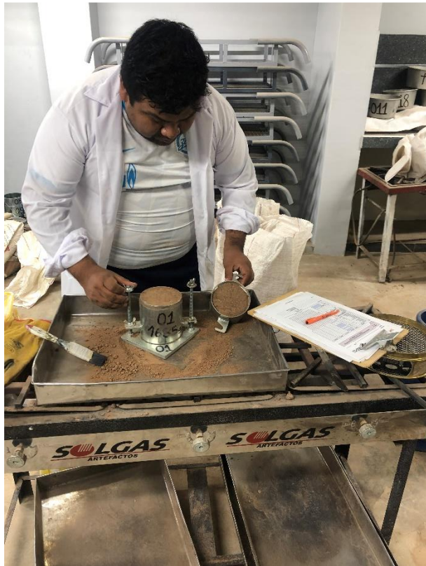
Ilustración 28 Retirando el Molde del Proctor
