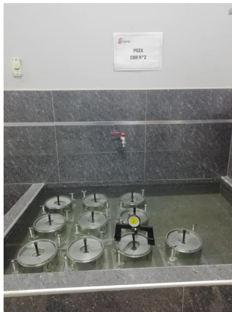
Ilustración 33 Moldes CBR sumergidos por 96 horas y medición de la expansión
