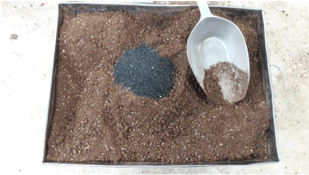
Ilustración 29 Mezcla para Proctor
