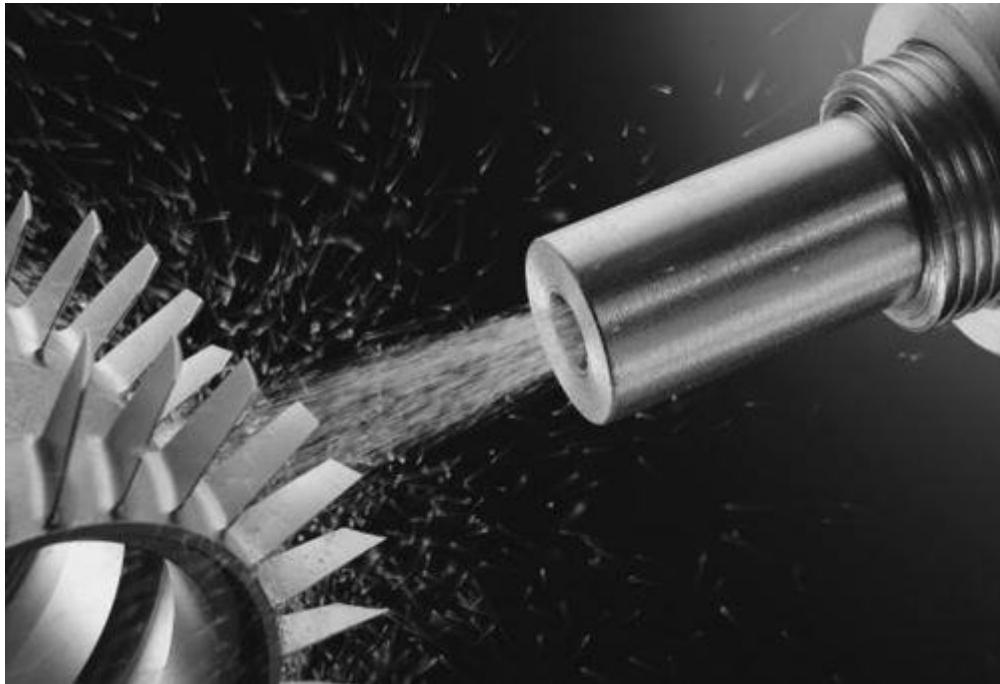
Ilustración 16 Utilización de la Granalla Mineral
