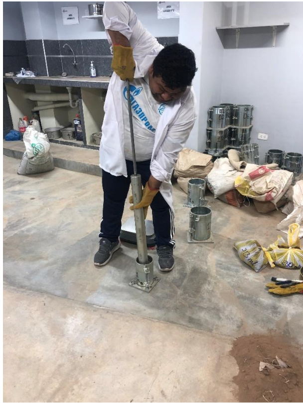
Ilustración 27 Ensayo de Proctor
