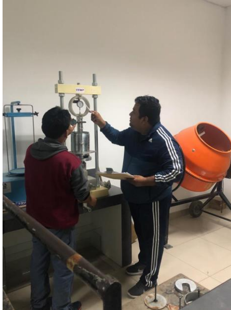
Ilustración 34 Penetrando el molde en la prensa CBR
