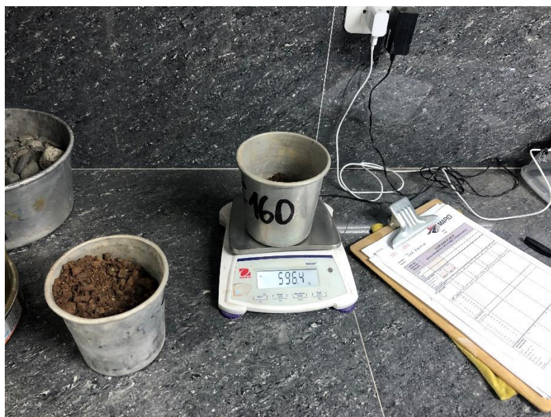
Ilustración 23 Peso de la muestra con humedad natural
