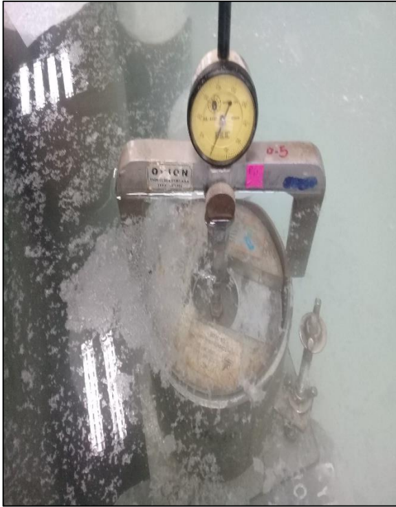
Gráfico 47. Ensayo CBR, medición de expansión.
