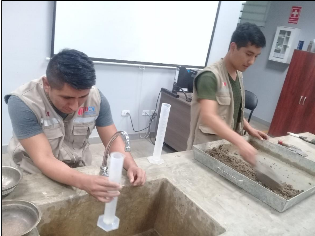
Gráfico 43. Preparación del porcentaje de humedad para el ensayo de CBR.
