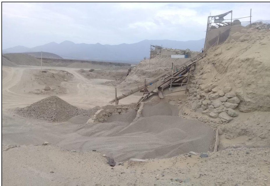
Gráfico 28. Máquina chancadora de piedra de 1/2" y 3/4".
