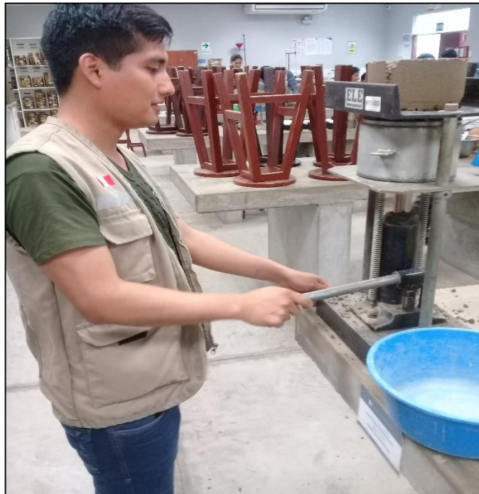
Gráfico 42. Extracción de corazón compactado del proctor.
