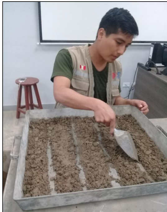
Gráfico 40. Mezcla y cuarteo del material incorporado con escoria para el proctor.
