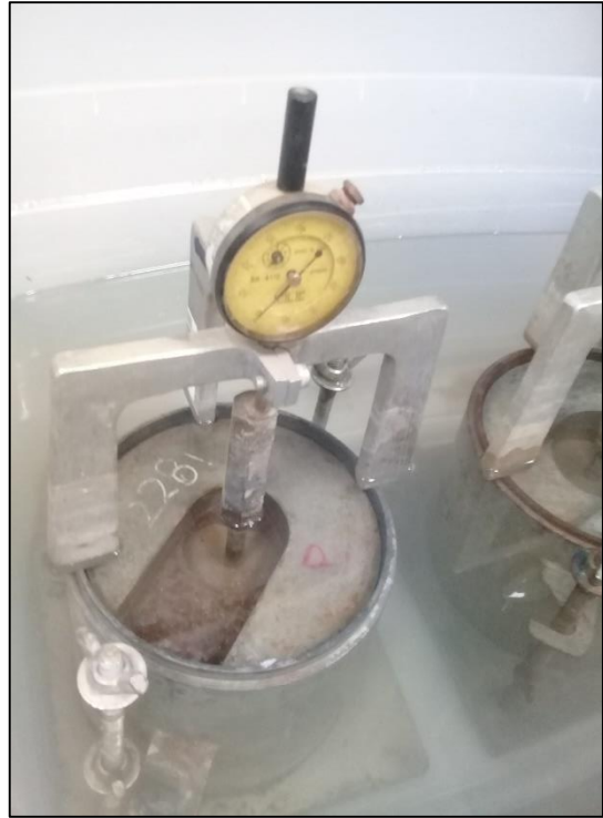
Gráfico 47. Ensayo CBR, medición de expansión.
