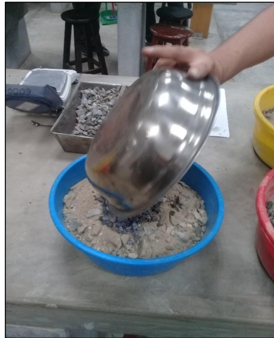
Gráfico 38. Incorporación de escoria de acero para los moldes del próctor.
