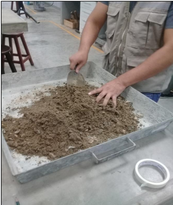
Gráfico 40. Mezcla y cuarteo del material incorporado con escoria para el proctor.
