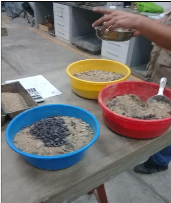
Gráfico 38. Incorporación de escoria de acero para los moldes del próctor.
