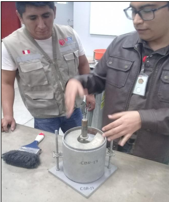
Gráfico 46. Preparación de los discos de carga y dial para sumergirlo en Agua.
