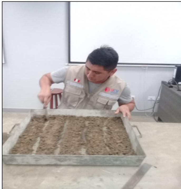
Gráfico 44. Cuarteo del material incorporado con escoria de acero para el ensayo del CBR.
