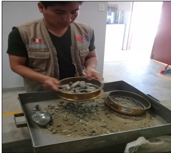
Gráfico 36. Tamizando el agregado de base granular por la malla 3/4.
