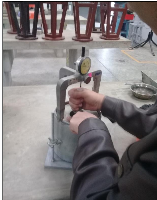
Gráfico 46. Preparación de los discos de carga y dial para sumergirlo en Agua.
