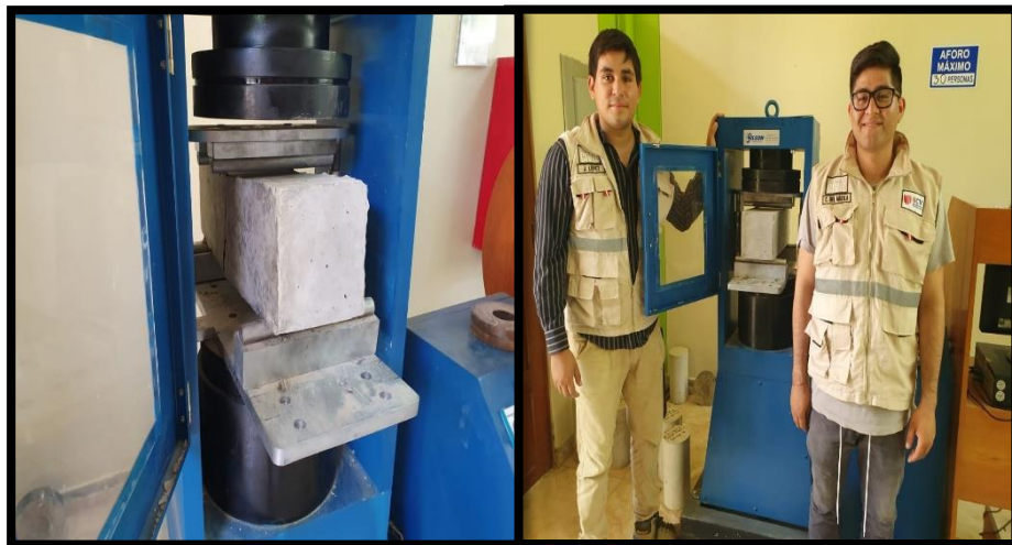
Fotografía 24. Rotura de vigas “Prueba de flexión”
