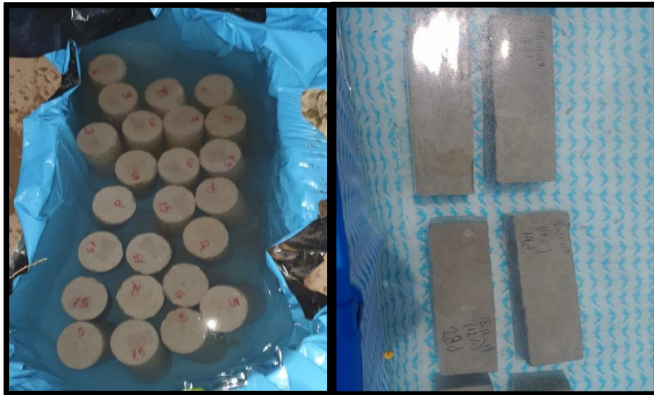
Fotografía 21. Curado de probetas cilíndricas y vigas
