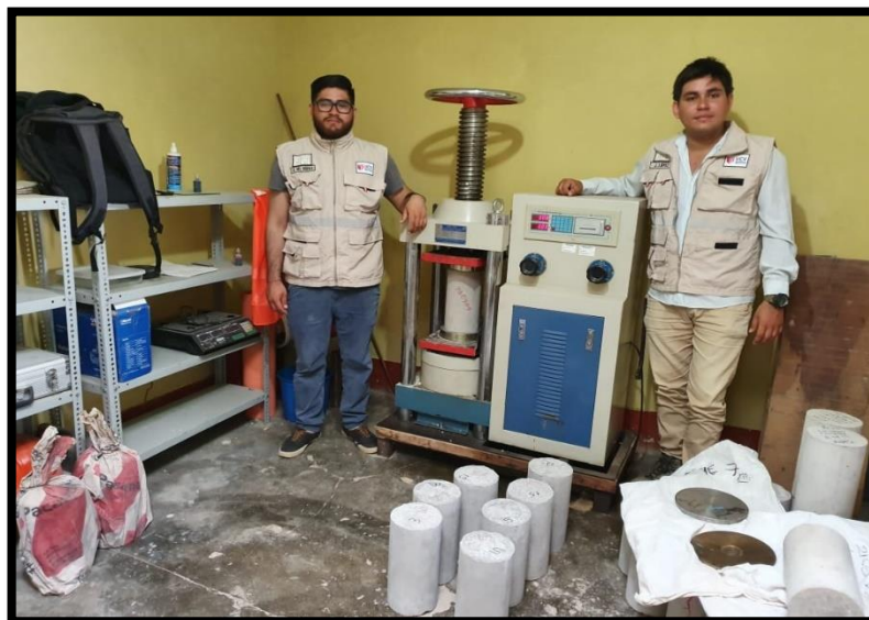
Fotografía 22. Rotura de probetas cilíndricas “compresión”
