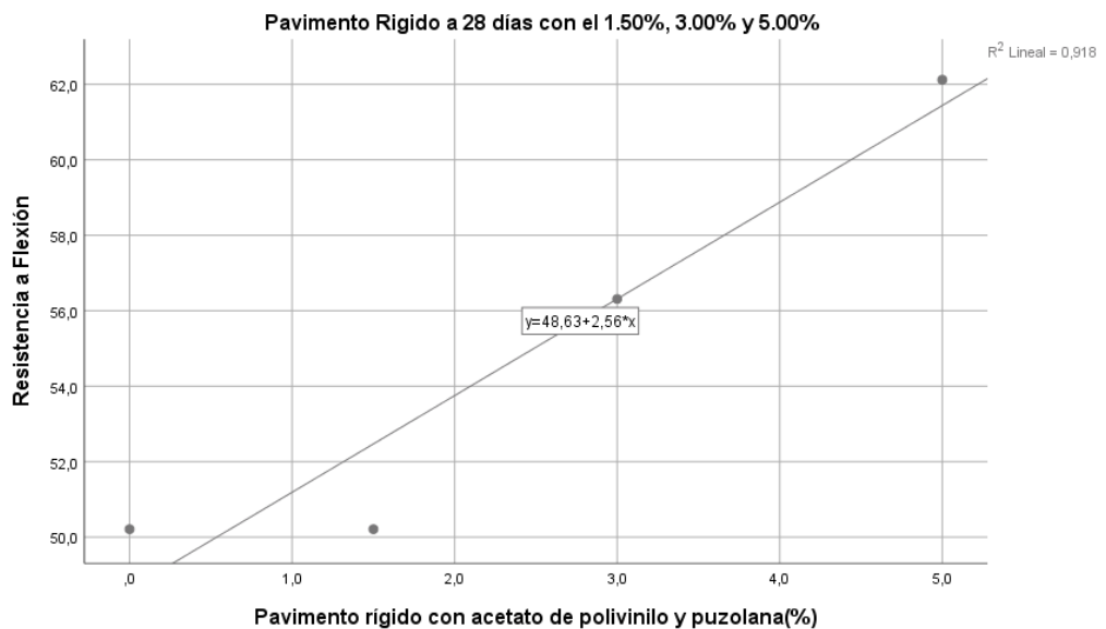
Figura 2. Regresión lineal. Ensayo a Flexión
