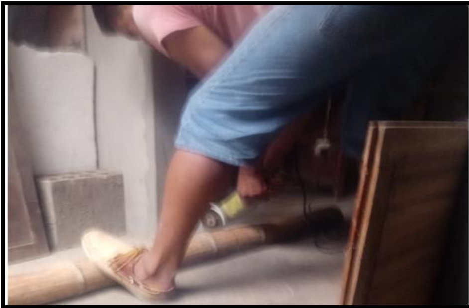
Figura 42: Corte de bambú con cierra eléctrica Fuente: Propia
