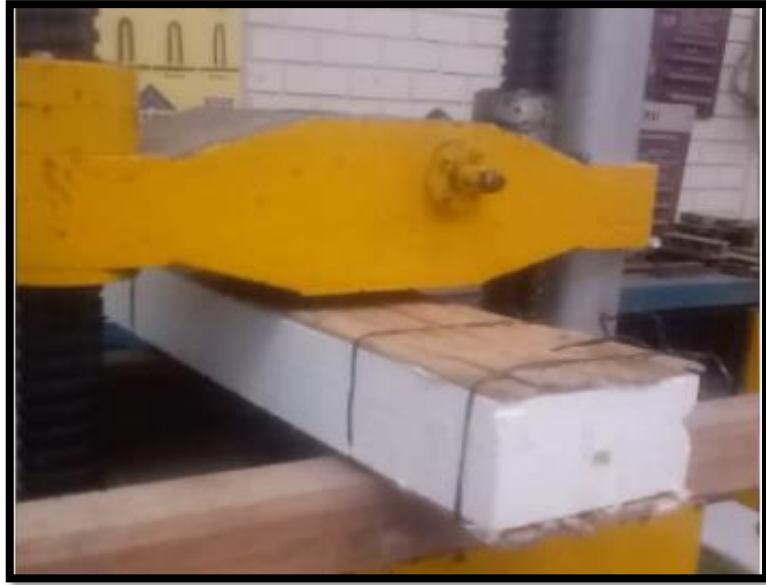
Figura 47: Ensayo de viga M1 a flexión, paso 2 Fuente: Propia
