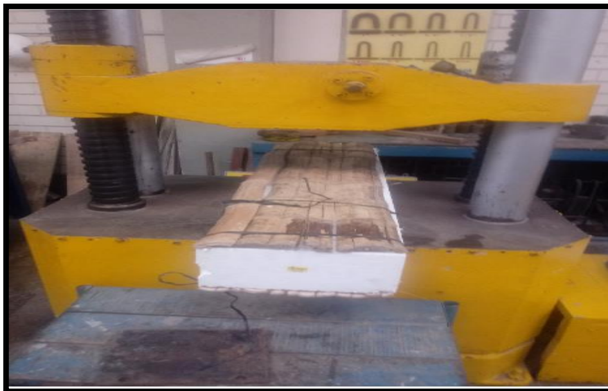
Figura 46: Ensayo de viga M1 a flexión, paso 1 Fuente: Propia
