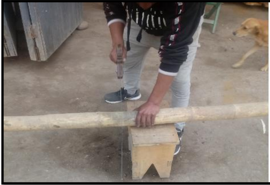
Figura 41: Corte de bambú con cierra manual Fuente: Propia
