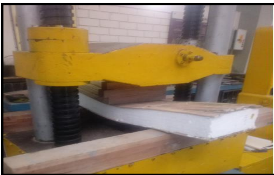
Figura 52: Ensayo a flexión de viga M2, paso 2 Fuente: Propia
