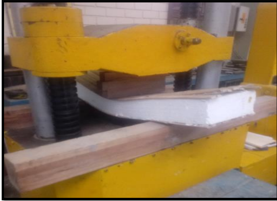
Figura 53: Ensayo a flexión de viga M2, paso 3 Fuente: Propia
