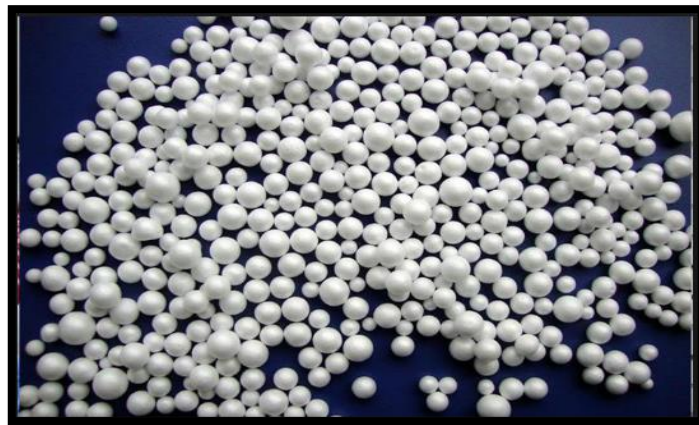
Figura 27: Estructura de Poliestireno Expandido.
