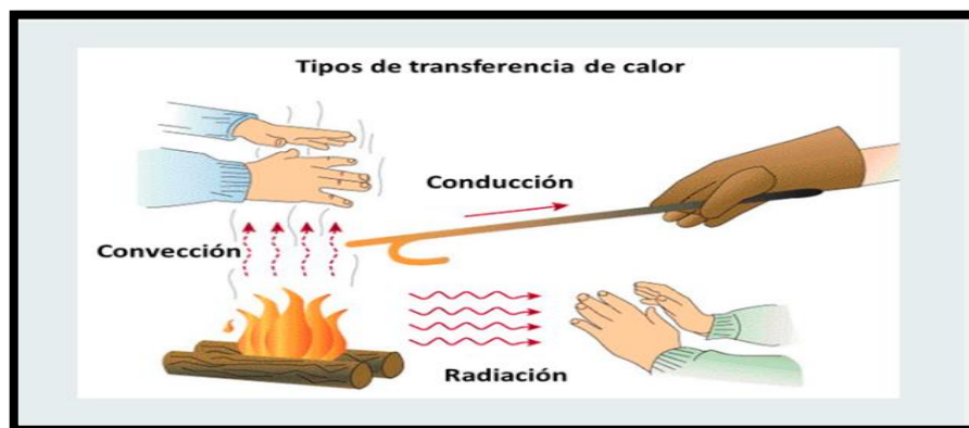
Figura 34: Tipos de transferencia de calor.
