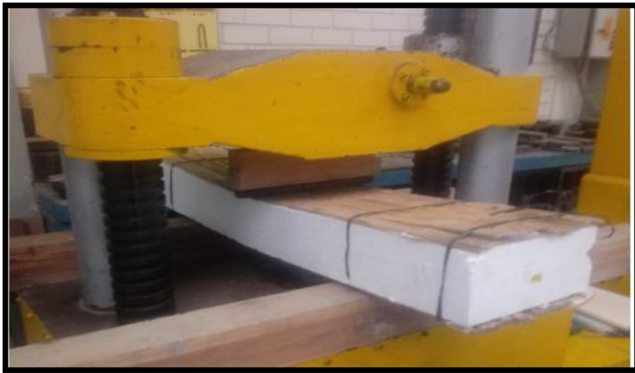
Figura 48: Ensayo de viga M1 a flexión, paso 3 Fuente: Propia
