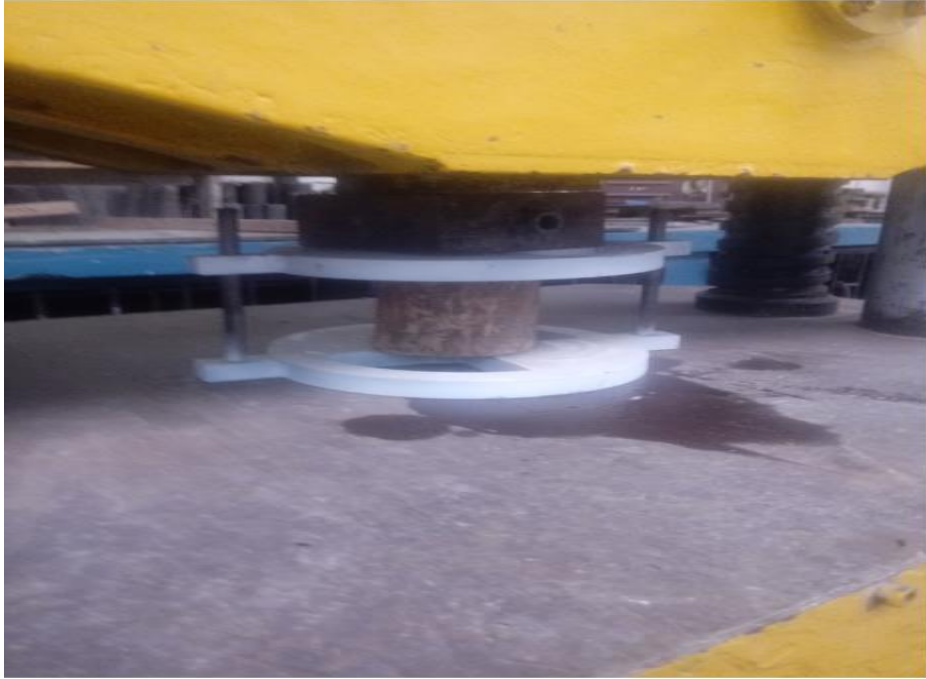
Figura 43: Probeta sometida a ensayo de corte Fuente: Propia
