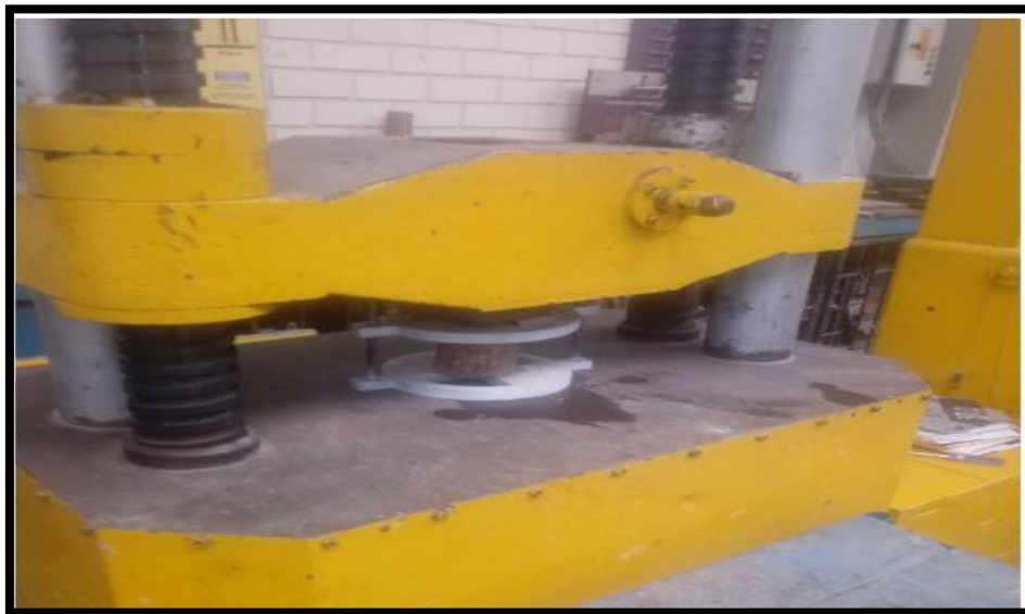
Figura 38: Ensayo de probeta a Cizallamiento Fuente: Propia
