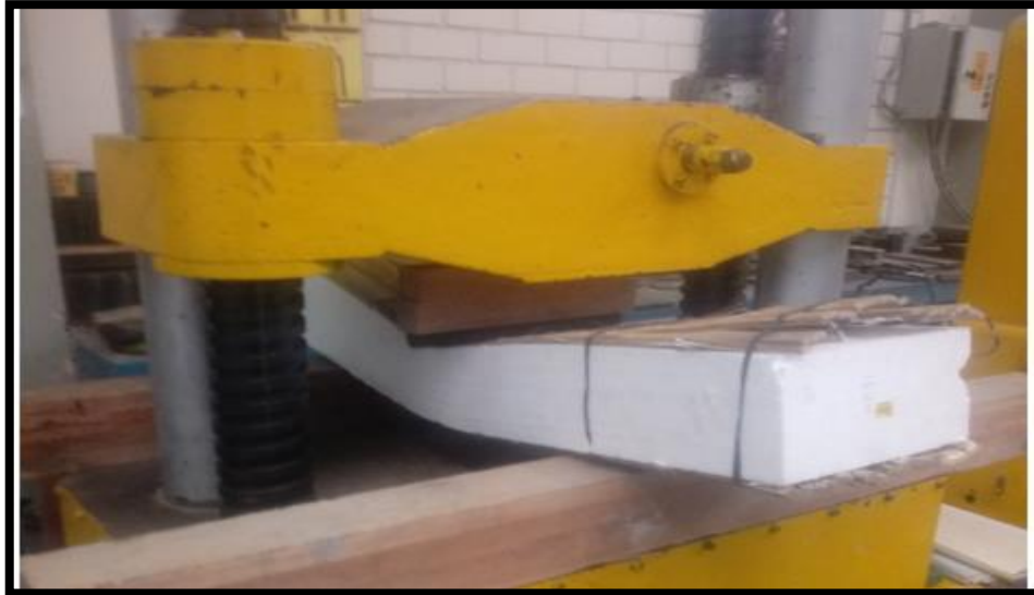
Figura 49: Ensayo de viga M1 a flexión, paso 4 Fuente: Propia
