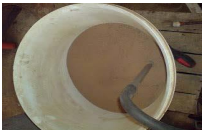
Figura 12: abrasivo usado en el arenado
