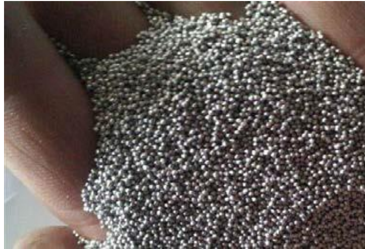
Figura 13: abrasivo usado en el granallado
