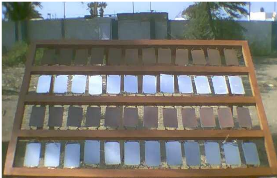
Figura 3: exposición atmosférica de probetas metálicas
