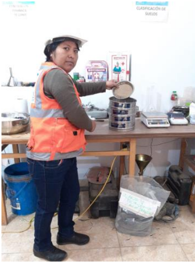
FOTO 1: Tamizando el agregado
