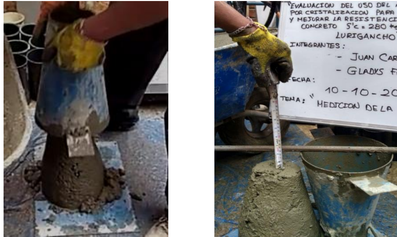
Figura 3.- Ensayo de asentamiento o Slump / Fuente: Elaboración propia, 2019.
