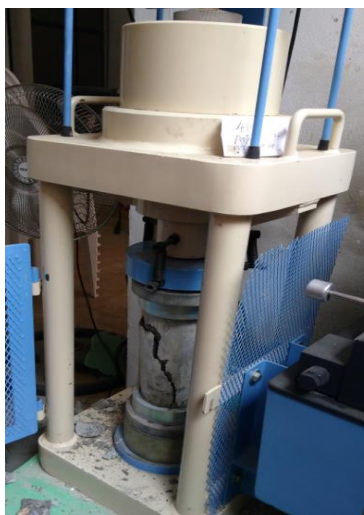
Figura 6: Prensa de ensayo de resistencia a la compresión. Fuente: Elaboración propia, 2019.
