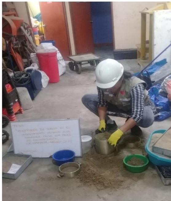
**Foto N° 18:** Realizando el ensayo de CBR de las calicatas seleccionadas del Asentamiento Humano José Sánchez Milla-Nuevo Chimbote.
