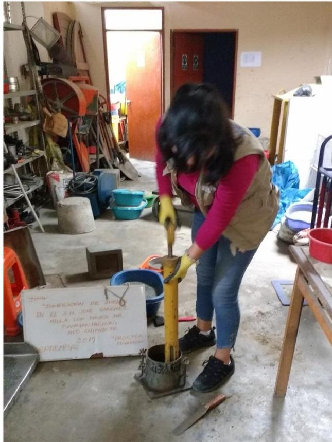
**Foto N° 17:** Realización del ensayo de Proctor Modificado de las calicatas seleccionadas para CBR en Asentamiento Humano José Sánchez Milla-Nuevo Chimbote.
