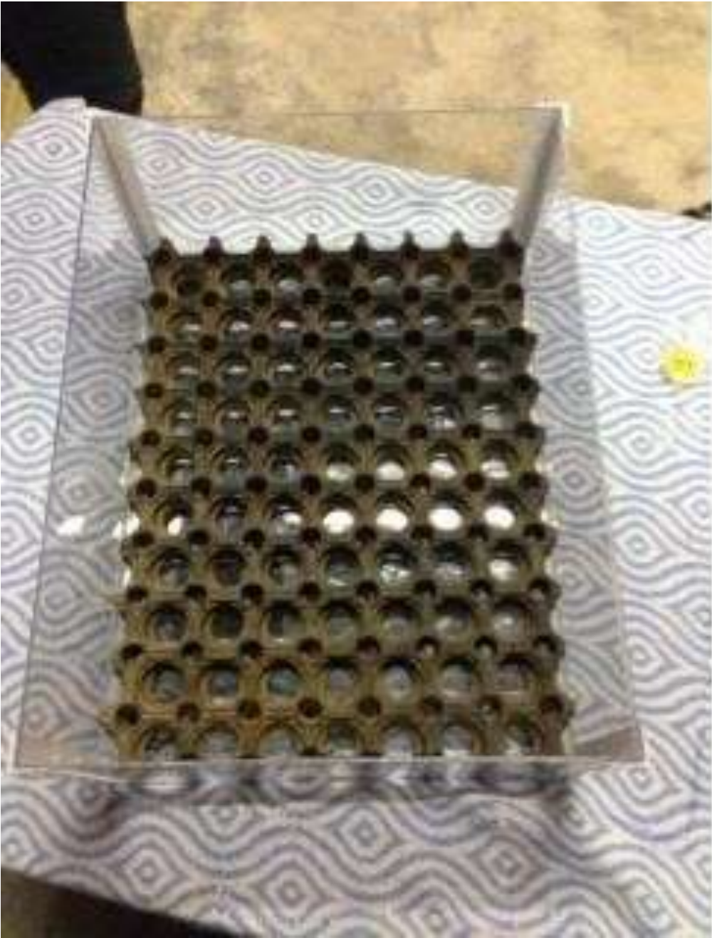
Figura N° 09. Goma vulcanizada, sirve como capa drenante para la azotea verde. Fuente: Revista SLT Caucho
