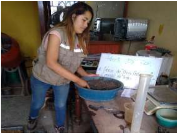
Elaboración del CBR más la adición de 5%, 10% y 15% de fibras y cenizas y saturación en agua de los moldes del CBR
