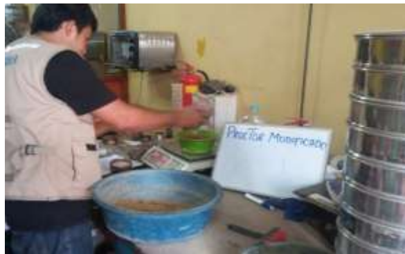
Preparación de la arena para el Proctor modificado
