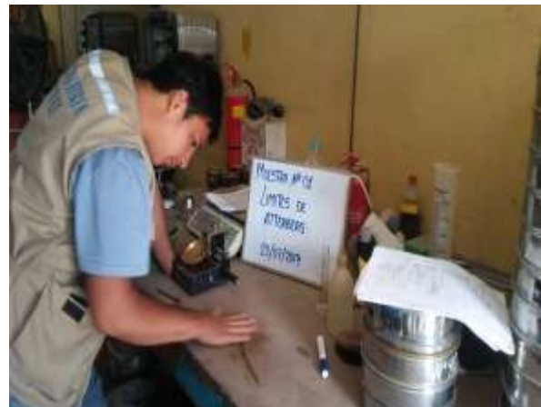
Elaboración de la muestra de los límites de Atterberg (límite líquido y plástico) en imágenes N° 15 y 16
