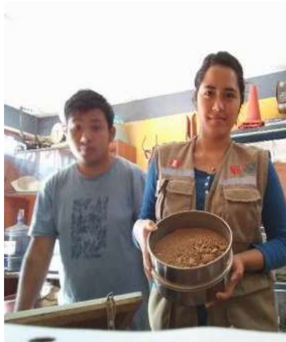
Tamizado de la muestra para los límites de Atterberg
