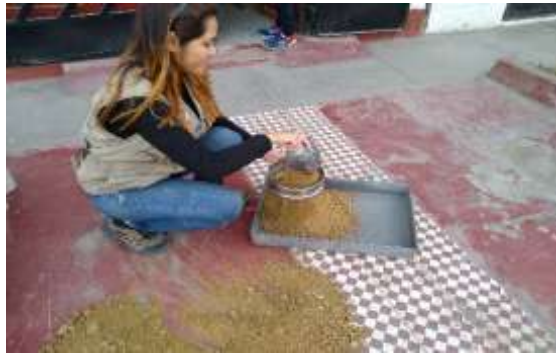
Preparación de la arena para elaborar el CBR y Proctor modificado
