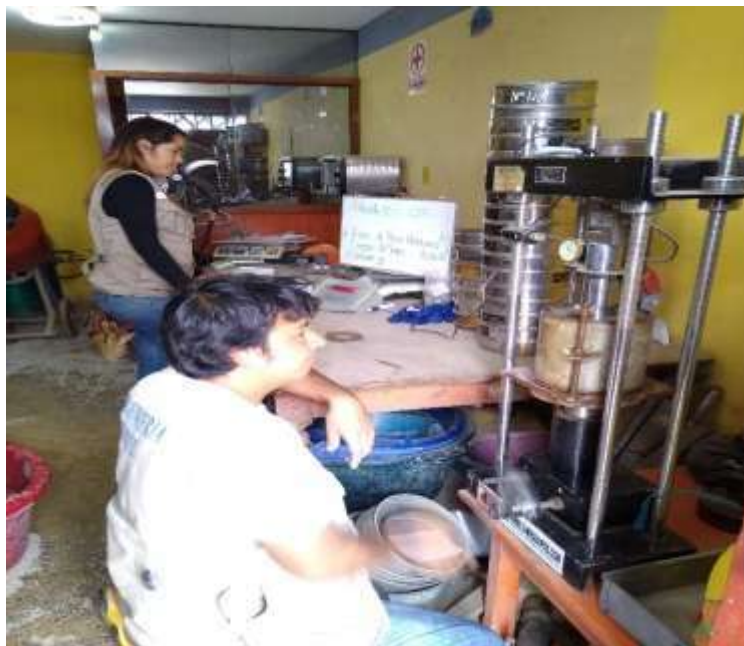
Lectura del CBR más la adición de 5%, 10% y 15% de fibras y cenizas
