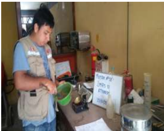
Elaboración de la muestra de los límites de Atterberg (límite líquido y plástico) en imágenes N° 15 y 16
