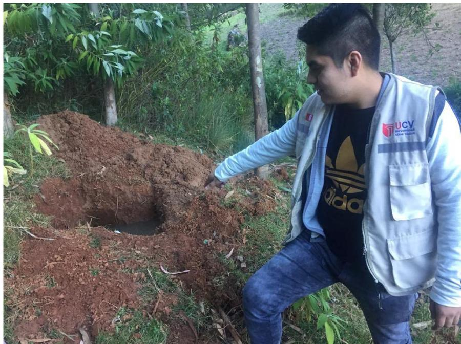
Obtención de muestras para el análisis de suelo, del costado de una casa, para la implementación de uds y para el recorrido del Sistema de agua, esta es la tercera calicata que desarrollamos, con el fin de obtener 5 kg de material para el análisis en laboratorio.
