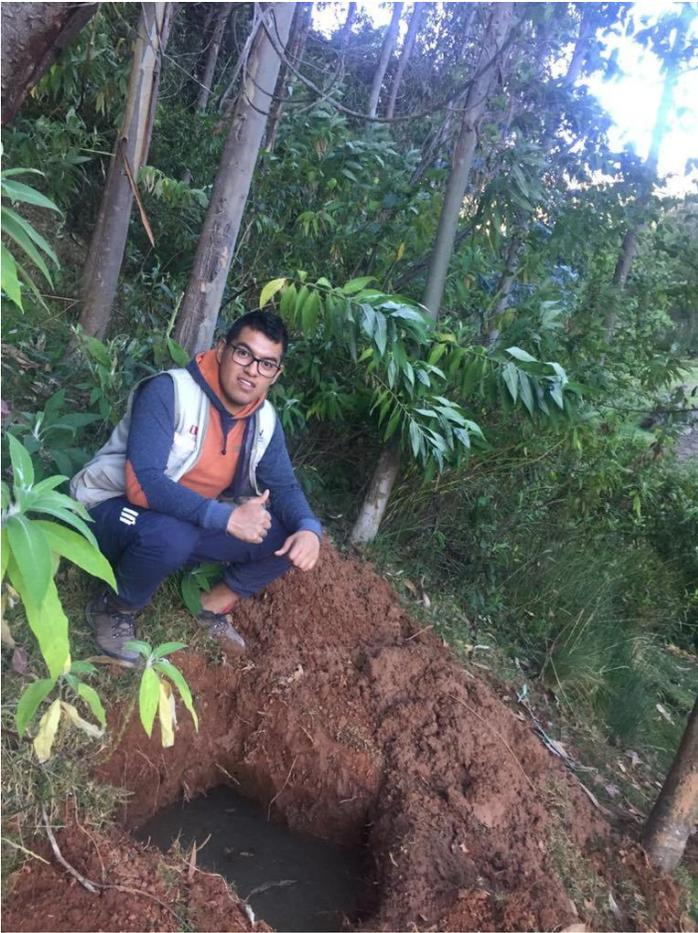
Obtención de muestras para el análisis de suelo, del Segundo punto de captación, esta es la segunda calicata que desarrollamos, con el fin de obtener 5 kg de material para el análisis en laboratorio.
