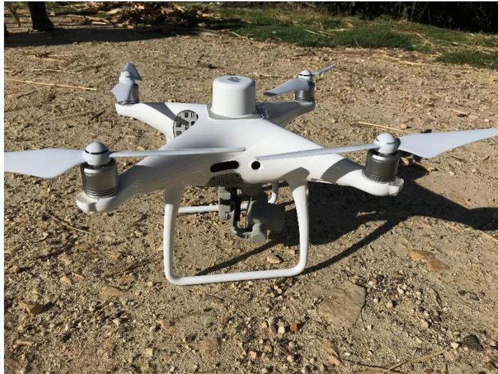
Levantamiento topográfico del sector las peñas *con la utilización del drone Phantom 4 pro RTK*
