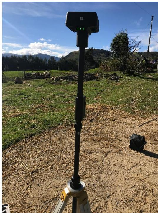
*ESTACION MOVIL 2RTK GNSS, que permite que el drone obtenga las coordenadas y pueda desarrollar el levantamiento topográfico de todo el sector en estudio.*
