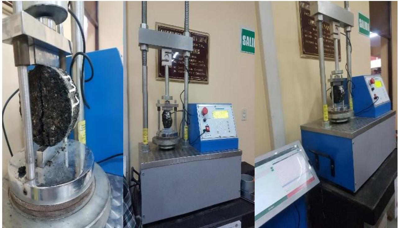
Ensayo de tracción indirecta de las muestras sacadas IN SITU.
