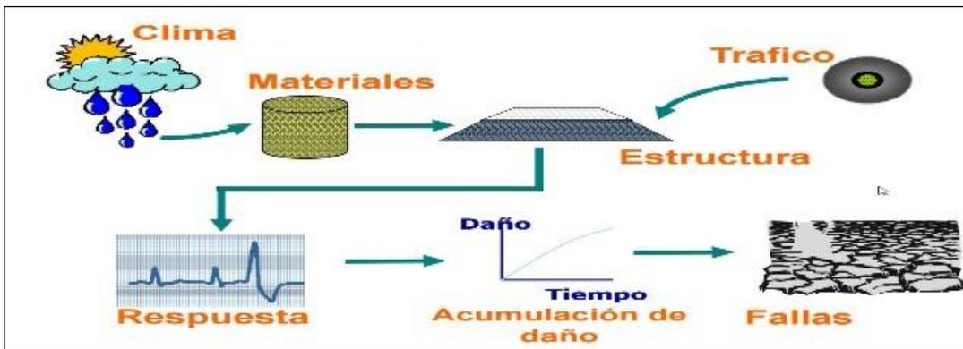
Figura 4: Esquema Funcionamiento método mecánico – empírico.
