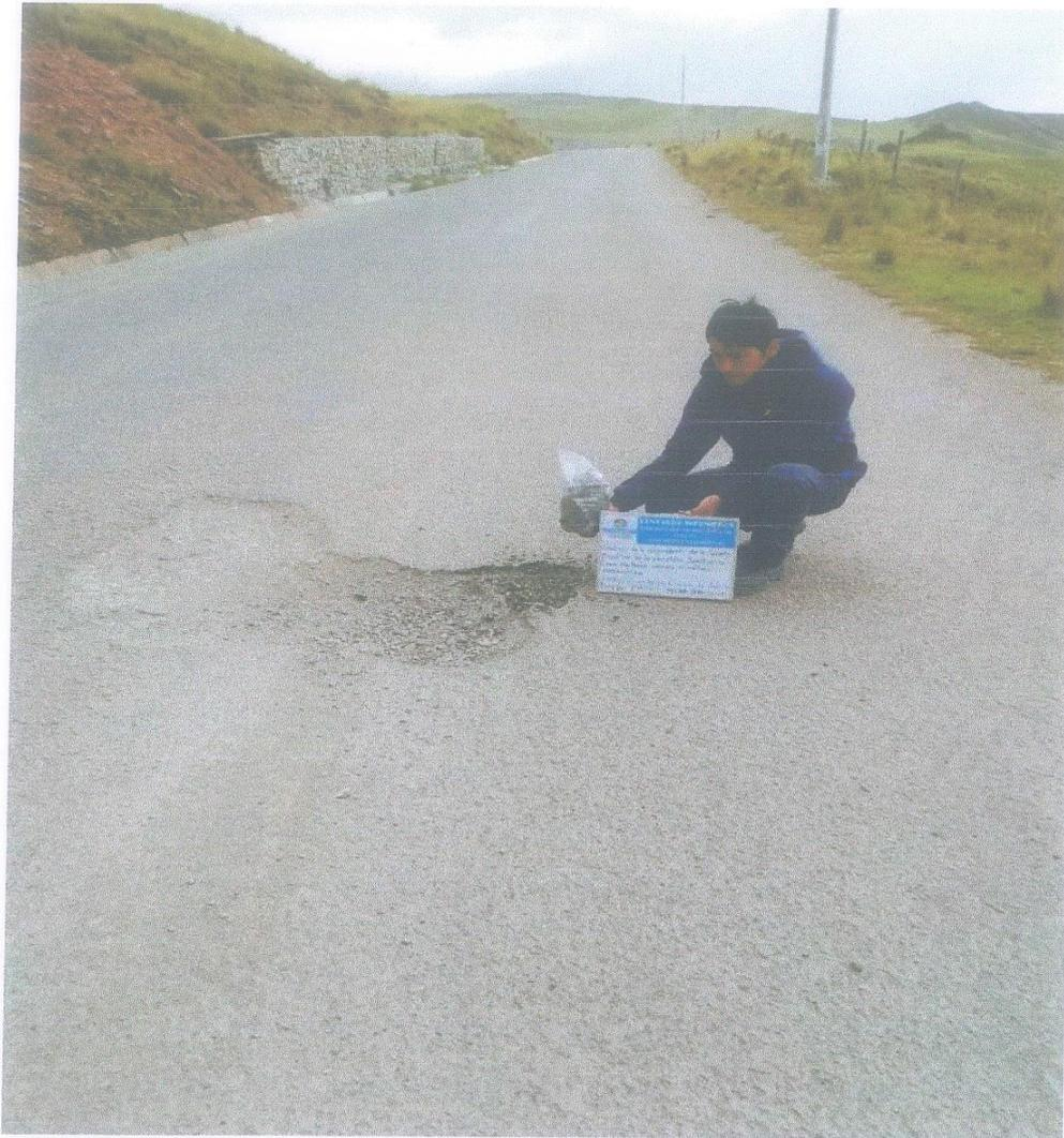
**FOTOGRAFÍA 11:** VISTA GENERAL DE LA OBTENCIÓN DE LA MUESTRA DE ASFALTO PARA EL PROYECTO "ANÁLISIS DE LA DEGRADACIÓN DE LA CARPETA ASFÁLTICA DE LA CARRETERA YANAHUANCA, CERRO DE PASCO, USANDO EL MÉTODO MECANISMO" / FOTOGRAFÍA REMITIDA POR EL LABORATORIO-
