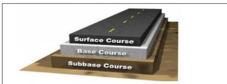
Figura 1: Estructura del pavimento flexible.
