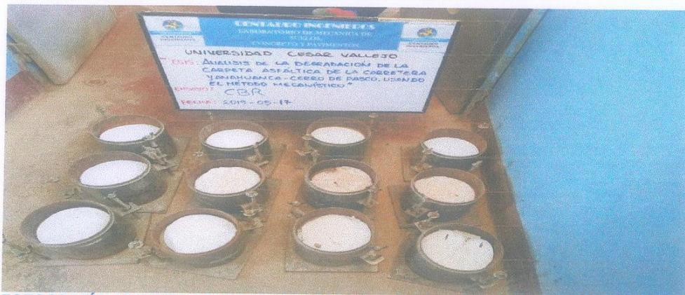
**FOTOGRAFÍA 13:** VISTA GENERAL DE MUESTRAS DE CBR PARA EL PROYECTO "ANÁLISIS DE LA DEGRADACIÓN DE LA CARPETA ASFÁLTICA DE LA CARRETERA YANAHUANCA, CERRO DE PASCO, USANDO EL MÉTODO MECANISMO" / FOTOGRAFÍA REMITIDA POR EL LABORATORIO.
