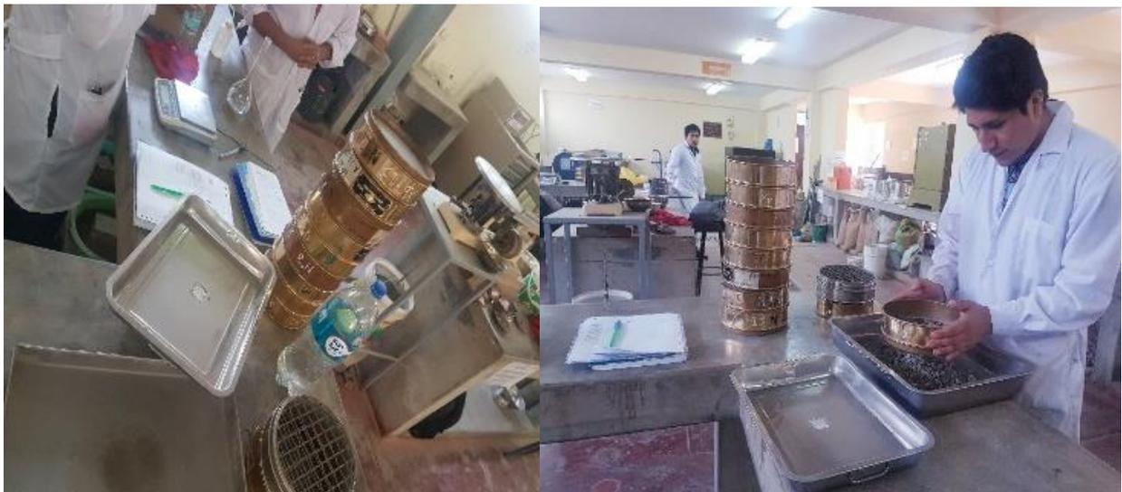
Ensayo granulométrico de las muestras (M1, M2, M3)
