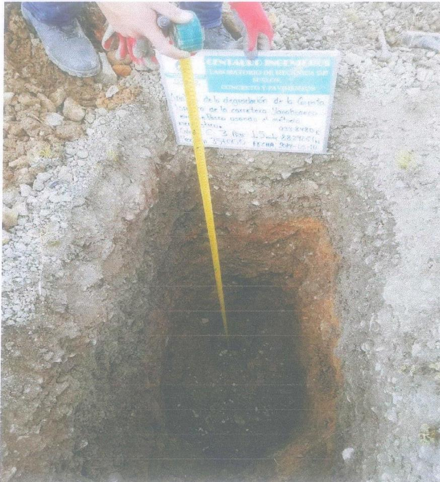
**FOTOGRAFÍA 5:** VISTA DE LA EXCAVACIÓN DE LA CALICATA C-3 DONDE SE EXTRAJO LA MUESTRA PARA LOS RESPECTIVOS ENSAYOS SOLICITADOS, PARA EL PROYECTO "ANÁLISIS DE LA DEGRADACIÓN DE LA CARPETA ASFÁLTICA DE LA CARRETERA YANAHUANCA, CERRO DE PASCO, USANDO EL MÉTODO MECANISMO" A UNA PROFUNDIDAD DE H=1.50M / FOTOGRAFÍA REMITIDA POR EL LABORATORIO.
