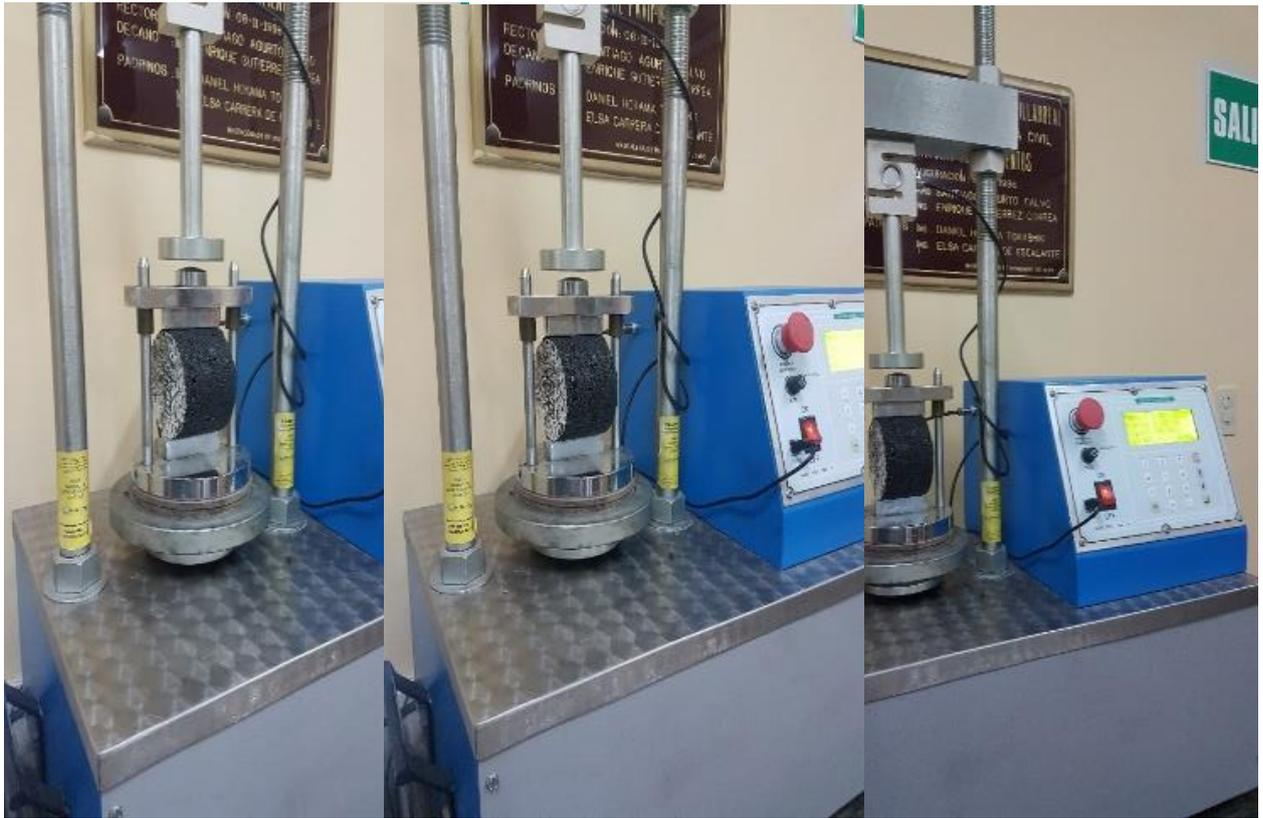
Ensayo de tracción indirecta de muestras reconstruidas en laboratorio.
