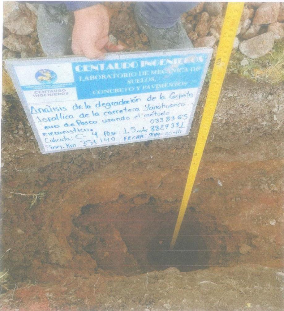
**FOTOGRAFÍA 7:** VISTA DE LA EXCAVACIÓN DE LA CALICATA C-4 DONDE SE EXTRAJO LA MUESTRA PARA LOS RESPECTIVOS ENSAYOS SOLICITADOS, PARA EL PROYECTO "ANÁLISIS DE LA DEGRADACIÓN DE LA CARPETA ASFÁLTICA DE LA CARRETERA YANAHUANCA, CERRO DE PASCO, USANDO EL MÉTODO MECANISMO" A UNA PROFUNDIDAD DE  $H=1.50M$  / FOTOGRAFÍA REMITIDA POR EL LABORATORIO.
