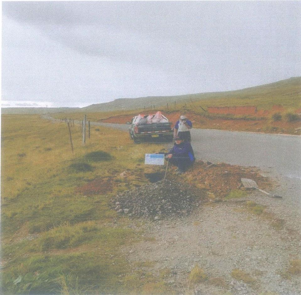
**FOTOGRAFÍA 6:** VISTA DE LA EXCAVACIÓN DE LA CALICATA C-4 DONDE SE EXTRAJO LA MUESTRA PARA LOS RESPECTIVOS ENSAYOS SOLICITADOS, PARA EL PROYECTO "ANÁLISIS DE LA DEGRADACIÓN DE LA CARPETA ASFÁLTICA DE LA CARRETERA YANAHUANCA, CERRO DE PASCO, USANDO EL MÉTODO MECANISMO" A UNA PROFUNDIDAD DE H=1.50M / FOTOGRAFÍA REMITIDA POR EL LABORATORIO
