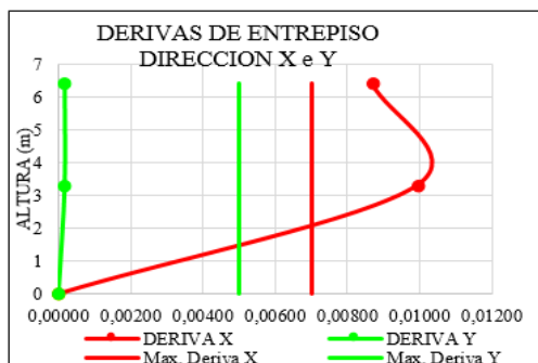
Figura 55. Deriva de entrepiso sin reforzar Fuente: elaboración Propia
