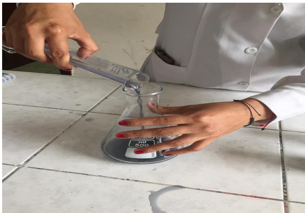
Imagen N° 04: Agregar 10 ml de ácido sulfúrico y ácido perclórico, luego llevar a digerir.
