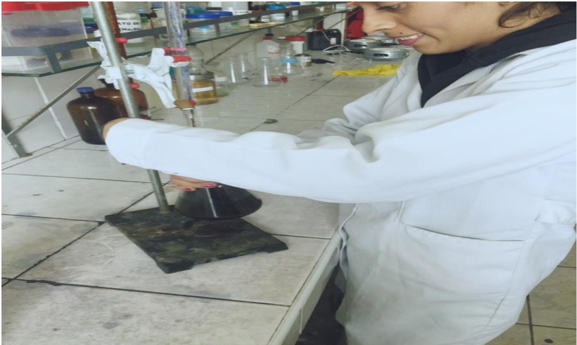
Imagen N° 09: Titular con Tiosulfato de sodio 0.1N hasta que cambie de color
