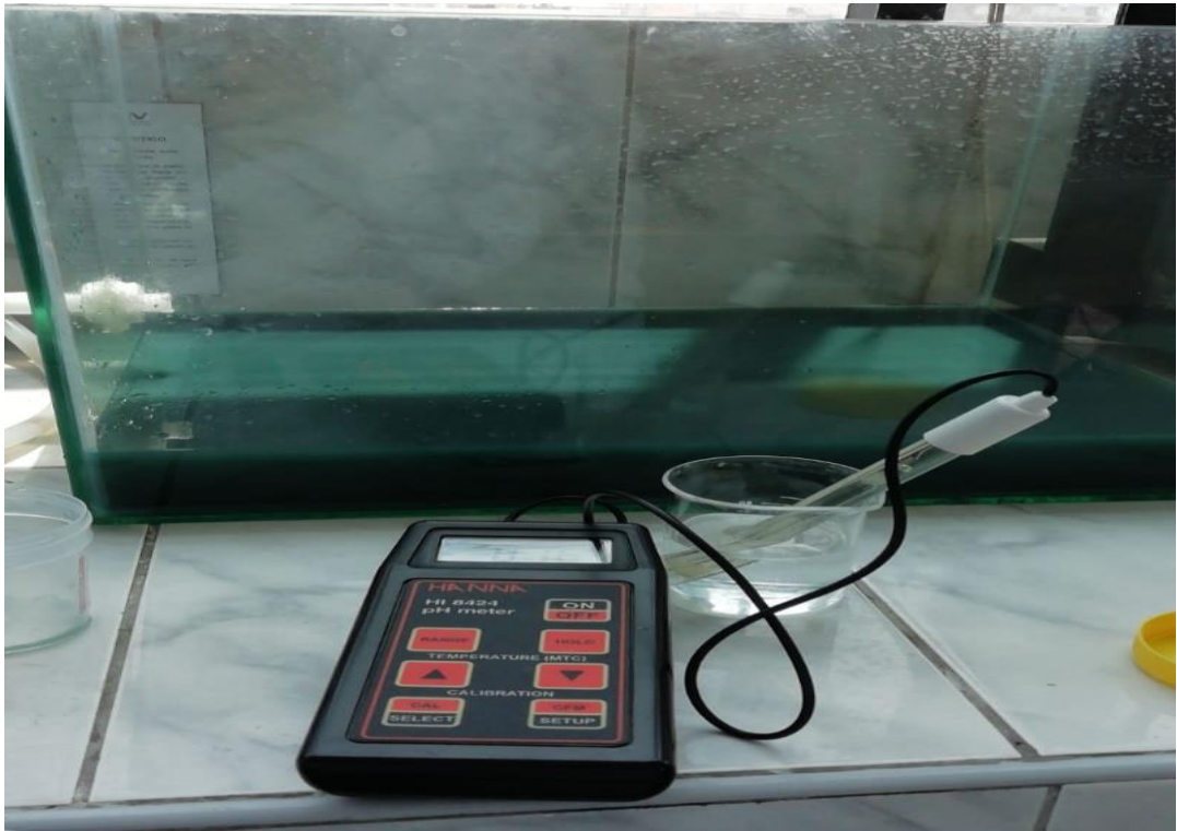
Imagen N° 11: Regulando el pH, agregar Hidróxido de sodio hasta llegar a 9 \pm 0.2 .
