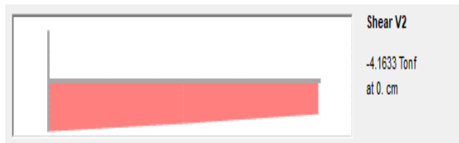
Figura (68) Fuerza cortante transversal de la rampa acceso semisótano.
