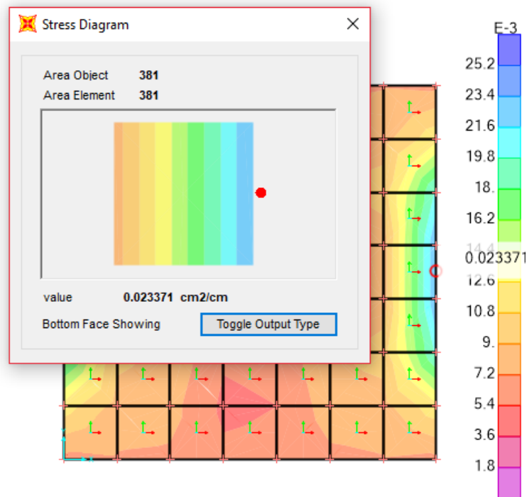
Figura (72) Requerimiento de acero cara inferior del tanque en SAP2000 Fuente: Elaboración propia
