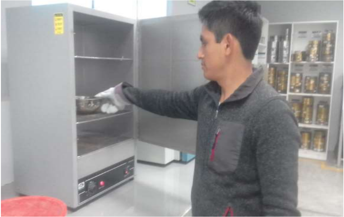
Figura 41. Colocación del agregado fino al horno para el secado.
