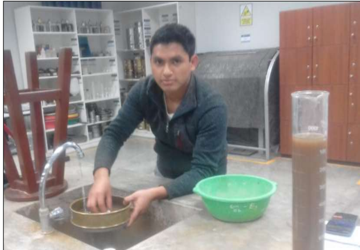
Figura 16. Lavado del material fino retenido en la malla N° 200.
