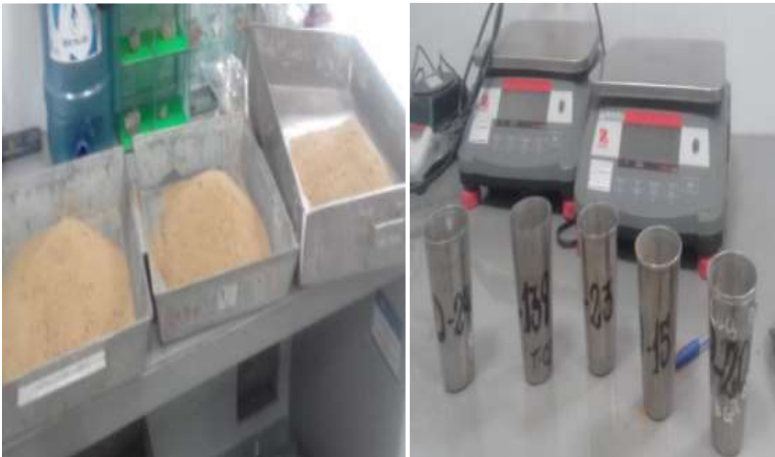
Figura 44. Muestras del ensayo de CBR de la muestra patrón.
