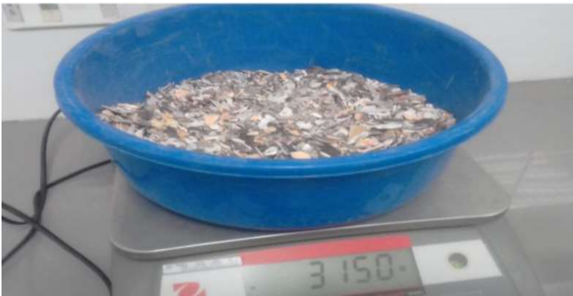
Figura 48. Ensayo de Granulometría de las conchas de abanico.
