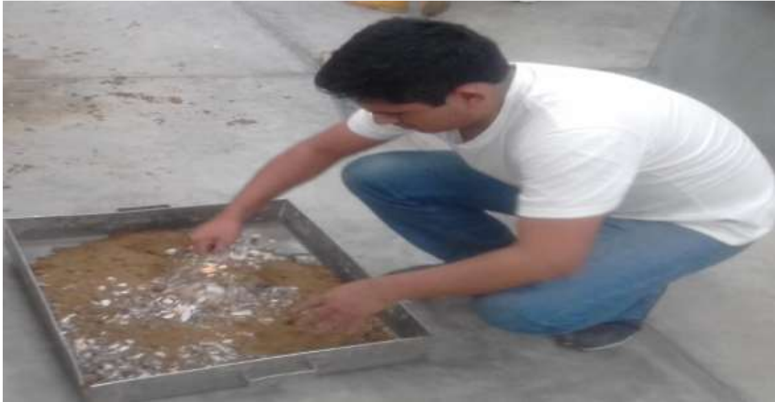
Figura 49. Mezcla del agregado fino con las conchas de abanico.
