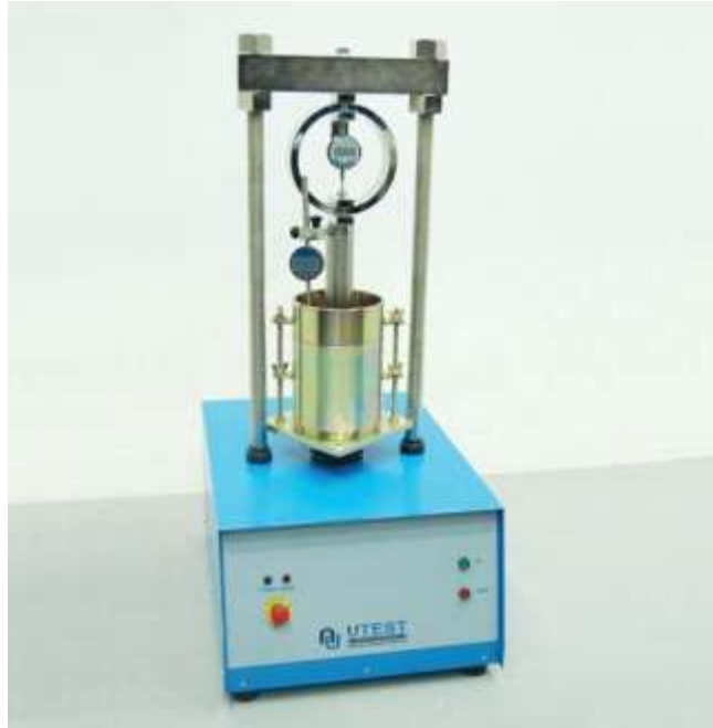
Figura 6. Prensa hidráulica CBR.
