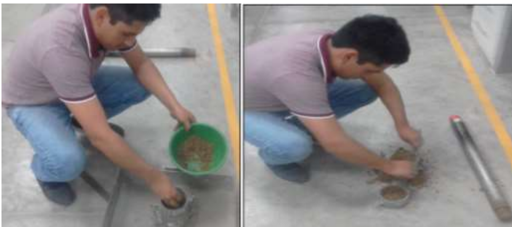
Figura 20. Ensayo Proctor modificado.
