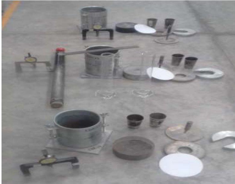
Figura 5. Equipos para realizar ensayo CBR.
