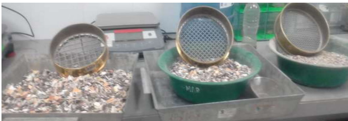
Figura 2. Valvas trituradas en dosificaciones para reemplazo de material.
