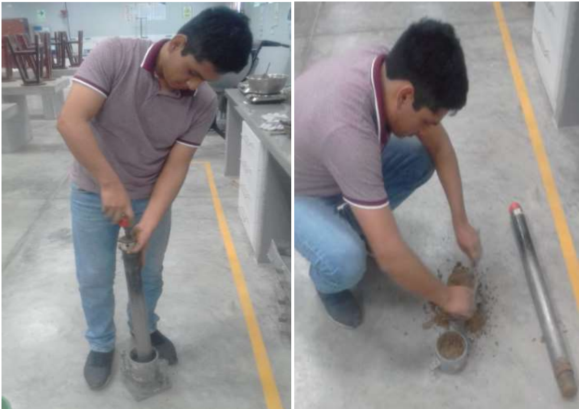
Figura 42. Ensayo de Proctor Modificado A de la muestra patrón.
