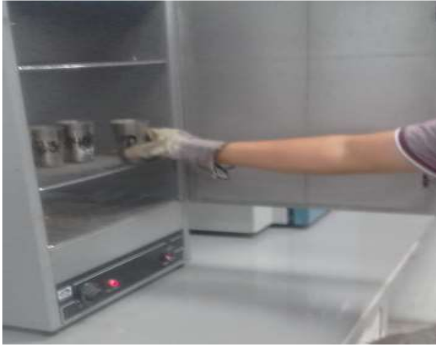
Figura 51. Secado de la muestra del ensayo de Proctor Modificado.
