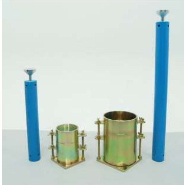
Figura 4. Equipos para realizar ensayo proctor.
