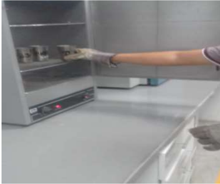
Figura 43. Secado de la muestra patrón.
