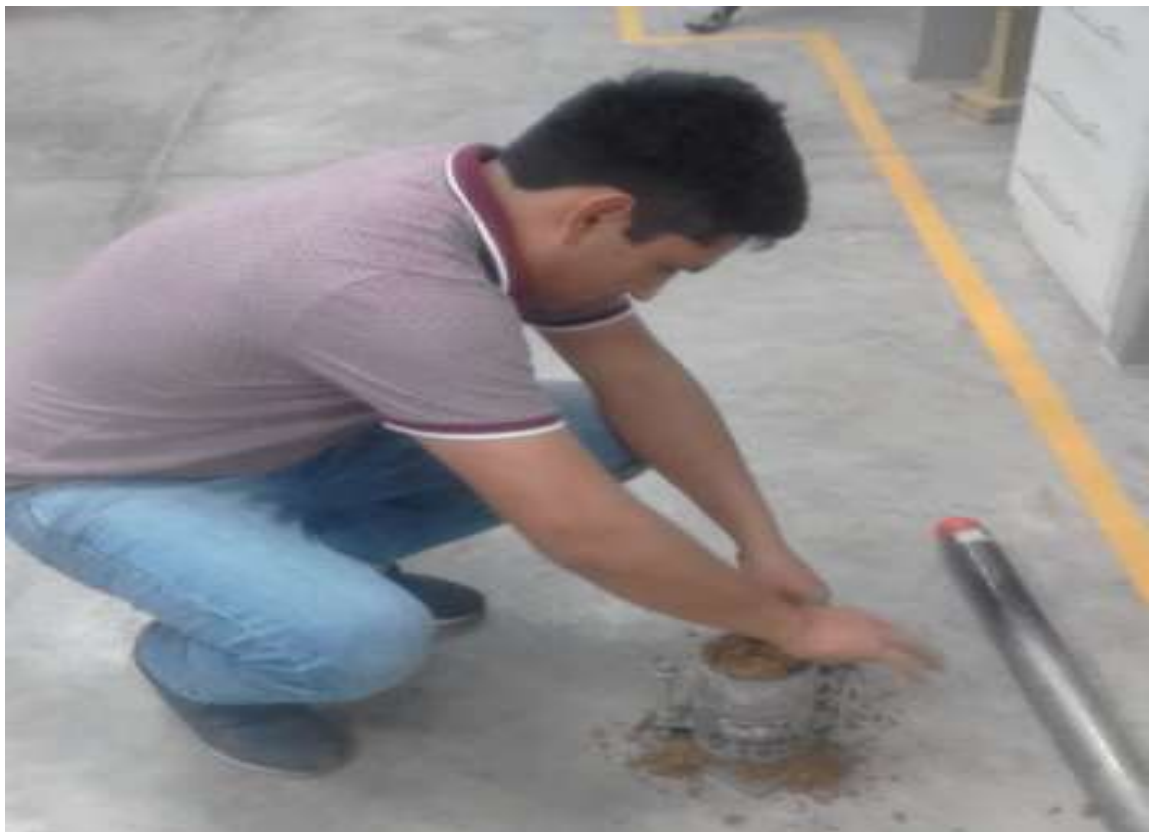
Figura 50: Ensayo de Proctor Modificado A con dosificaciones de conchas de abanico.
