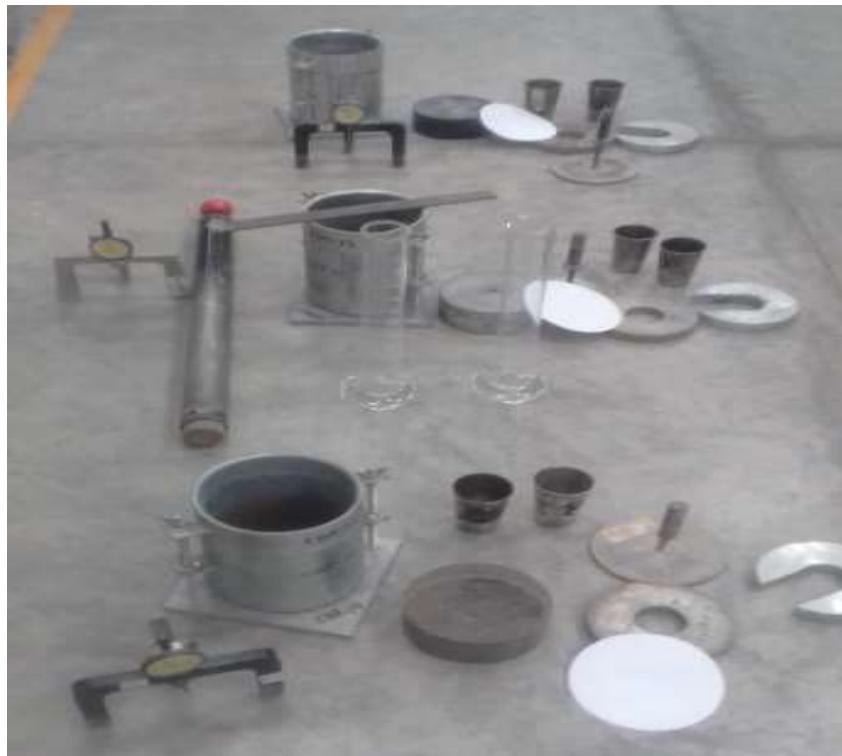
Figura 52. Equipos para el ensayo de CBR.
