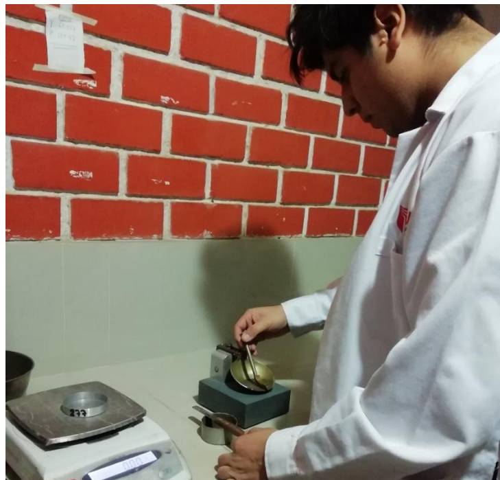
Figura 3.4. Ensayo de limite líquido y plástico
