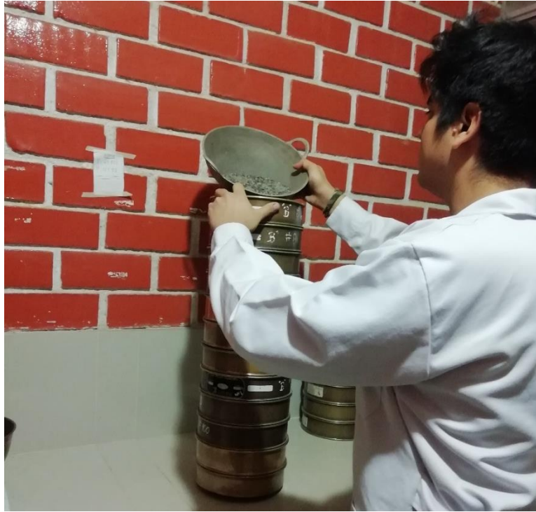
Figura 3.3. Ensayo de granulometría
