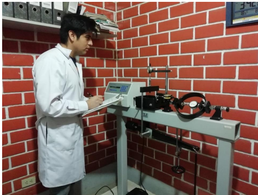
Figura 3.3. Ensayo de corte directo
