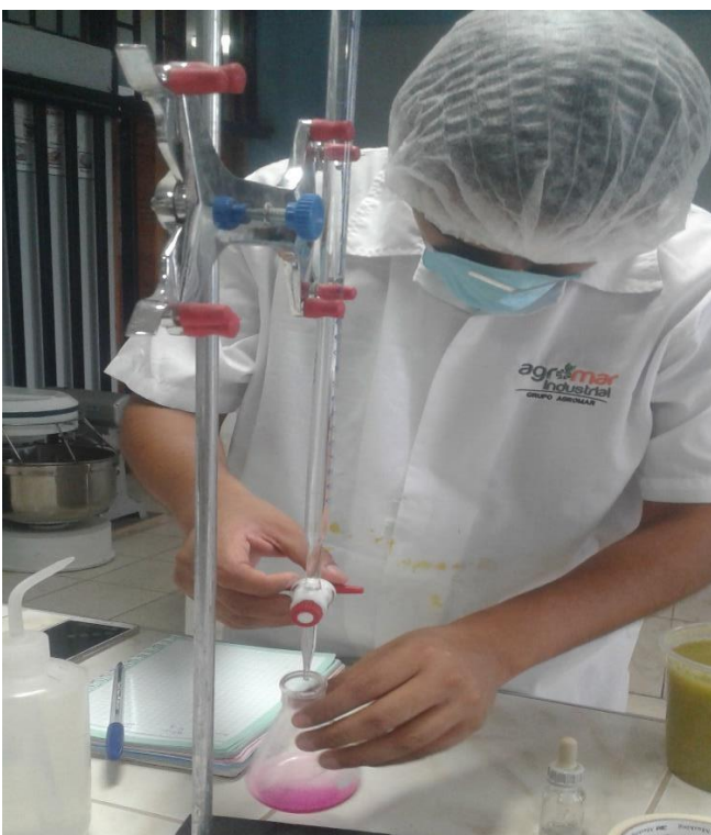
Anexo N° 18: Fotografía de la determinación de la acidez cítrica titulable.
