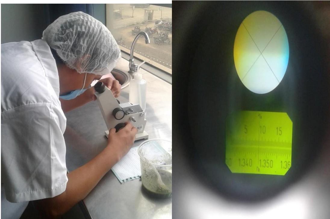
Anexo N° 17: Determinación de los grados Brix mediante refractómetro.
