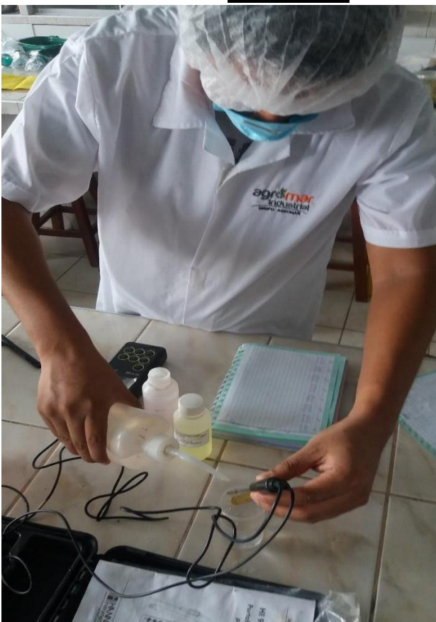
Anexo N° 16: Calibración del pHmetro digital.
