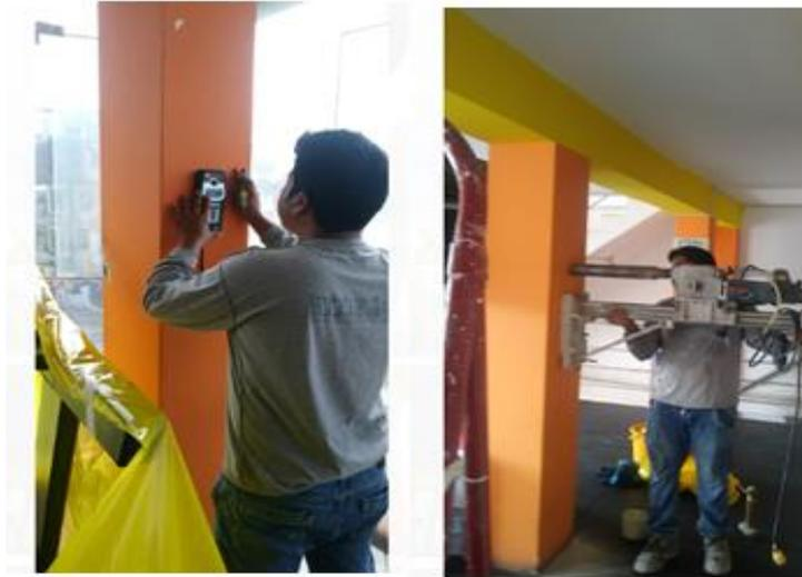
Figura 22. Ubicación de puntos y extracción de muestra de columnas para el ensayo de Diamantina.
