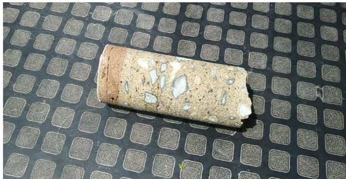
Figura 23. Imagen de una muestra de concreto para el ensayo de Diamantina.
