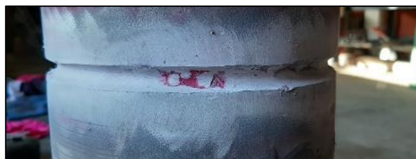
Figura 4. Fallas encontradas en el ensayo de Tintes penetrantes
