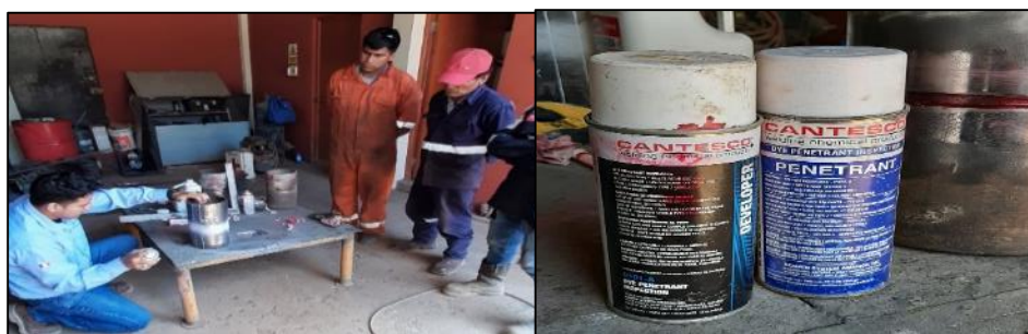
Figura 6. Aplicación del ensayo de Tintes penetrantes.
