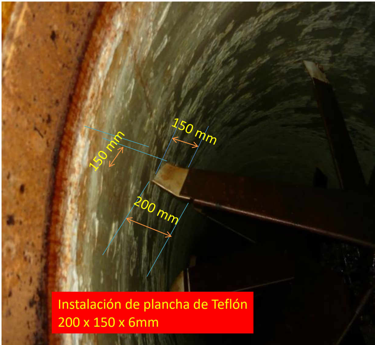
Figura 3. Medidas del teflón instalado en las hélices del agitador.
