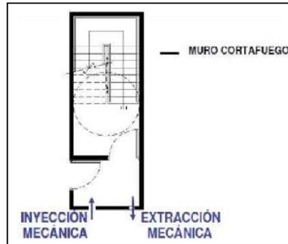
Figura 14 : Vestíbulo con sistema de extracción mecánica.
