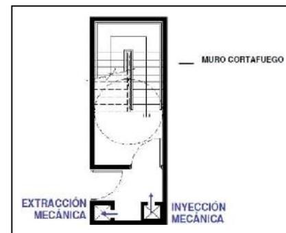
Figura 17 : Vestíbulo con ventilación en un sistema de extracción mecánica a un ducto de ventilación ubicado dentro del vestíbulo.
