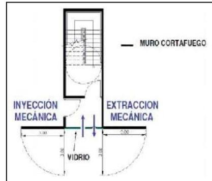
Figura 15 : Vestíbulo con ventilación en un sistema de extracción mecánica.
