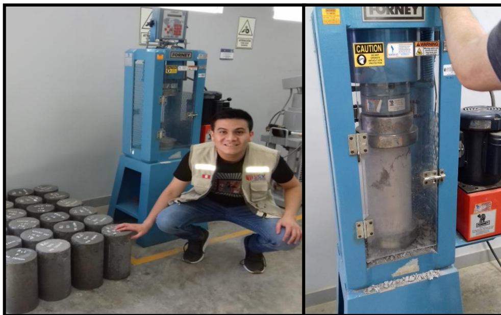
Figura 14. Ensayo de resistencia a la compresión a 28 días de curado
