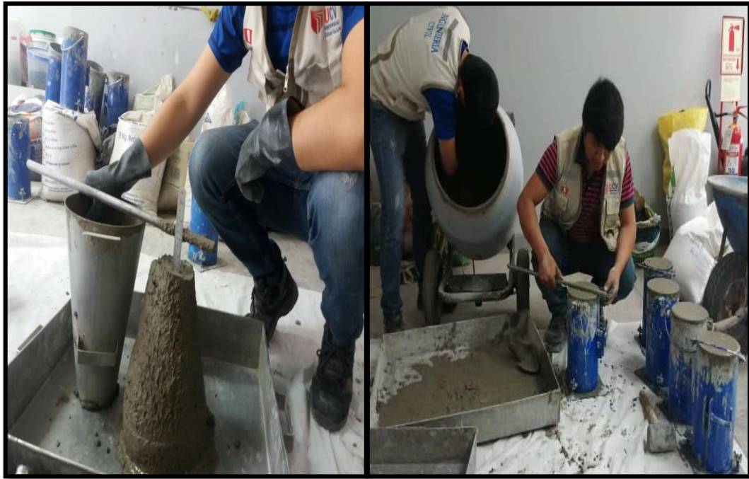
Figura 11. Medida del slump del concreto y elaboración de probetas
