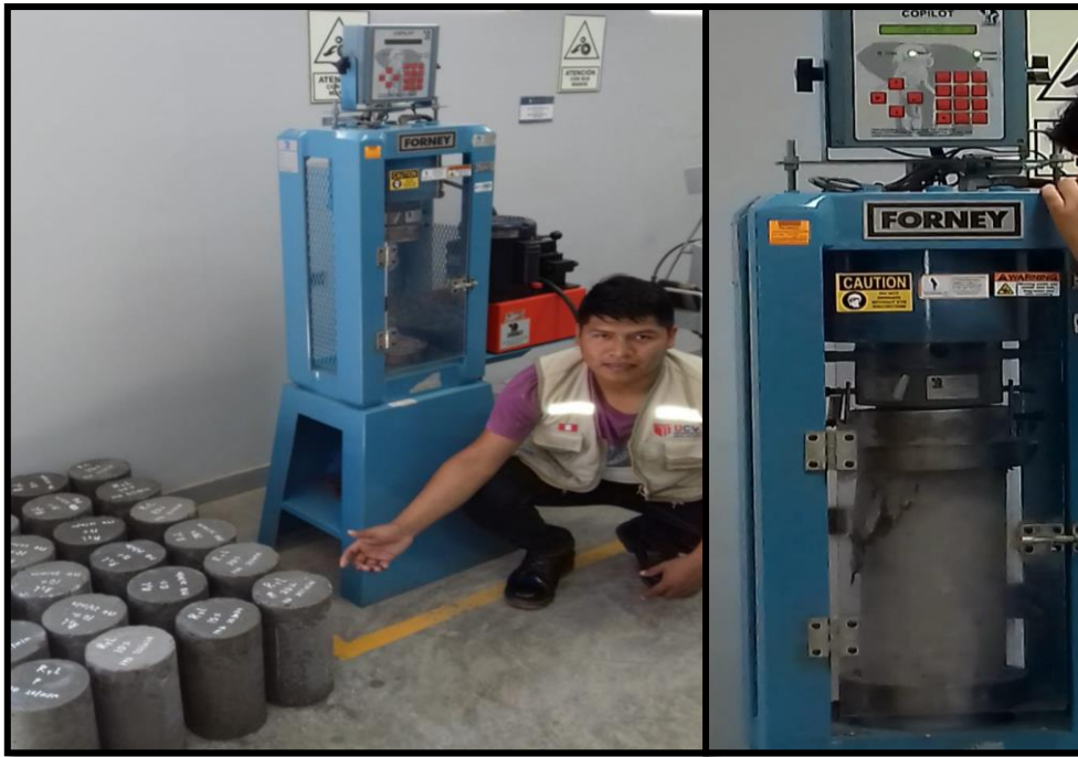
Figura 13. Ensayo de resistencia a la compresión a 14 días de curado
