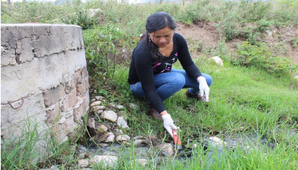
Medición del Potencial de Hidrogeno en la Descarga del Agua Residual
