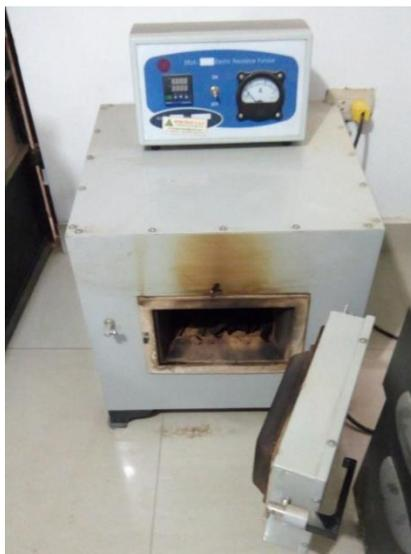
**Figura 12.** Calcinación de la ceniza de Bagazo de la caña de azúcar.
