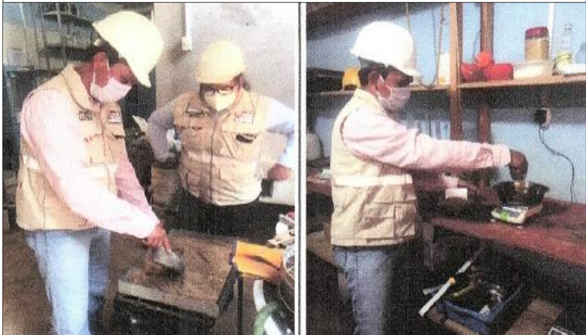
Foto N° 6-7: En las imágenes podemos observar el secado y pesado de los materiales (grava y arena) extraídos de las respectivas canteras.
