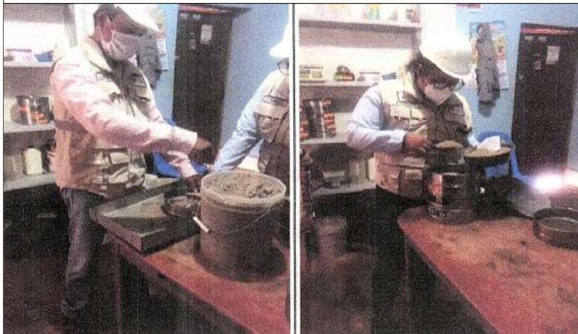
Foto N° 8-9: En las imágenes podemos observar el tamizado de los materiales (grava y arena) extraídos de las respectivas canteras.
