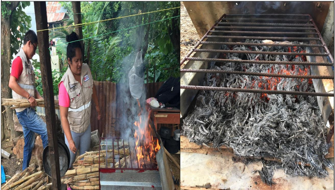
Foto N° 2-3: En las imágenes se puede visualizar que después de la calcinación, se procede a esperar el enfriamiento de la cbca para su tritución.
