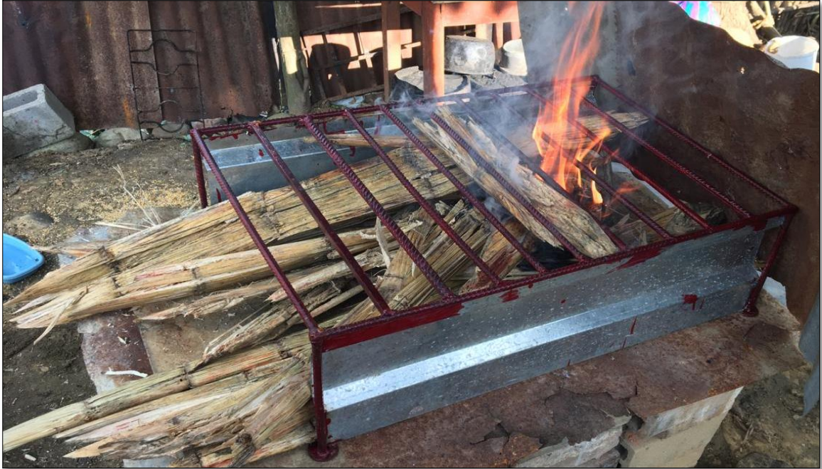
Foto N° 1: En la imagen se puede observar la colocación del bagazo de la caña de azúcar para su calcinación.
